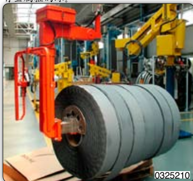
Gripping tooling with pin for handling rolls. 带有栓的抓取工具，用于搬运圆球。
