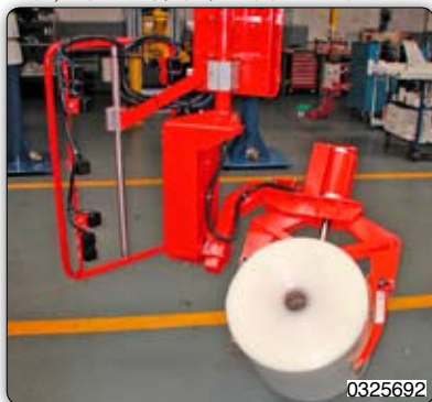
Gripper tooling with pneumatic rotation. 可气动翻转的抓取工具。
