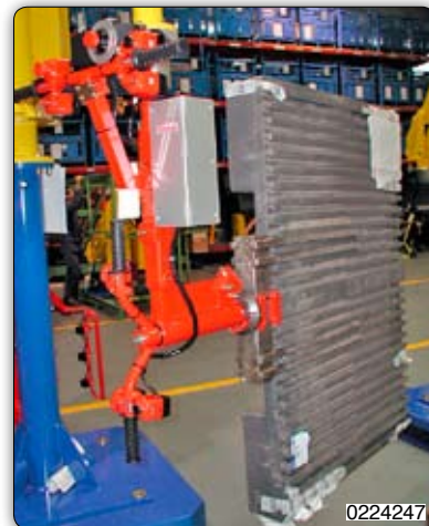
Forks gripping system for particular pallets. 专为特别栈板而设计的叉手抓取系统。
