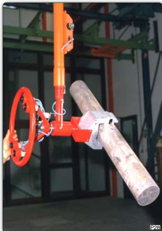
Manipulator with pneumatic gripper for moving metal bars, with 180° manual rotation. Manipulator 装备气动抓手，用于移动金属杠，并可以180度手动旋转。
