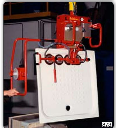
Manipulator with suction cups tooling (Venturi) for gripping shower plates. Manipulator 装备文丘里吸盘, 用于抓取淋浴板。
