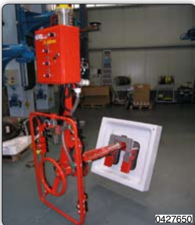
Manipulator with suction cups tooling (Venturi) for gripping shower plates. Manipulator 装备气动工具, 用于搬运淋浴板。
