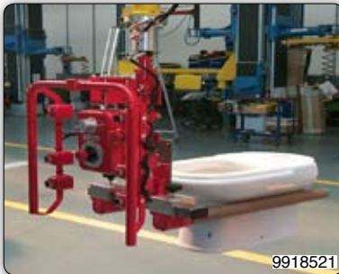
Adjustable suction cups toolings for handling WC. 可调整吸盘, 用于搬运位于用品。
