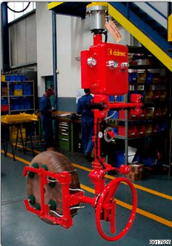
Manipulator with suction cup tooling (Venturi) for gripping and manual rotation of round tanks. 装备真空吸盘（文丘里）的机械手臂，用于抓取和手动翻转圆形油箱。
