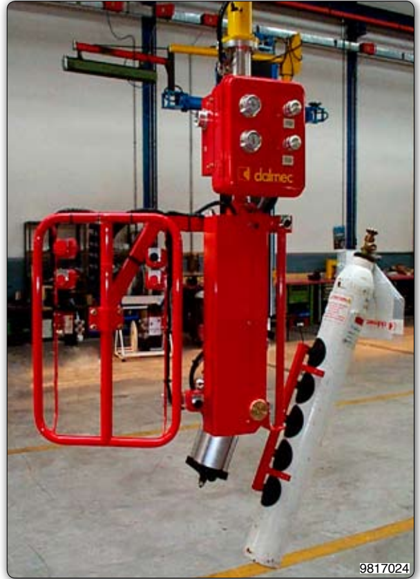
Manipulator with suction cup tooling (Venturi) for gripping and inclination of cylinders. 装备真空吸盘（文丘里）的机械手臂，用于抓取和倾斜气缸。
