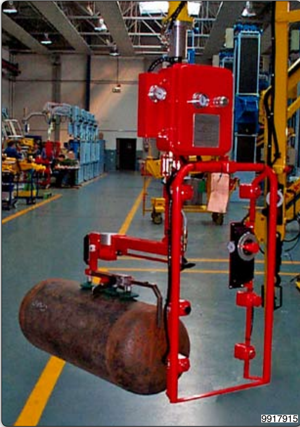
Manipulator with suction cup tooling (Venturi) for gripping and manual rotation of tanks. 装备真空吸盘（文丘里）的机械手臂，用于抓取和手动翻转油箱。
