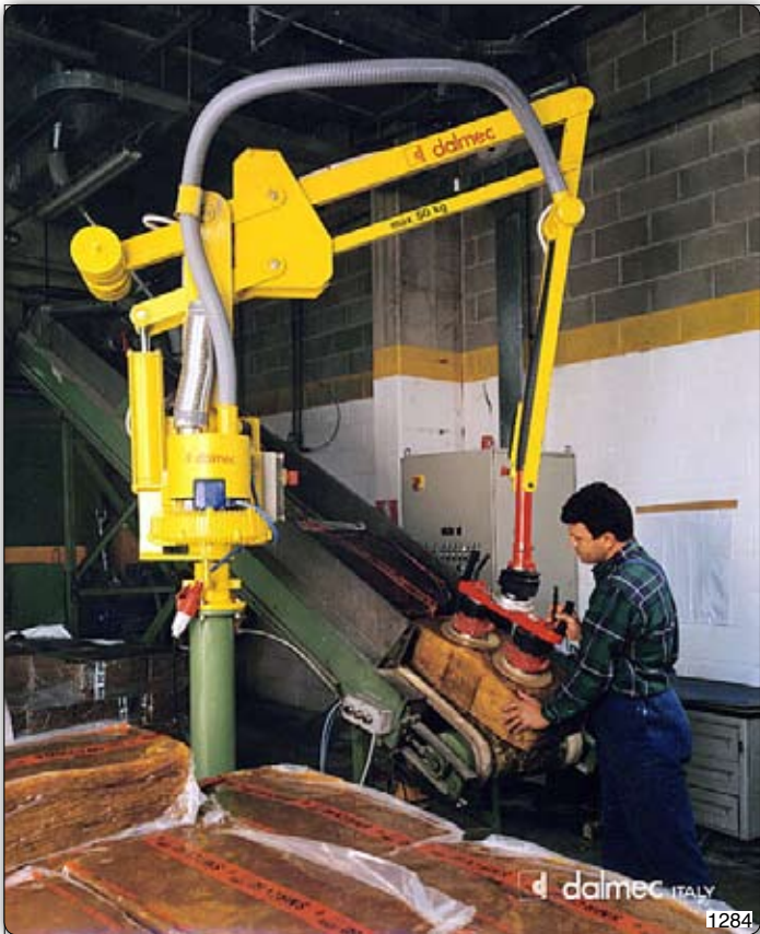
Ruční manipulátor „Partner“, typ PSC, sloupový přístroj s přísavním zařízením ke vkládání kaučukových balíků do drtícího stroje. „Extra zdvih“ umožňuje jednoduché uvolňování vrchního balíku od spodního.
