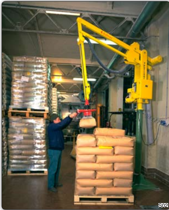
Tento ruční manipulátor „Partner“ typ PSC, sloupový přístroj, umožňuje ukládat pytle na paletu až do výšky 2 m, případně odebírat z palety.
