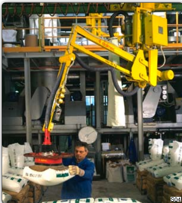
Ruční manipulátor „Partner“ typ PSS, stropní přístroj, pojezdny v kolejnicích Dalmecc. Pytle jsou odebírány z palety v pracovní oblasti „picking“ a ukládány na jinou paletu.
