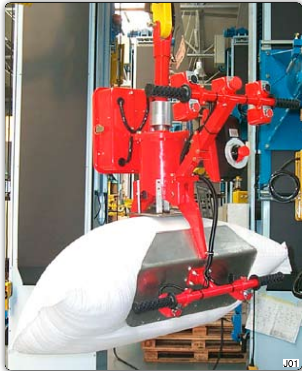
Ruční manipulátor s pneumatickým úchopným zařízením.
