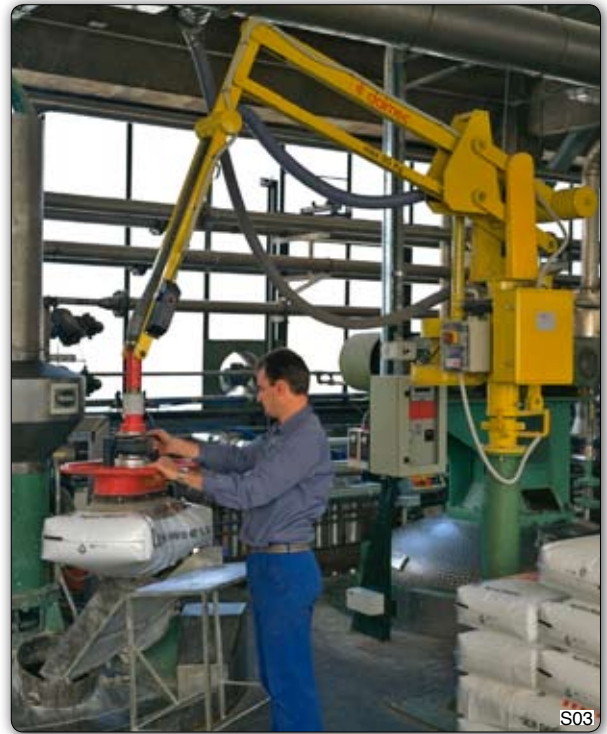
Ruční manipulátor „Partner“ typ PSC, sloupový přístroj s přísavním zařízením k překládání pytlů z palety do míšícího zařízení.
