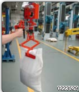
Tento ruční manipulátor „Partner“ typ PSC, sloupový přístroj, umožňuje ukládat pytle na paletu až do výšky 2 m, případně odebírat z palety.
