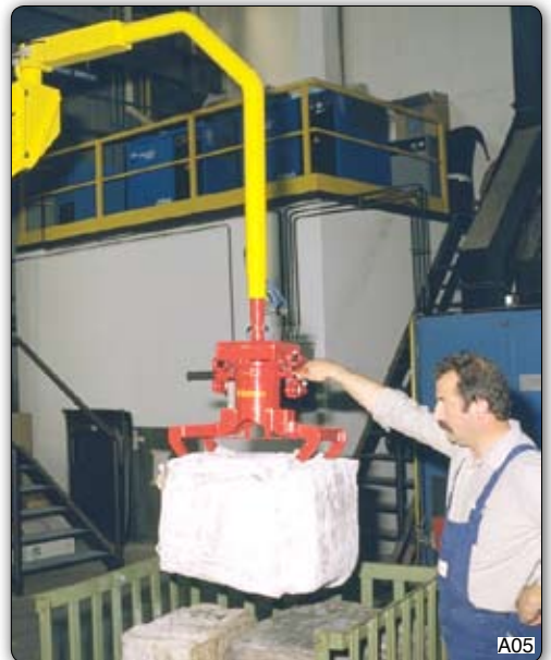
Ruční manipulátor s pneumatickým úchopním zařízením. Uchopení se provádí vniknutím drapáku do kaučukového balíku.
