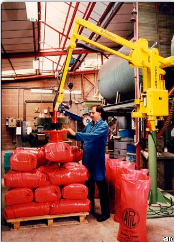
Ruční manipulátor „Partner“, typ PSC, sloupový přístroj k překládání pytlů z plnicího stroje na paletu.
