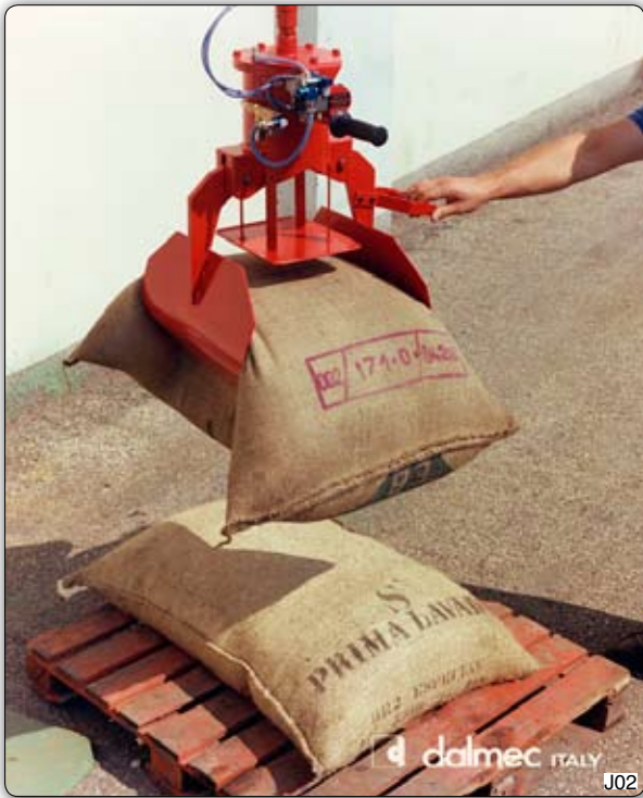
Ruční manipulátor s pneumatickým drapákem pro uchopení pytlů s kávou, kakaem nebo jutových pytlů.
