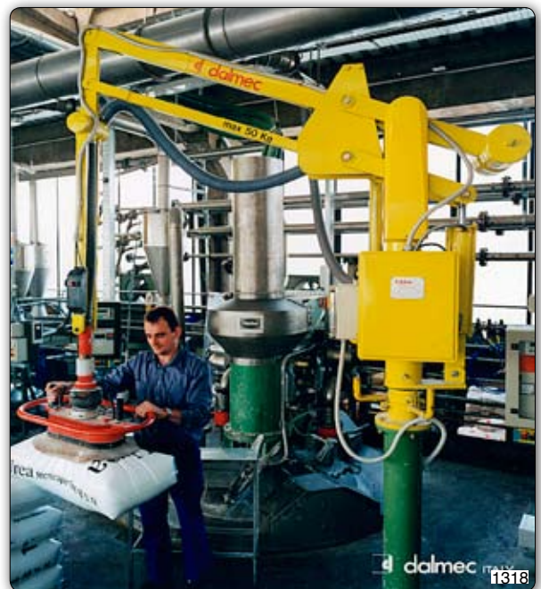
Tímto ručním manipulátorem „Partner“ typ PSC, sloupový přístroj s přísavním zařízením pro uchopení pytlů uložených na paletě a ukládání do míšícího zařízení.
