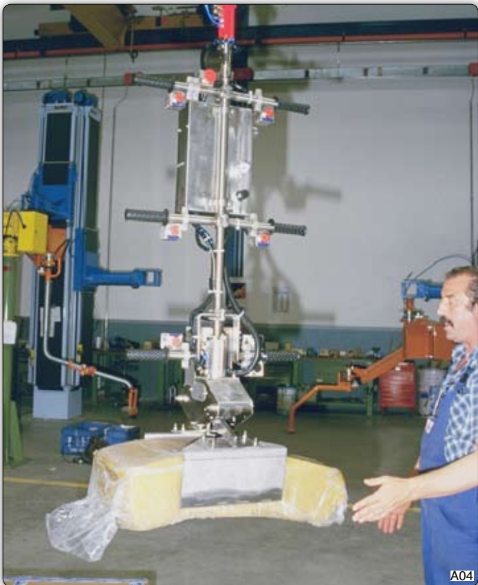
Ruční manipulátor se speciálním drapákem k uchopení kaučukového balíku s obalem.
