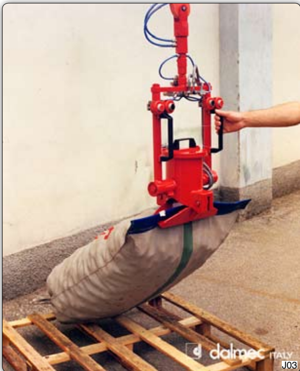
Ruční manipulátor s pneumatickým úchopným zařízením pro naklápění pytlů z horizontálního do vertikálního směru anebo opačně.
