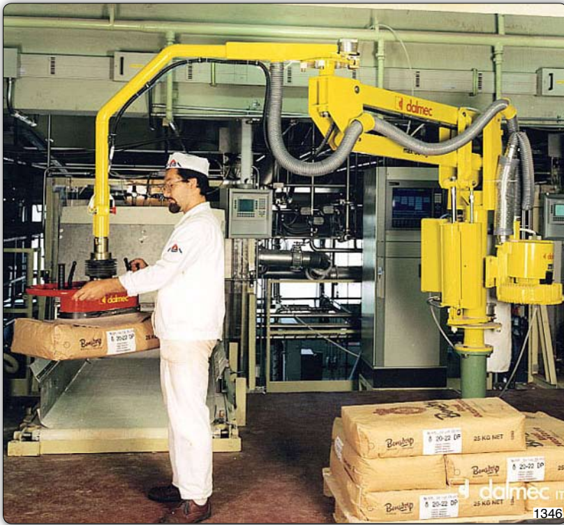
Ruční manipulátor „Partner“ typ PMC, sloupový přístroj. Zkrácená sloupová jednotka zaručuje nasazení ve velmi nízkých prostorech. Pytle jsou překládány z palety na trychtýř.
