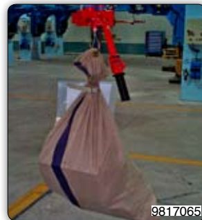
Ruční manipulátor „Partner“ typ PSC, sloupový přístroj s přísavním zařízením k překládání pytlů z palety do míšícího zařízení.
