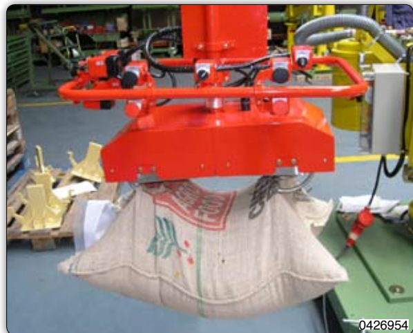
Ruční manipulátor s pneumatickým úchopným zařízením se zatahovacími háky k uchopení jutových pytlů.
