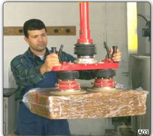
Toto přísavní zařízení pro kaučukové balíky se skládá ze dvou ohybných přísavek.
