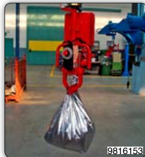
Tento ruční manipulátor „Partner“ typ PSC, sloupový přístroj, umožňuje ukládat pytle na paletu až do výšky 2 m, případně odebírat z palety.
