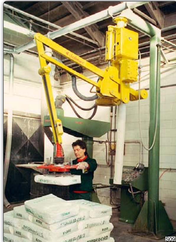
Ruční manipulátor „Partner“ typ PSF, stropní přístroj stacionární k překládání pytlů z plnicího stroje na paletu.
