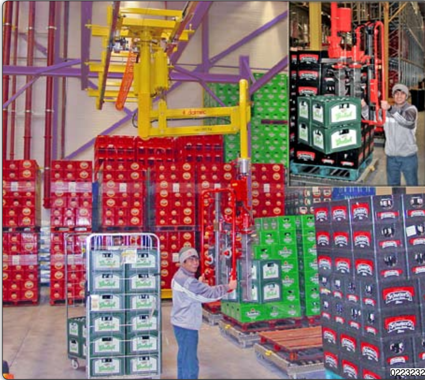
Ruční manipulátor „Partner“ stropní přístroj pojezdový v kolejničích, s pneumatickou motorizací, s různými regulovatelnými háky k manipulaci s 1 až 8 bednami pro nápoje různých velikostí.
