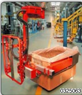
Úchopní zařízení pro manipulaci s přepravkami s potravinami: - Drapák k uchopení a vyprazdňování kartonů s tabákem různých velikostí. - Jednoduché úchopní zařízení s ručním otáčením pro plastové přepravky. - Háky z nerezavějící oceli k manipulaci s plastovými přepravkami. - Úchopní zařízení z nerezavějící oceli k manipulaci s plastovými přepravkami s jablky.
