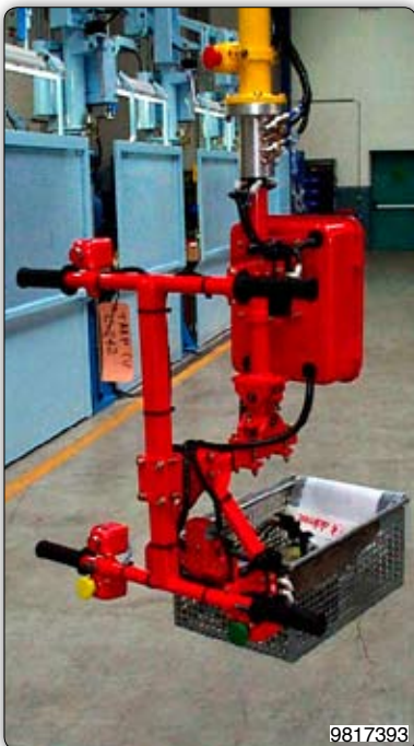
Ruční manipulátor s vidlicovým zařízením pro manipulaci s kovovými přepravkami.
