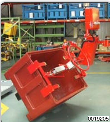
Ruční manipulátor „Partner“ typ PMC, sloupový přístroj s pneumatickým drapákem k uchopení, naklápění a ručnímu otáčení plastových přepravek různých velikostí.
