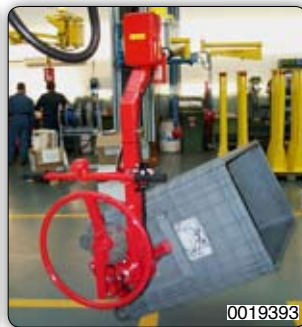
Úchopní zařízení pro manipulaci s přepravkami s potravinami: - Drapák k uchopení a vyprazdňování kartonů s tabákem různých velikostí. - Jednoduché úchopní zařízení s ručním otáčením pro plastové přepravky. - Háky z nerezavějící oceli k manipulaci s plastovými přepravkami. - Úchopní zařízení z nerezavějící oceli k manipulaci s plastovými přepravkami s jablky.
