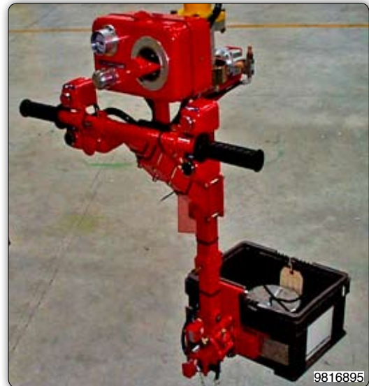
Ruční manipulátor s vidlicovým zařízením pro uchopení přepravek a manipulaci s nimi.
