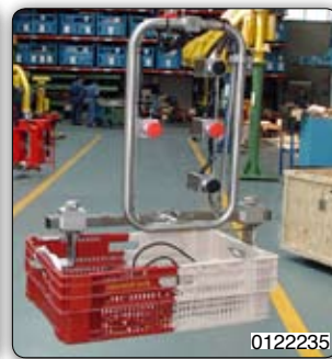
Úchopní zařízení pro manipulaci s přepravkami s potravinami: - Drapák k uchopení a vyprazdňování kartonů s tabákem různých velikostí. - Jednoduché úchopní zařízení s ručním otáčením pro plastové přepravky. - Háky z nerezavějící oceli k manipulaci s plastovými přepravkami. - Úchopní zařízení z nerezavějící oceli k manipulaci s plastovými přepravkami s jablky.
