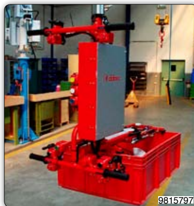
Ruční manipulátor s drapákem k uchopení a manipulaci s plastovými přepravkami různých velikostí.
