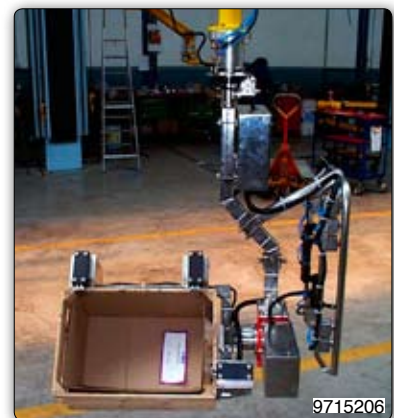
Ruční manipulátor s pneumatickým drapákem z nerezavějící oceli k uchopení a vyprázdňování přepravek.
