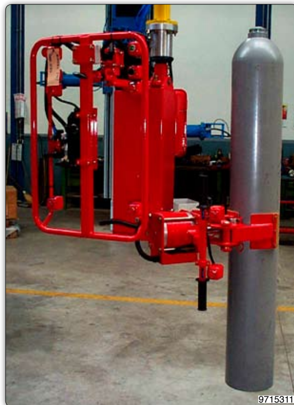
Ruční manipulátor s pneumatickým drapákem k uchopení, pneumatickému naklápění o 90° a ručnímu otáčení o 180° tlakových nádob různých velikostí.
