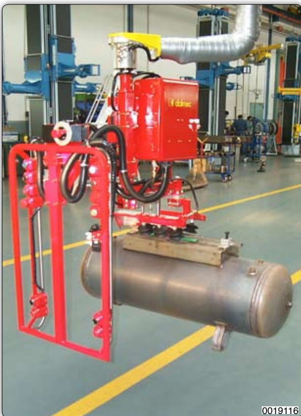
Ruční manipulátor s přísavným zařízením (Venturi) k uchopení tlakových nádob a manipulaci s nimi.
