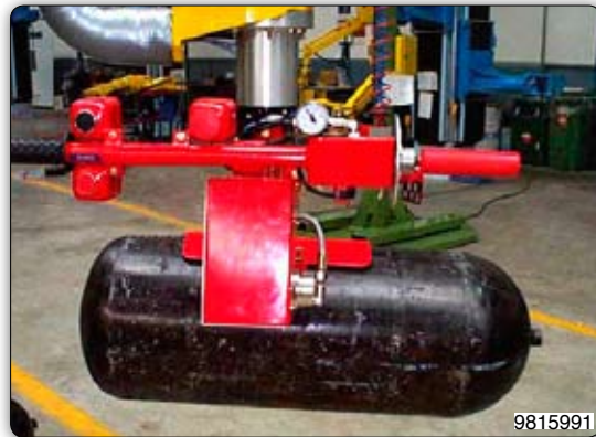
Ruční manipulátor s přísavným zařízením (Venturi) k uchopení a odkládání plynových nádrží GPL do vozidel.
