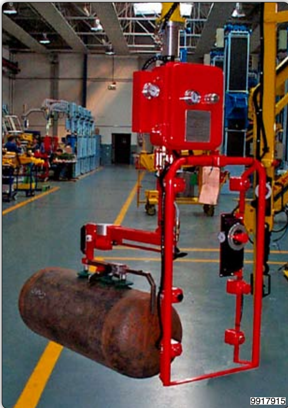
Ruční manipulátor s přísavním zařízením (Venturi) k uchopení a ručnímu otáčení boilerů.
