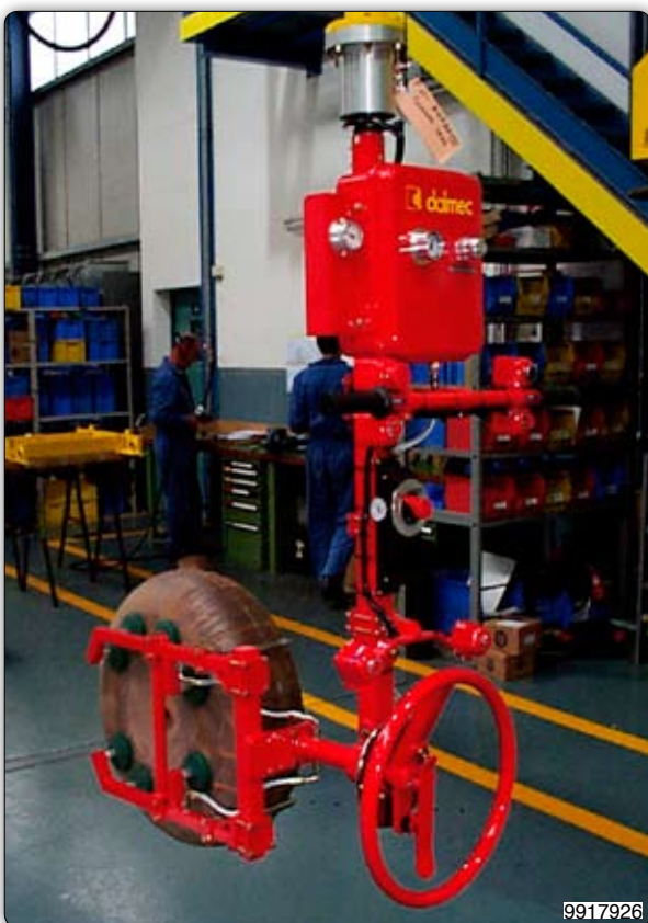
Ruční manipulátor s přísavním zařízením (Venturi) k uchopení a ručnímu otáčení plynových nádrží.
