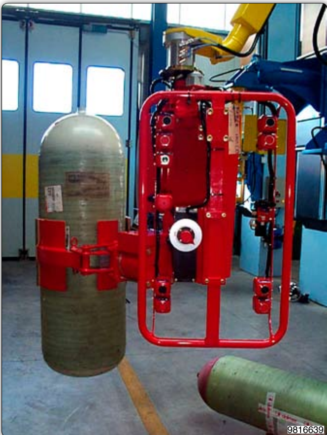
Ruční manipulátor s pneumatickým drapákem k uchopení a pneumatickému nakládání tlakových nádob různých velikostí o 90°.
