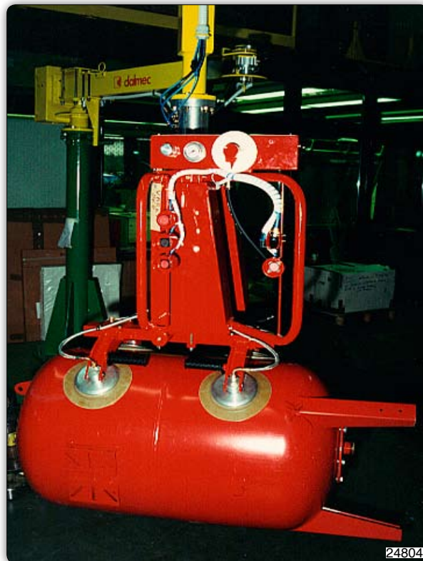
Ruční manipulátor s přísavným zařízením (Venturi) k uchopení a naklápění tlakových nádob.
