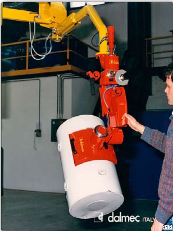
Ruční manipulátor „Partner“ typ PMC, sloupový přístroj s přísavným zařízením (Venturi) k uchopení a ručnímu otáčení bojlerů.
