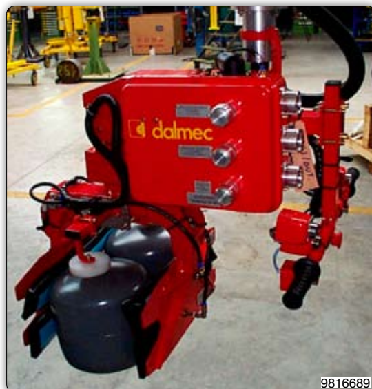
Ruční manipulátor s úchopním zařízením, skládajícím se z nafukovacích prítlačných podušek k uchopení jedné nebo dvou tlakových nádob.
