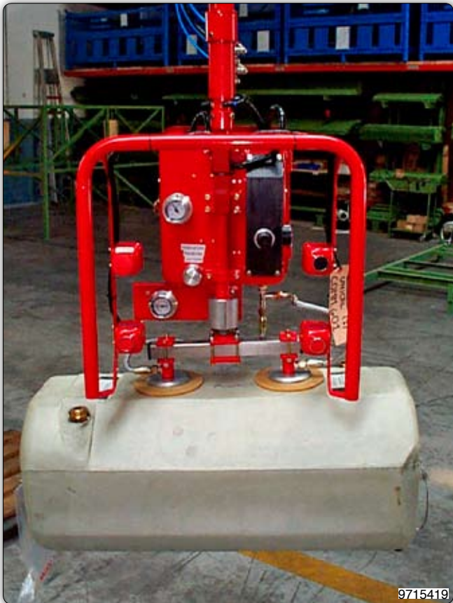
Ruční manipulátor s nastavitelným přísavným zařízením (Venturi) k uchopení nádrží a manipulaci s nimi.
