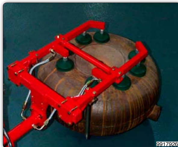
Ruční manipulátor s přísavním zařízením (Venturi) k uchopení a ručnímu otáčení plynových nádrží.
