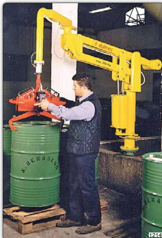
Ruční manipulátor „Partner“ typ PMC, sloupový přístroj k uchopení sudů za vrchní obvod.
