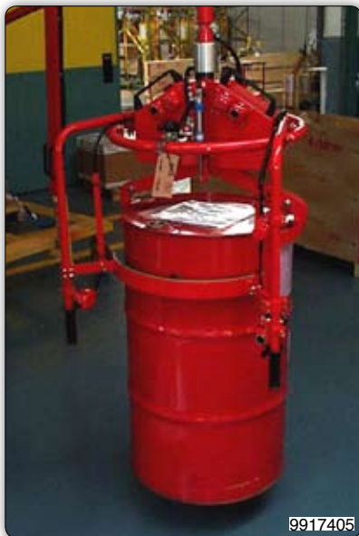
Ruční manipulátor s drapákem pro uchopení sudů za vrchní obvod a po výšce s dvojitými ovládacími prvky.
