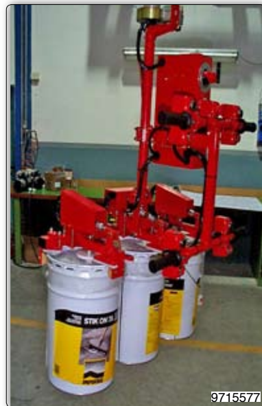
Pneumatické úchopní zařízení pro současnou manipulaci se třemi nádobami.
