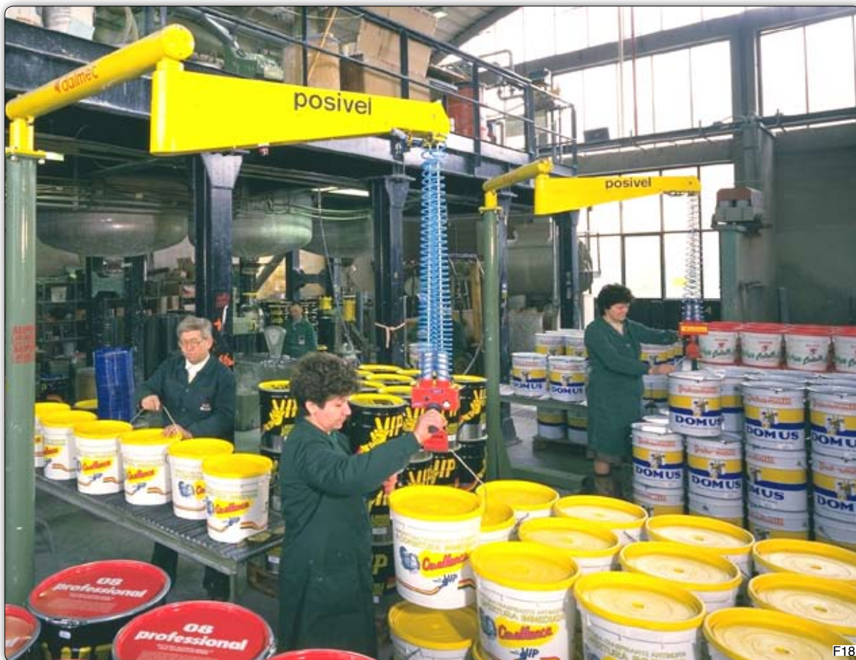
Ruční manipulátor „Posivel“ typ PVC, sloupový přístroj se speciálně tvarovaným hákem k uchopení a pokládání věder na paletu.
