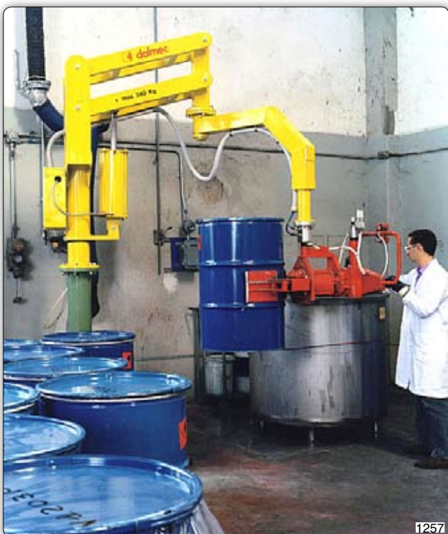
Ruční manipulátor „Partner“ typ PMC, sloupový přístroj k překládání a vyprázdnění sudů.
