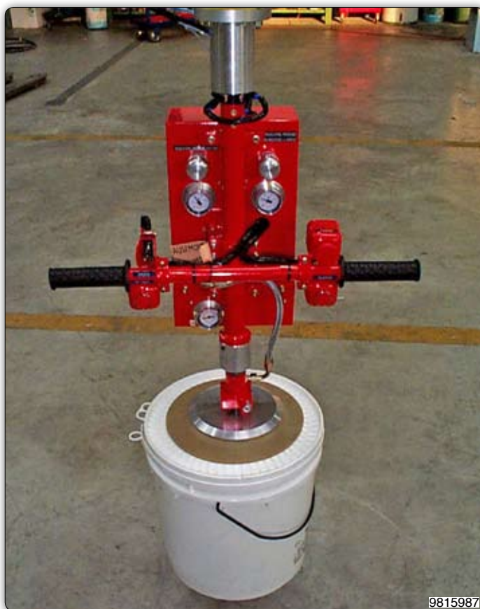
Ruční manipulátor s přísavním zařízením k uchopení sudů. Výroba vakua pomocí ejektoru „Venturi“.
