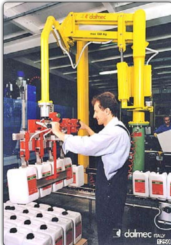
Ruční manipulátor „Partner“ typ PMC, sloupový přístroj s pneumatickým úchopním zařízením pro současnou manipulaci se čtyřmi kanystry.
