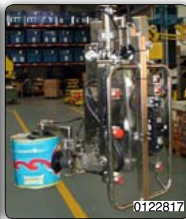
Pneumatické úchopní zařízení pro současnou manipulaci se třemi nádobami.
