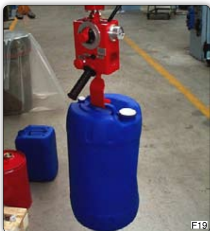
Ruční manipulátor „Posivel“ typ PVC, sloupový přístroj se speciálně tvarovaným hákem k uchopení a pokládání věder na paletu.
