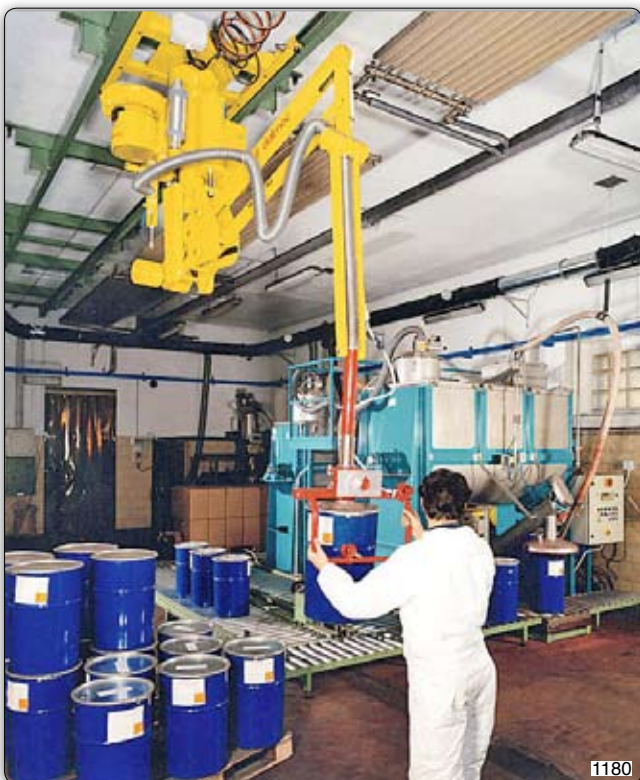
Ruční manipulátor „Partner“ typ PSS, stropní přístroj pojezdový s přísavním zařízením. Vakuum se vyrábí tryskou „Venturi“.
