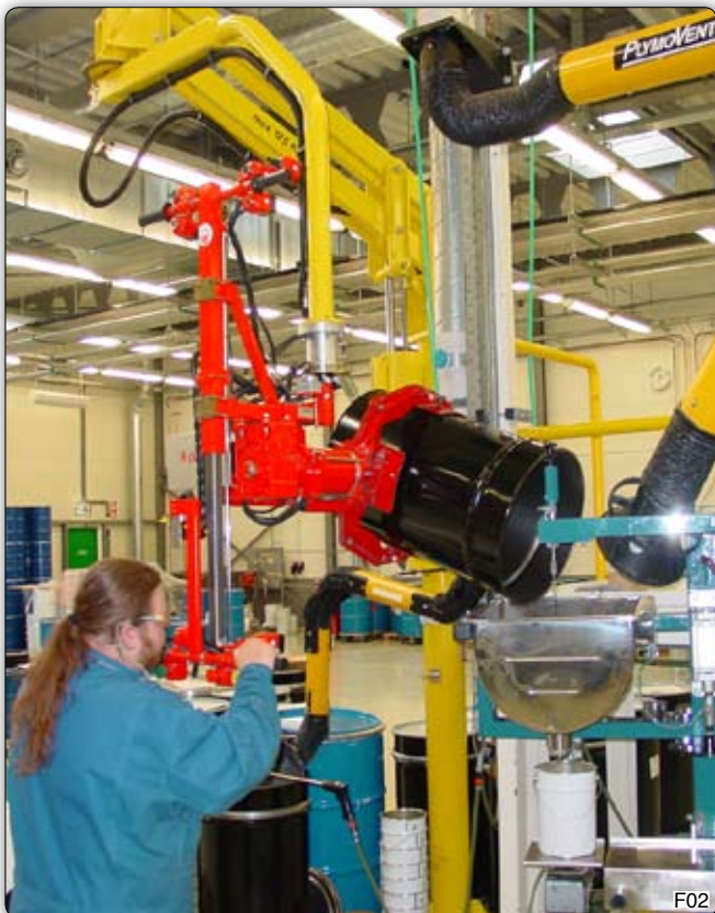
Ruční manipulátor „Partner“ typ PMC, sloupový přístroj k uchopení a vyprázdnění sudů.
