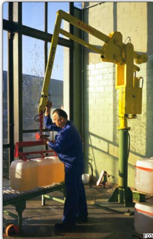
Ruční manipulátor „Partner“ typ PSC, sloupový přístroj. Jeden nebo několik kanystrů jsou současně uchopeny speciálním úchopním zařízením a překládány z dopravního pásu na paletu.
