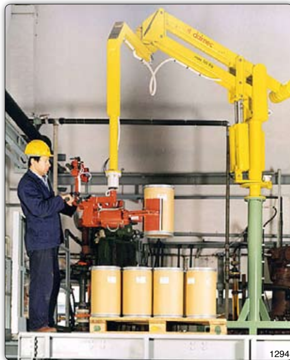
Ruční manipulátor „Partner“ typ PMC, sloupový přístroj k uchopení a vyprazdňování nádob.
