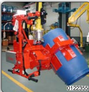
Ruční manipulátor s drapákem pro uchopení sudů za vrchní obvod a po výšce s dvojitými ovládacími prvky.
