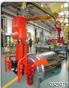
Drapák k uchopení a pneumatickému naklápění pracích bubňů o 90°.
