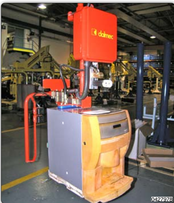
Ruční manipulátor s přisavním zařízením k uchopení nápojových automatů a manipulaci s nimi.
