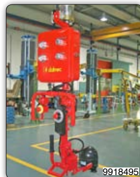
Drapák k uchopení a manipulaci s kompresory chladniček.
