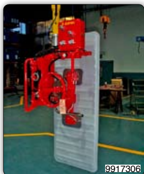
Přísavní zařízení k uchopení výměnných panelů chladicích buněk.
