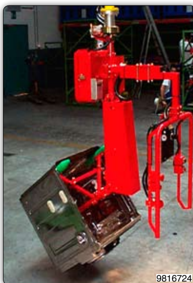
Ruční manipulátor s pneumatickým drapákem k uchopení a naklápění vnitřních ráků pro myčky nádob.
