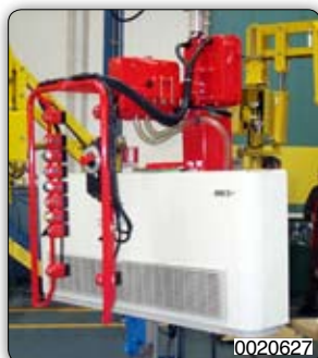
Přisavní zařízení k uchopení a naklápění konvektorů o 90°.
