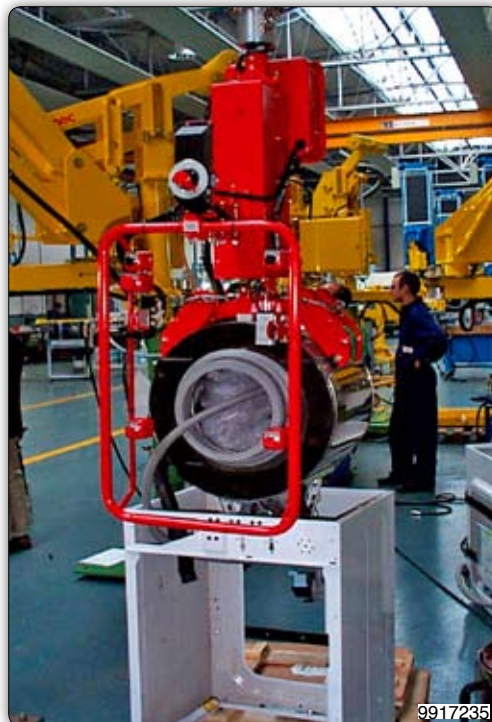
Ruční manipulátor „Partner“ typ PMC, sloupový přístroj s pneumatickým drapákem pro uchopení a vkládání pracích bubňů.
