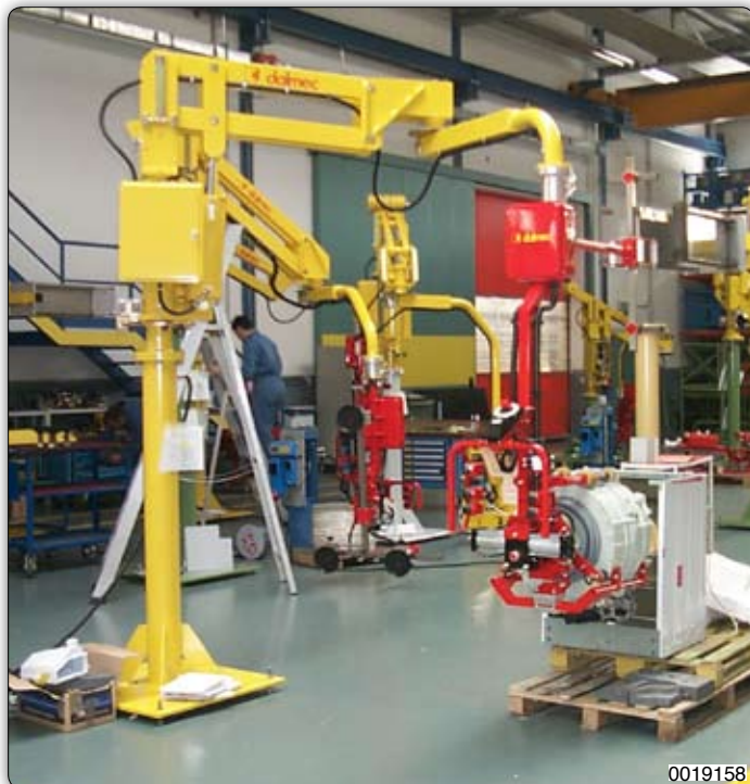
Ruční manipulátor „Partner“ typ PMC, sloupový přístroj s pneumatickým drapákem pro uchopení, otáčení a vkládání pracích bubňů do ráků.
