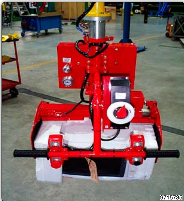
Ruční manipulátor s drapákem k uchopení mikrovlnek a manipulaci s nimi.
