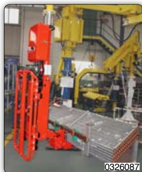
Drapák k uchopení a ručnímu otáčení klimatizačních zařízení o 90°.
