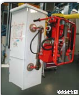
Přisavní zařízení k uchopení a ručnímu otáčení chladniček o 90°.
