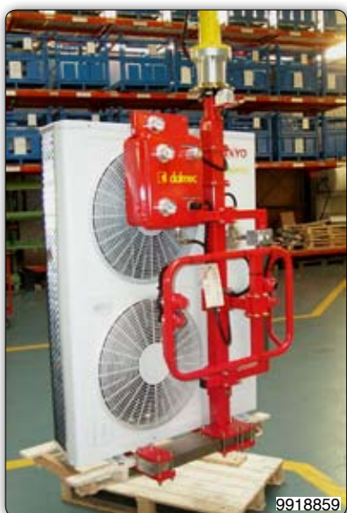
Ruční manipulátor s vidlicovým zařízením k manipulaci s klimatizačními zařízeními na paletách.
