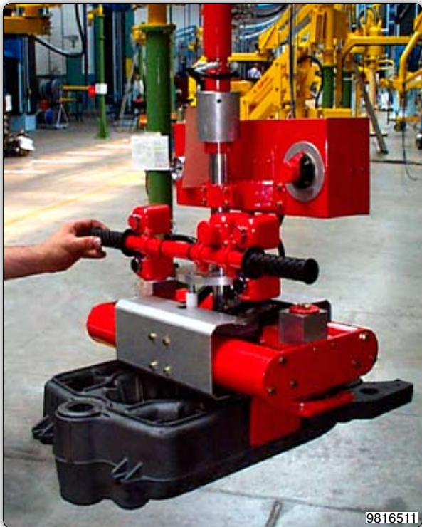
Ruční manipulátor s pneumatickým drapákem pro uchopení a překládání dílů kotle.
