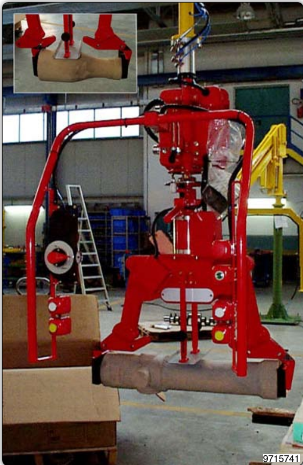
Ruční manipulátor s pneumatickým drapákem pro uchopení jader a manipulaci s nimi.
