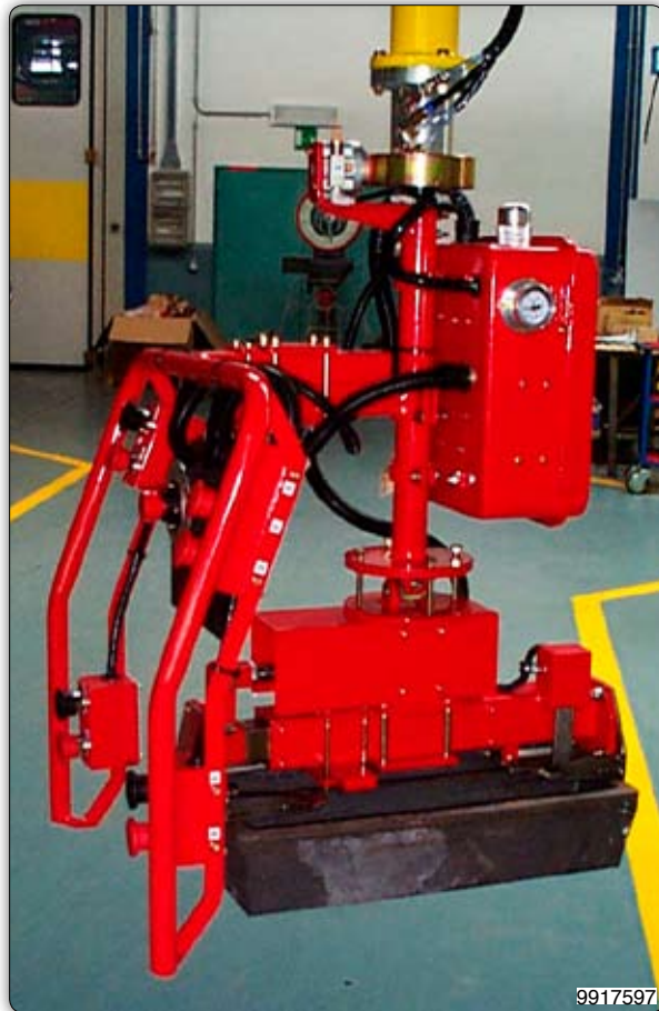
Ruční manipulátor s pneumatickým drapákem pro uchopení licích forem a manipulaci s nimi.
