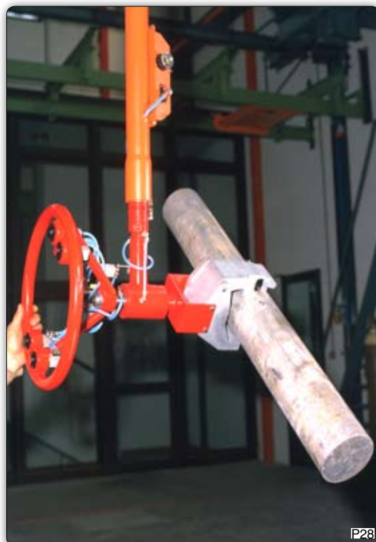
Pneumatické úchopní zařízení k manipulaci s hliníkovými polotovary. Zařízení je možné ručně otáčet o 180°.
