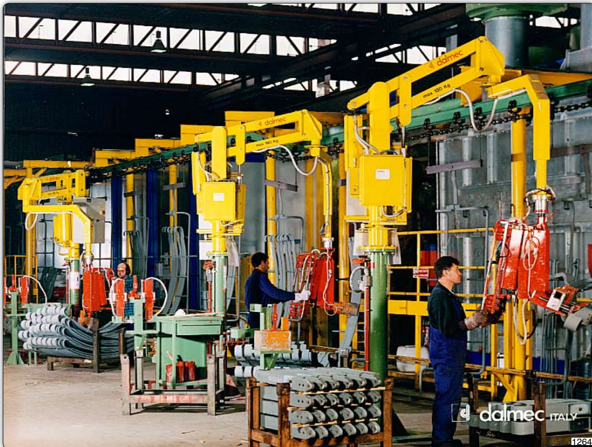
Ruční manipulátory „Partner“ typ PMC, sloupové přístroje pro vkládání do lakovačích zařízení s listovými pružinami. Ruční manipulátory jsou vybaveny dvěma rychle vyměnitelnými úchopními zařízeními: jeden s elektrickým permanentním magnetem, druhý s čelistmi drapačů.
