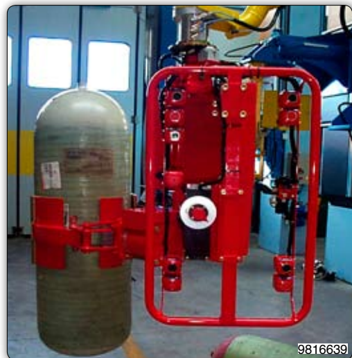
Tímto pneumatickým drapákem je možné uchopit tlakové nádoby a pneumaticky otočit o 90°.
