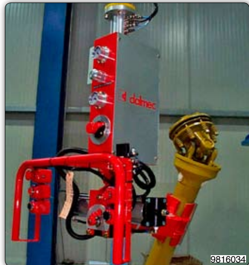
Ruční manipulátor s pneumatickým drapákem k uchopení a otáčení hnacích hřídelů.
