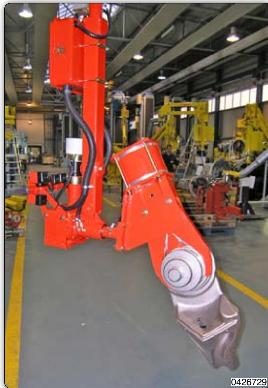
Drapak k uchopení a pneumatickému otáčení frézovaných dílů různých tvarů a vah.
