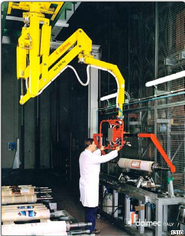
Ruční manipulátor „Partner“ typ PMS, stropní přístroj pojezdový, pro uchopení tiskařských válců. Úchopní zařízení se skládá ze dvou třmenů se speciálně tvarovanými pouzdry. Tiskařské válce jsou uchopeny z palety a odkládány do automatického skladu.
