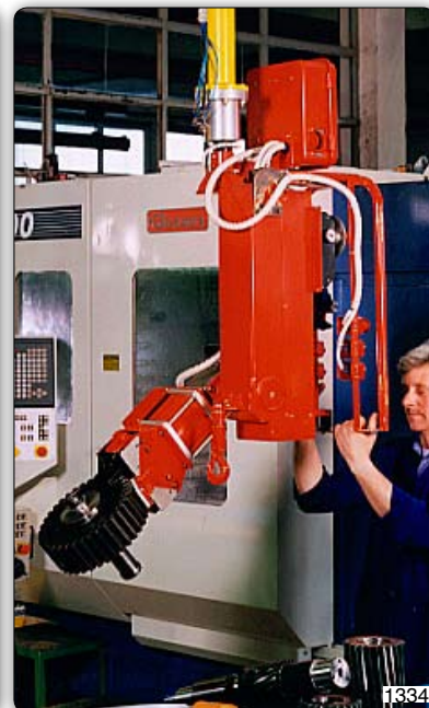
Ruční manipulátor „Partner“ typ PMC, sloupový přístroj se speciálním drapákem k uchopení, naklápění a otáčení ozubených kol.
