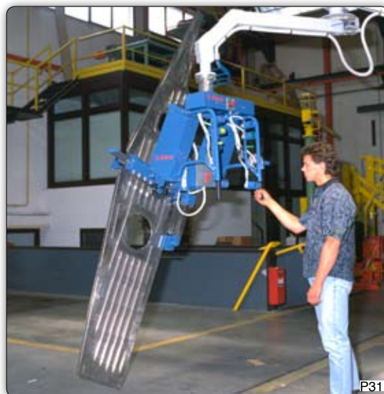
Ruční manipulátor s drapákem k uchopení křídel letadla. Produkty jsou nakládány o 90° a pneumaticky otáčeny o 180°.
