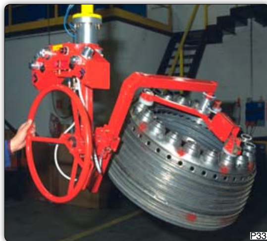
Úchopní zařízení k manipulaci s kruhovými sběrači spalín leteckých motorů slouží ke vkládání do svářecího zařízení. Ruční nakládání sběračů se provádí speciálním volantem.
