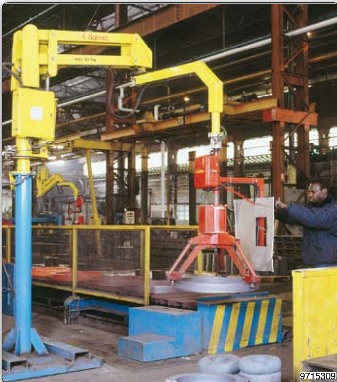
Ruční manipulátor „Partner“ typ PMC, sloupový přístroj s pneumatickým úchopním zařízením. Keramické díly potrubí jsou uchopeny a vkládány do vertikálního obráběcího stroje.
