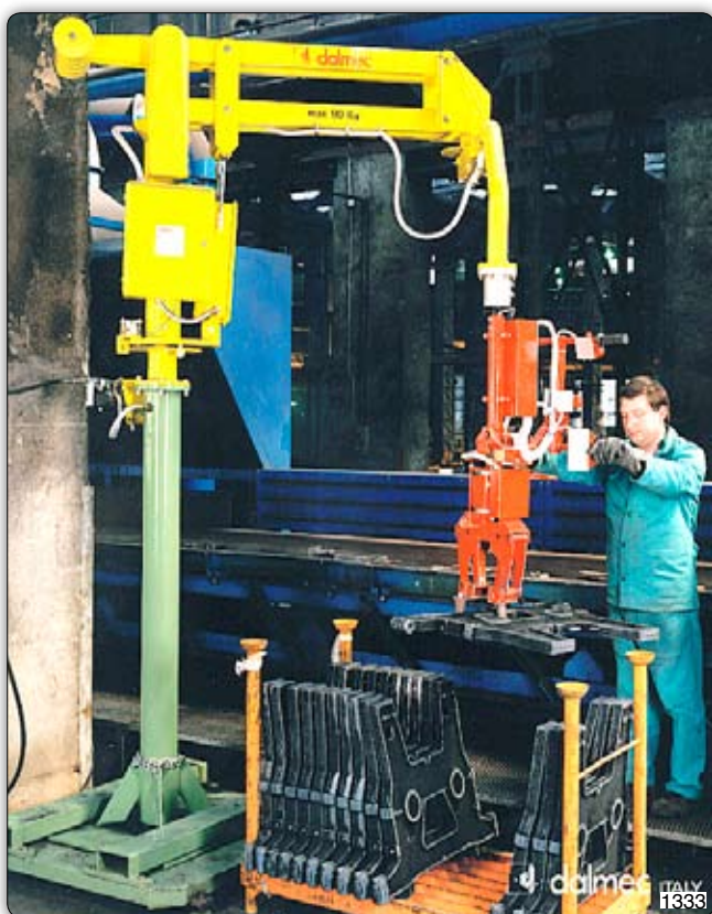
Ruční manipulátor „Partner“, typ PMC, sloupový přístroj se speciálním drapákem k uchopení odlitků z dopravního pásu.
