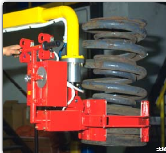
Ruční manipulátor s drapákem k uchopení pérování železničního vagonu a odkládání do kontrolního stroje.
