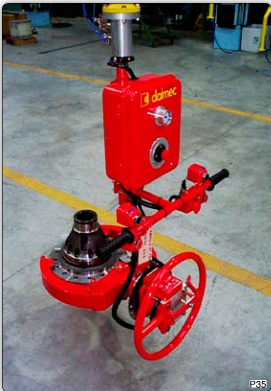
Ruční manipulátor s drapákem k uchopení a ručním otáčení hlav kol o 180°.
