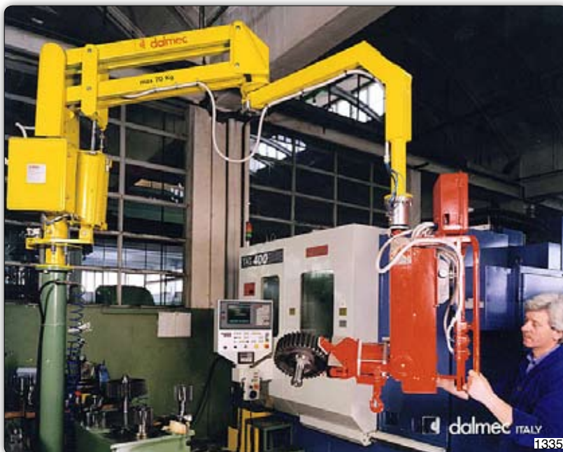
Ruční manipulátor „Partner“ typ PMC, sloupový přístroj se speciálním drapákem k uchopení, naklápění a otáčení ozubených kol.
