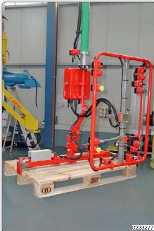
Ruční manipulátor s drapákem k uchopení a manipulaci s paletami.
