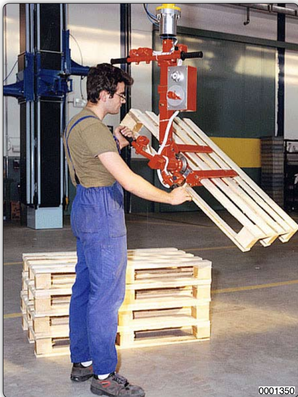
Ruční manipulátor s vidlicovým zařízením s ručním otáčením palet o 180°.
