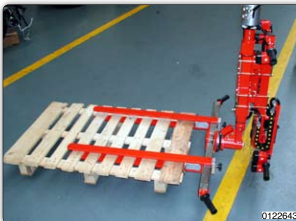
Vidlicové zařízení s teleskopickými ovládacími prvky k manipulaci s paletami.
