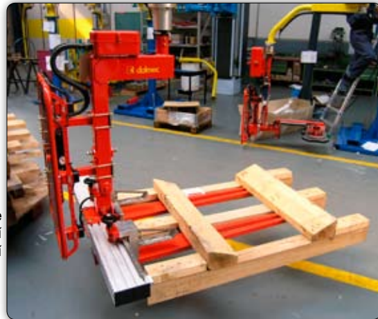
Nastavitelné vidlicové zařízení pneumatickým otáčením břemene a teleskopickými ovládacími prvky.
