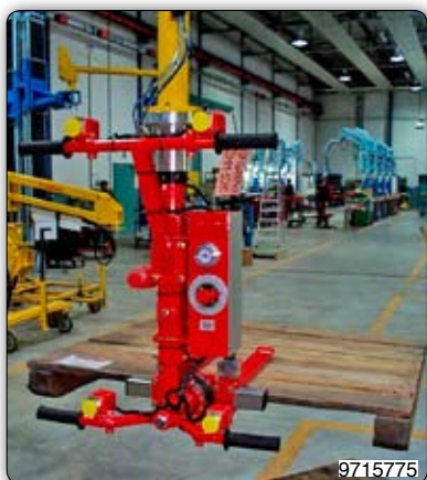
Vidlicové zařízení s ručním otáčením břemene.
