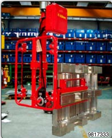
Speciální vidlicové zařízení pro uchopení palet z nerezavějící ocele a manipulaci s nimi.
