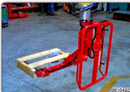
Ruční manipulátor s vidlicovým zařízením a senzorem pro rozlišení produktu k manipulaci s paletami.
