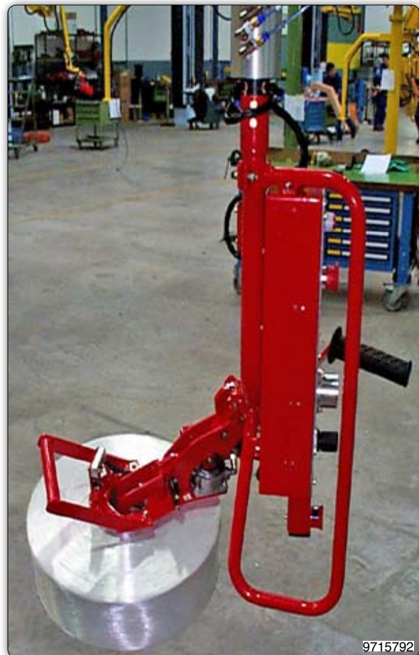
Ruční manipulátor s pneumatickým rozpínacím trnem pro cívky s vlákny. Cívky se uchopují na vnitřním obvodu a ručně otáčejí z horizontálního do vertikálního směru a opačně.
