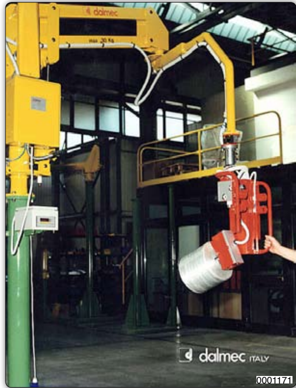
Ruční manipulátor "Partner" typ PMC, sloupový přístroj s pneumatickým rozpínacím trnem k uchopení a pneumatickému naklápění cívek o 90°. Manipulátor je vybaven jednotkou na kontrolu váhy cívky při uchopení.
