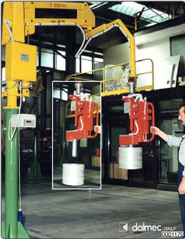
Ruční manipulátor "Partner" typ PMC, sloupový přístroj s pneumatickým rozpínacím trnem k uchopení a pneumatickému naklápění cívek o 90°. Manipulátor je vybaven jednotkou na kontrolu váhy cívky při uchopení.
