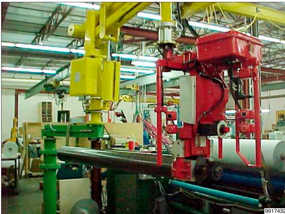
Handhabungs-Manipulator "Partner" Typ PRC, mit Schwenksäule, mit Greifvorrichtung zur Aufnahme und Handhabung von Spulenträgerwellen.
