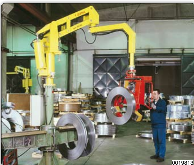
Ruční manipulátor „Partner“ typ PMC, sloupový přístroj s magnetickým zařízením k uchopení ocelových pásových rolí a nakládáním o 90°.
