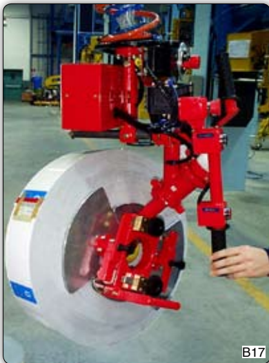
Ruční manipulátor s přísavním zařízením „Venturi“ na uchopení a ruční naklápění cívek z horizontálního do vertikálního směru.
