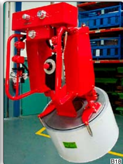
Ruční manipulátor s prstencovým přísavním zařízením „Venturi“ na uchopení a pneumatické naklápění cívek o 90°.
