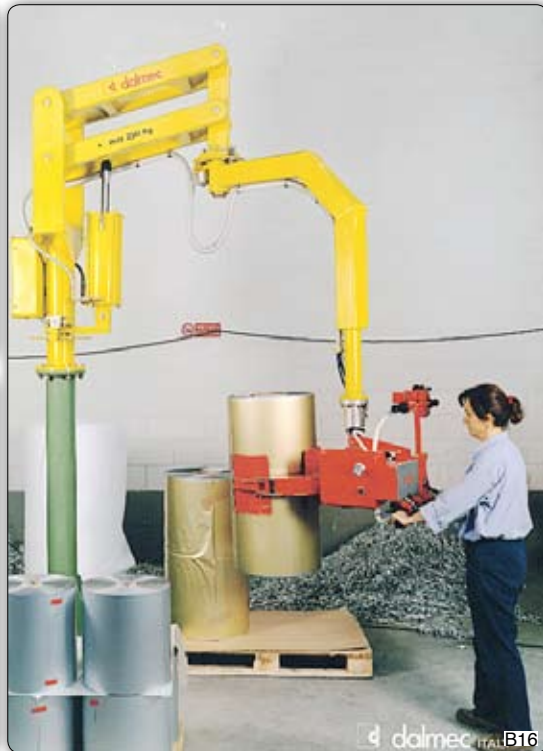
Ruční manipulátor „Partner“ typ PMC, sloupový přístroj s drapákem na uchopení cívek na vnějším průměru a pneumatickým otáčením o \pm 90^\circ .
