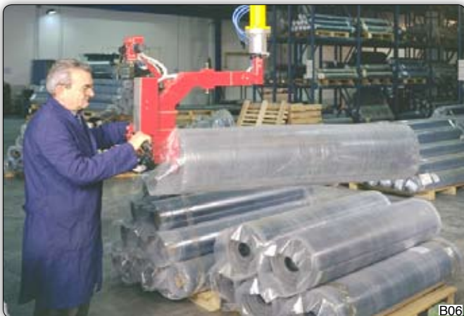
Ruční manipulátor na uchopení a přemístění kaučukových rolí z dopravního pásu a paletu. Úchopní zařízení tvoří trn na vnitřní uchopení role.
