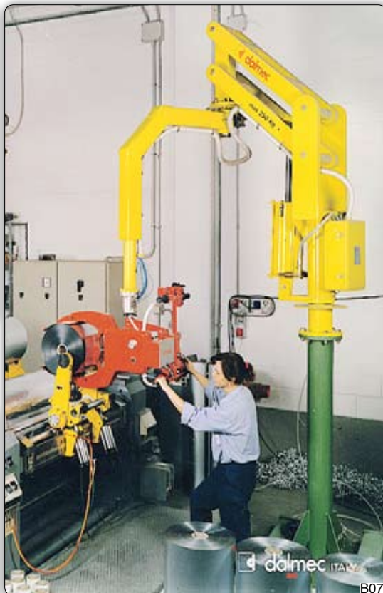
Ruční manipulátor „Partner Typ PMC, sloupový přístroj na odnímání fólií z plastické hmoty z trnu ořezávacího stroje. Role jsou pneumaticky nakládány o 90° z horizontální do vertikální polohy a odkládány na paletu.
