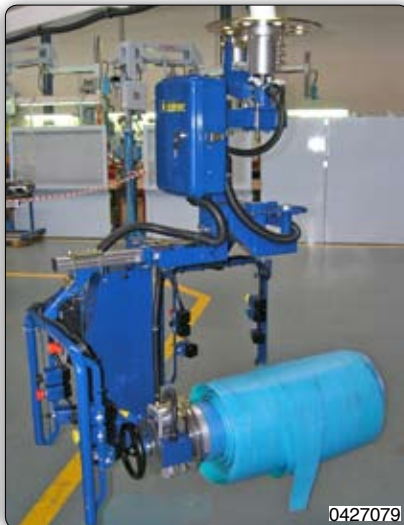
Ruční manipulátor s rozpínacím trnem k uchopení, naklápění a ručnímu otáčení cívek.
