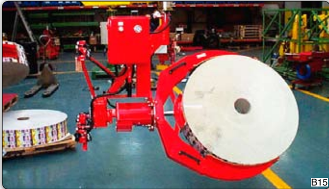
Ruční manipulátor s drapákem na uchopení cívek na vnějším průměru a pneumatickým otáčením o 360°.
