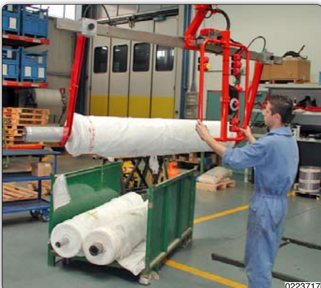
Ruční manipulátor s nastavitelným vidlicovým zařízením k manipulaci s cívkami.
