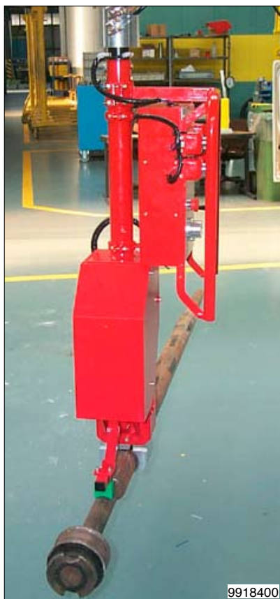
Handhabungs-Manipulator mit Greifvorrichtung für die Aufnahme und Handhabung von Spulenträgerwellen.
