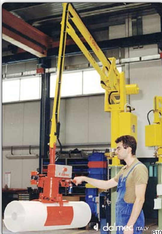
Ruční manipulátor „Partner“ typ PSC, sloupový přístroj se zařízením pro uchopení rolí na vnějším průměru.
