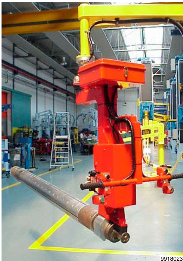
Handhabungs-Manipulator mit Greifvorrichtung für die Handhabung von Spulenträgerwellen.
