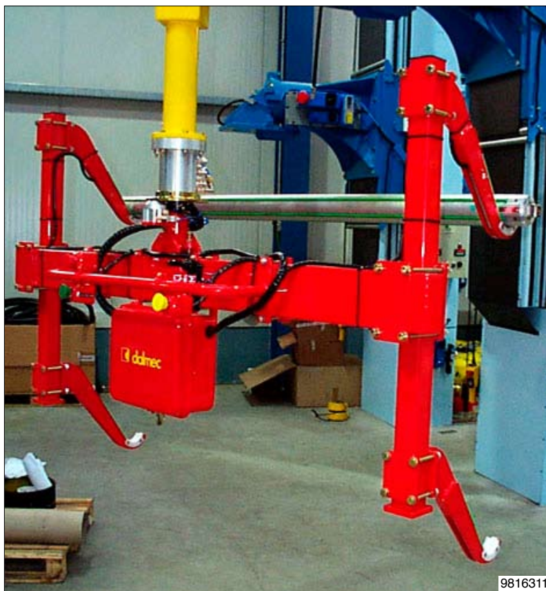
Handhabungs-Manipulator mit Doppelgabelvorrichtung zur Handhabung von Spulenträgerwellen.
