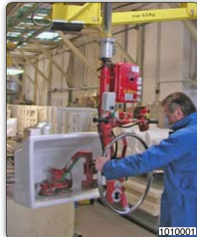
Ruční manipulátor s přísavním zařízením k uchopení a otáčení dřezů.
