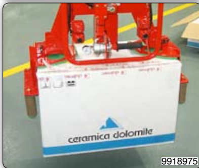
Ruční manipulátor s drapákem pro uchopení sanitárních zařízení, pro uložení do kartonů, jakož i uchopení kartonů a jejich ukládání na paletu.
