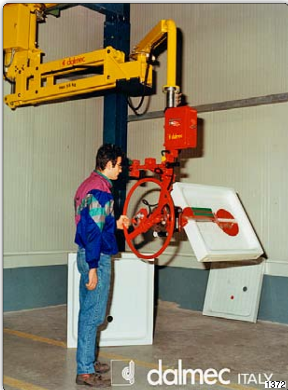
Ruční manipulátor „Partner“ typ PMF, stropní přístroj, s přísavním zařízením (Venturi) k uchopení a ručnímu otáčení sprchových van. 1372
