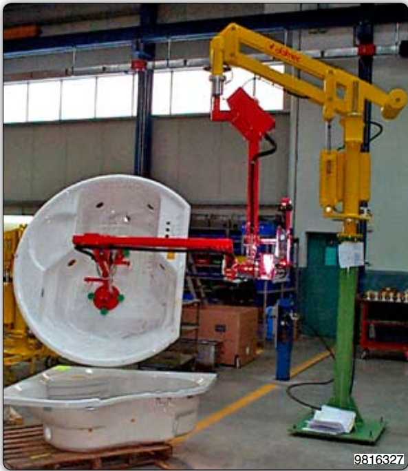
Ruční manipulátor s přísavním zařízením (Venturi) k uchycení a naklápění van.
