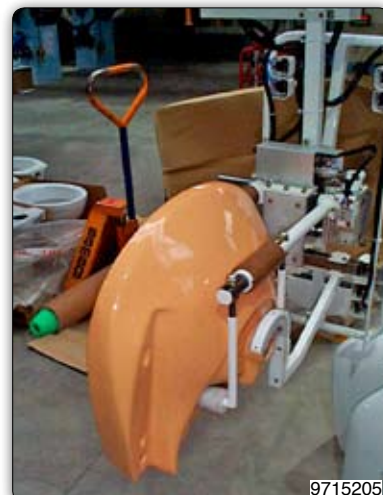
Ruční manipulátor s nastavitelným vidlicovým zařízením k uchopení umyvadel a manipulaci s nimi.
