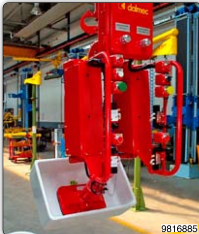
Ruční manipulátor s přísavním zařízením k uchopení a naklápění dřezů.
