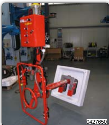
Ruční manipulátor s přísavním zařízením (Venturi) k uchopení sprchových van. 0427650
