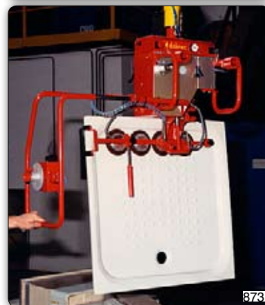
Ruční manipulátor s přísavním zařízením (Venturi) k uchopení sprchových van. 873
