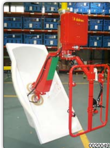
Ruční manipulátor s přísavním zařízením (Venturi) k uchopení a naklápění van.
