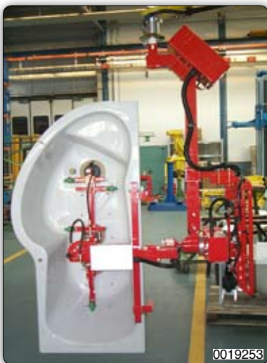
Ruční manipulátor s přísavním zařízením (Venturi) k uchopení a otáčení van.
