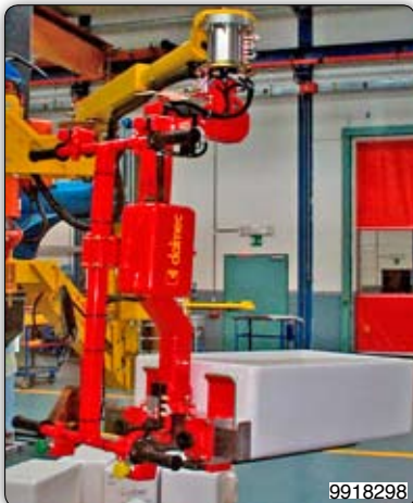
Ruční manipulátor s nastavitelným vidlicovým zařízením k manipulaci s dřezy.
