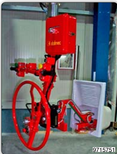
Ruční manipulátor s přísavním zařízením (Venturi) k uchopení a ručnímu otáčení umyvadel.
