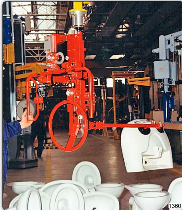
Ruční manipulátor s nastavitelným přísavním zařízením k uchopení a ručnímu otáčení sanitárních zařízení.
