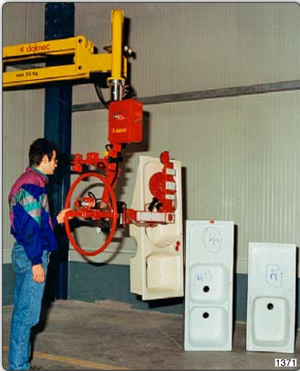
Ruční manipulátor „Partner“ typ PMF, stropní přístroj s vyměnitelným přísavním zařízením k uchopení umyvadel různých velikostí a manipulaci s nimi.
