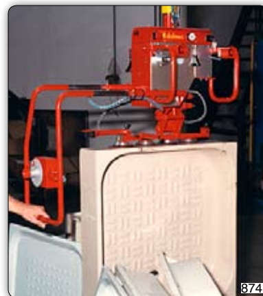
Ruční manipulátor „Partner“ typ PMF, stropní přístroj, s přísavním zařízením (Venturi) k uchopení a ručnímu otáčení sprchových van. 0222958
