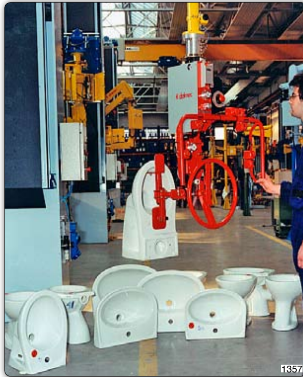
Ruční manipulátor s přísavním zařízením k uchopení a ručnímu otáčení WC.
