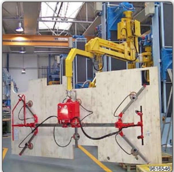
Ruční manipulátor „Partner“ typ PMF, stropní přístroj stacionární s přísavním zařízením k manipulaci a pneumatickému nakládění plochých podlah obytných přívěsů o 90°. Přísavky jsou ručně nastavitelné. Vakuum se vyrábí pomocí trysky „Venturi“.
