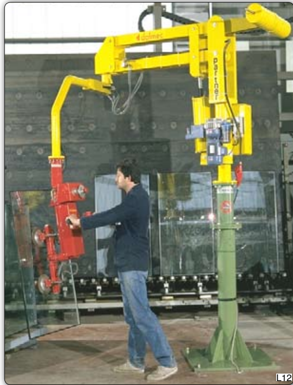
Tímto ručním manipulátorem „Partner“ typ PMC, sloupovým přístrojem s přísavním zařízením se vyjmají skleněné tabule z dopravníku a odkládají na dopravní vozík. Vakuum se vyrábí pomocí elektrické pumpy.
