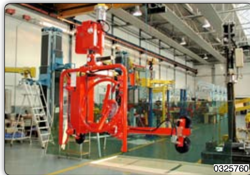
Přísavní zařízení k manipulaci, ručnímu otáčení skleněných tabul o 360° a pneumatickému naklápění o 90°.
