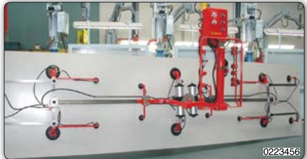
Ruční manipulátor „Partner“ typ PMS, stropní přístroj pojezdový s pneumatickou hnací jednotkou, s nastavitelnou přísavkou k manipulaci a nakládění velkých platin.
