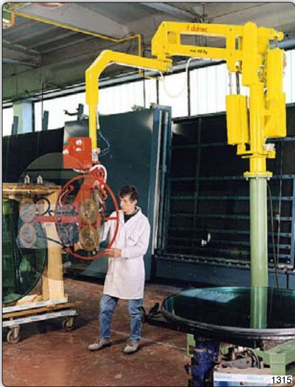
Ruční manipulátor „Partner“ typ PMC, sloupový přístroj s přísavkou k uchopení skleněných tabul uložených na vozíku a jejich odložení na obráběcí stůl. Produkty jsou pneumaticky naklápěny o 90° a ručně otáčeny o 360°.
