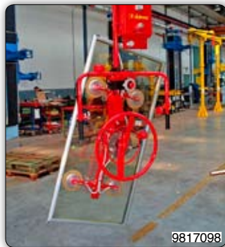
Přísavní zařízení k manipulaci a pneumatickému naklápění skleněných tabul o 360°.
