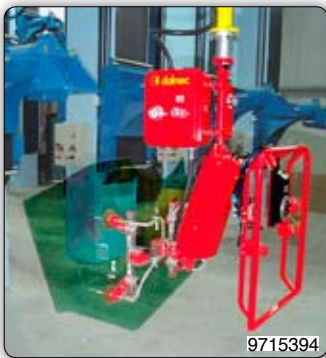
Nastavitelná přísavka k manipulaci a pneumatickému naklápění skleněných tabul o 90°.
