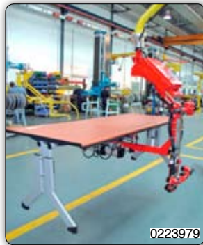
Přísavní zařízení pro manipulaci a pneumatické anebo ruční nakládění/otáčení různých typů produktů.
