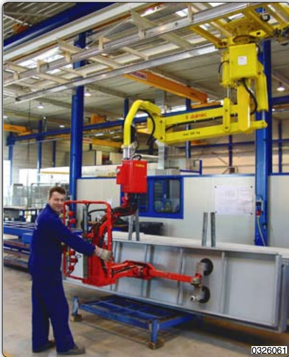
Ruční manipulátor „Partner“ typ PMS, stropní přístroj pojezdový s pneumatickou hnací jednotkou, s nastavitelnou přísavkou k manipulaci a nakládění velkých platin.
