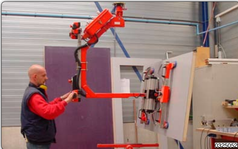
Ruční manipulátor s přísavným zařízením pro manipulaci a pneumatické otáčení dřevěných platní proměnlivých velikostí o 180°. Polohy přísavek jsou ručně nastavitelné.
