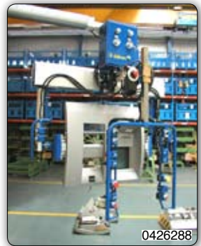
Ruční manipulátor „Partner“ typ PMS, stropní přístroj pojezdový s pneumatickou hnací jednotkou, s nastavitelnou přísavkou k manipulaci a nakládění velkých platin.
