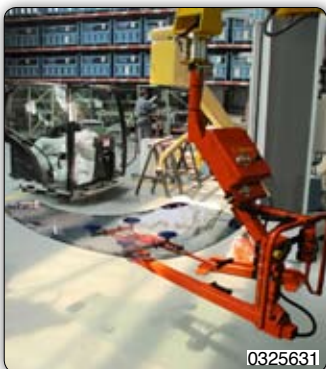
Ruční manipulátor s přísavním zařízením k ručnímu otáčení a naklápění skla.
