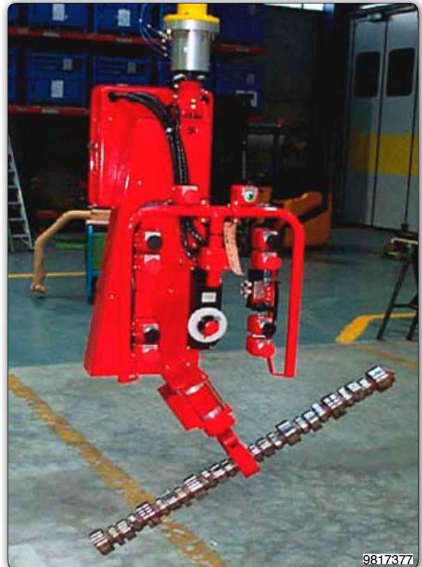
Ruční manipulátor s drapákem k uchopení a naklápění váčkových hřídelů.
