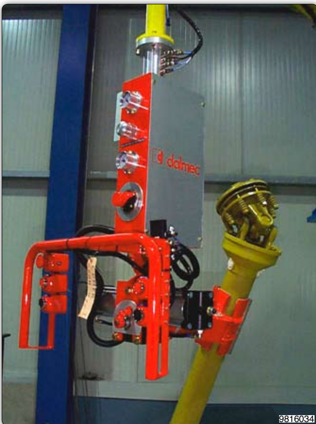
Ruční manipulátor s pneumatickým drapákem k uchopení a otáčení hnacích hřídelů.
