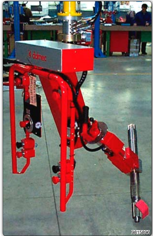
Ruční manipulátor s pneumatickým drapákem k uchopení, naklápění a otáčení hnacích hřídelů.
