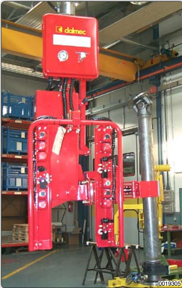
Ruční manipulátor s přísavným zařízením k uchopení a otáčení hnacích hřídelů.
