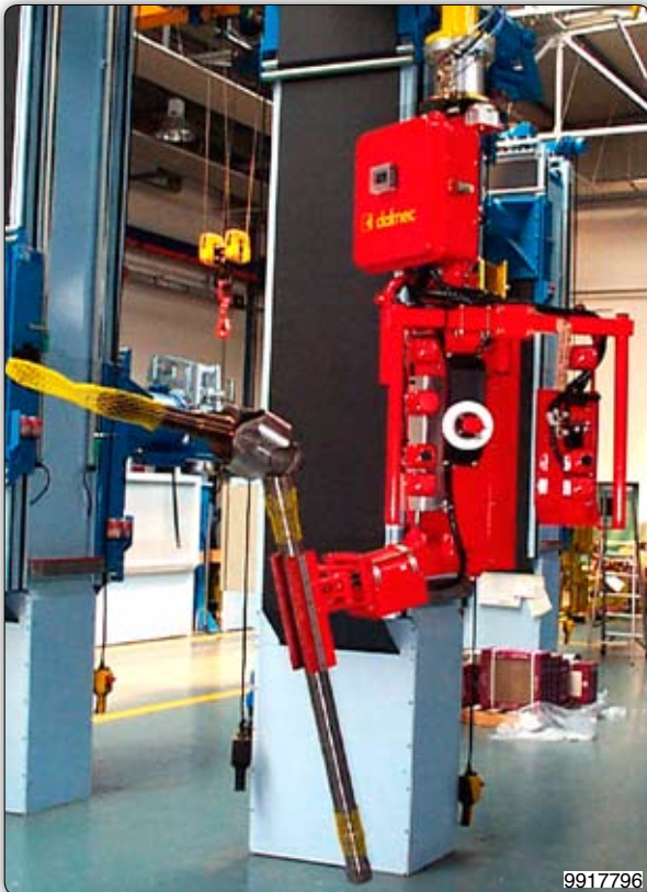
Ruční manipulátor s pneumatickým drapákem k uchopení, naklápění a otáčení hnacích hřídelů.
