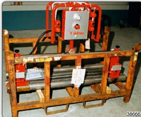
Ruční manipulátor s úchopním zařízením s dvojitými a nastavitelnými čelistěmi drapáku k uchopení hnacích hřídelů.
