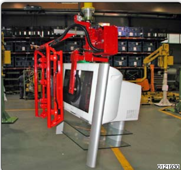
Ruční manipulátor s přísavním zařízením k uchopení televizorů a manipulaci s nimi.
