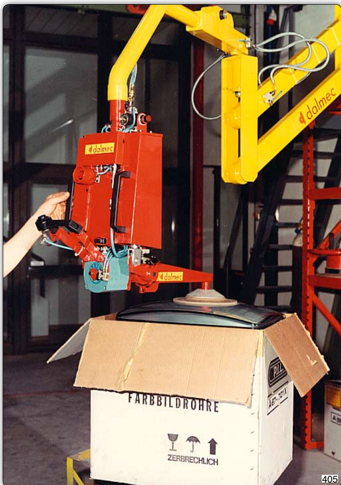
Ruční manipulátory s přísavním zařízením (Venturi) k uchopení, naklápění a otáčení obrazovek.
