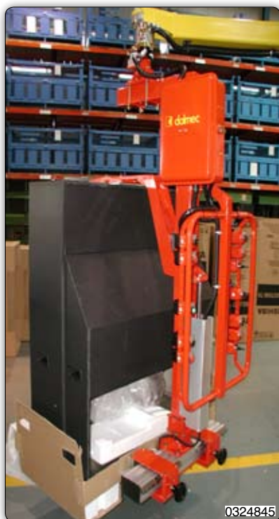
Ruční manipulátor s vidlicovým zařízením k manipulaci se zabalenými televizory.
