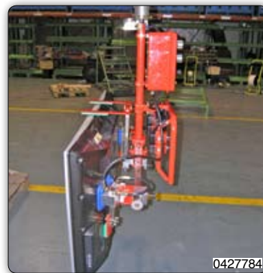
Ruční manipulátor s přísavním zařízením k uchopení a manipulaci LCD televizorů.
