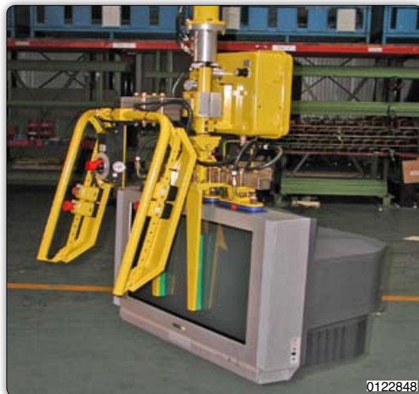
Ruční manipulátor s přísavním zařízením k uchopení televizorů za obrazovku a odložení do kartonu.
