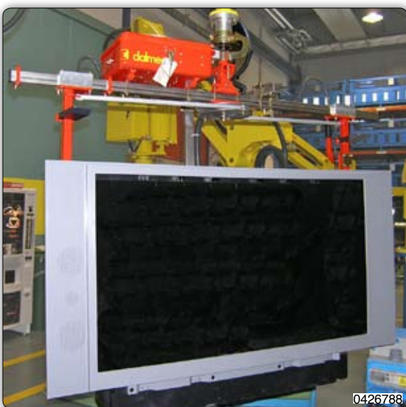
Ruční manipulátor s přísavním zařízením k uchopení a manipulaci LCD televizorů.
