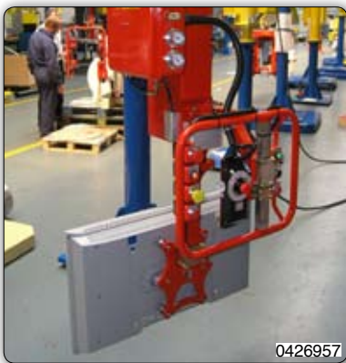
Ruční manipulátor s přísavním zařízením k uchopení a manipulaci LCD televizorů.
