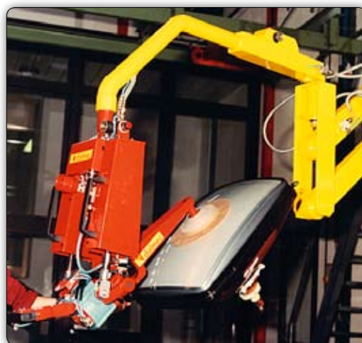
Ruční manipulátory s přísavním zařízením (Venturi) k uchopení, naklápění a otáčení obrazovek.
