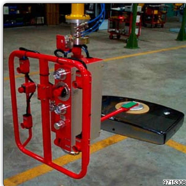
Ruční manipulátor s přísavním zařízením k uchopení a naklápení skel pro obrazovky.
