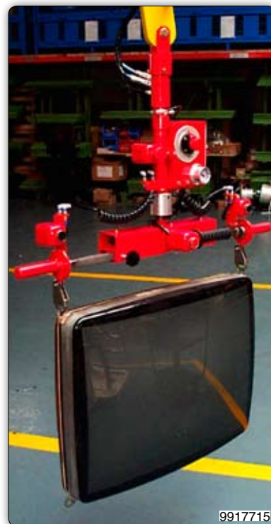
Ruční manipulátor s háčky s nastavitelnou vzdáleností os k uchopení obrazovek.
