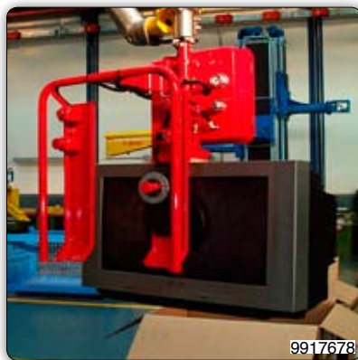
Ruční manipulátor s přísavním zařízením k uchopení a manipulaci televizorů.
