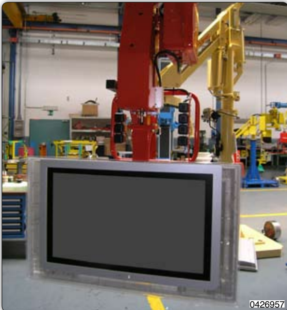
Ruční manipulátor s přísavním zařízením k uchopení a manipulaci LCD televizorů.
