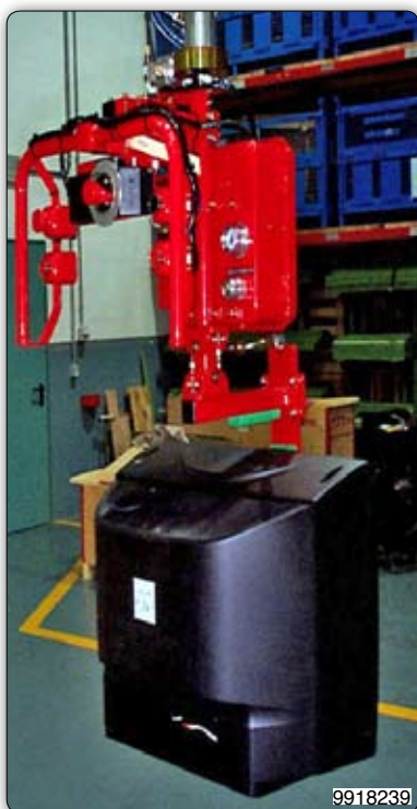
Ruční manipulátor s přísavním zařízením k uchopení televizorů za obrazovku a odložení do kartonu.
