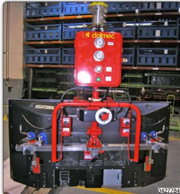
Ruční manipulátor s přísavním zařízením k uchopení a manipulaci LCD televizorů.
