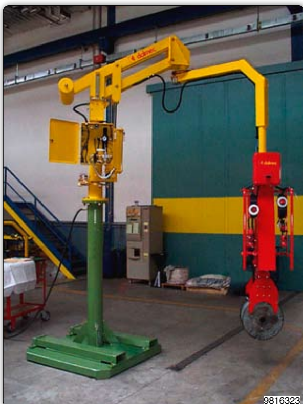
Ruční manipulátor „Partner“ typ PMC, sloupový přístroj s pneumatickým úchopním zařízením. Cívky s ocelovým drátem se přírubou uchopí a pneumaticky naklopí o 90°.
