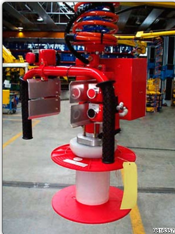
Ruční manipulátor s pneumatickým rozpínacím trnem k uchopení cívký za vnitřní průměr.
