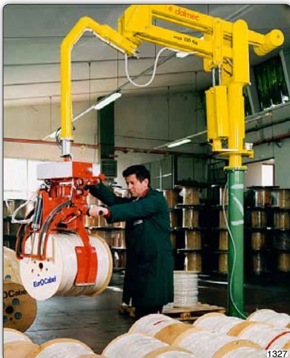
Ruční manipulátor „Partner“ typ PMC, sloupový přístroj s pneumatickým drapákem k uchopení cívky s ocelovým drátem na vnějším průměru. Nakládání cívky z horizontální do vertikální polohy se děje pneumaticky.
