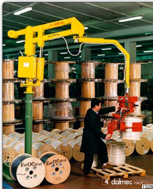
Ruční manipulátor „Partner“ typ PMC, sloupový přístroj s pneumatickým drapákem k uchopení cívky s ocelovým drátem na vnějším průměru. Nakládání cívky z horizontální do vertikální polohy se děje pneumaticky.
