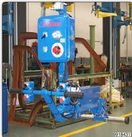
Handhabungs-Manipulator mit pneumatischer Greifvorrichtung zur Aufnahme und Schwenkung von Wellen.
