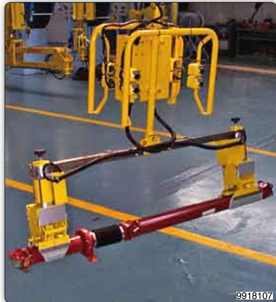
Handhabungs-Manipulator mit Aufnahmevorrichtung mit doppelten und verstellbaren Greiferbacken zur Aufnahme von Antriebswellen.
