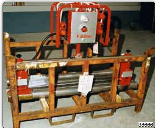
Handhabungs-Manipulator mit Aufnahmevorrichtung mit doppelten und verstellbaren Greiferbacken zur Aufnahme und Handhabung von Antriebswellen.
