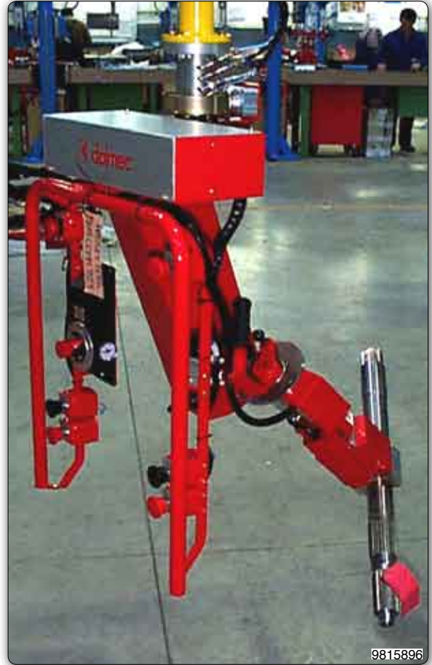
Handhabungs-Manipulator mit pneumatischer Greifvorrichtung zur Aufnahme, Schwenkung und Drehung von Antriebswellen.
