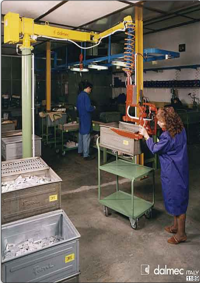
Handhabungs-Manipulator Posifil Typ PFC, Säulengerät mit Gabelvorrichtung für die Handhabung der Metallkästen.
