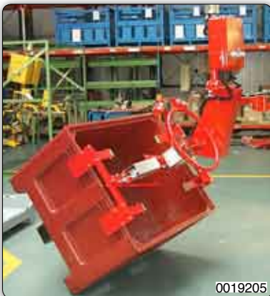
Handhabungs-Manipulator "Partner" Typ PMC, Säulengerät mit pneumatischer Greifvorrichtung für die Aufnahme, Schwenkung und manuelle Drehung von Plastikbehältern von verschiedenen Größen.
