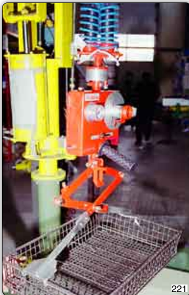
Handhabungs-Manipulator mit Pantographvorrichtung für die Handhabung von metallischen Körben.
