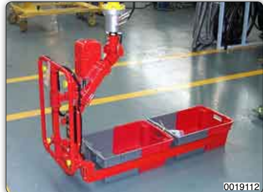
Handhabungs-Manipulator mit Gabelvorrichtung für die Aufnahme und Handhabung von Behältern.
