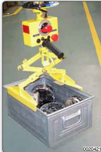
Handhabungs-Manipulator mit Pantographvorrichtung für die Handhabung von Behältern.
