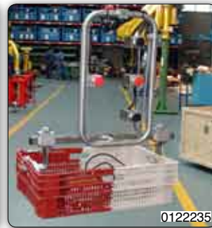
Handhabungs-Manipulator "Partner" Deckengerät an Laufbahnschienen verfahrbar, mit pneumatischer Motorisierung, mit verschiedenen regelbaren Haken zum Handhaben von 1 bis 8 Kisten für Getränke verschiedener Größen.
