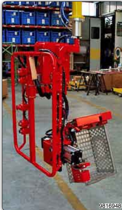
Handhabungs-Manipulator mit pneumatischer Greifvorrichtung für die Aufnahme und pneumatische Entleerung von Behältern.
