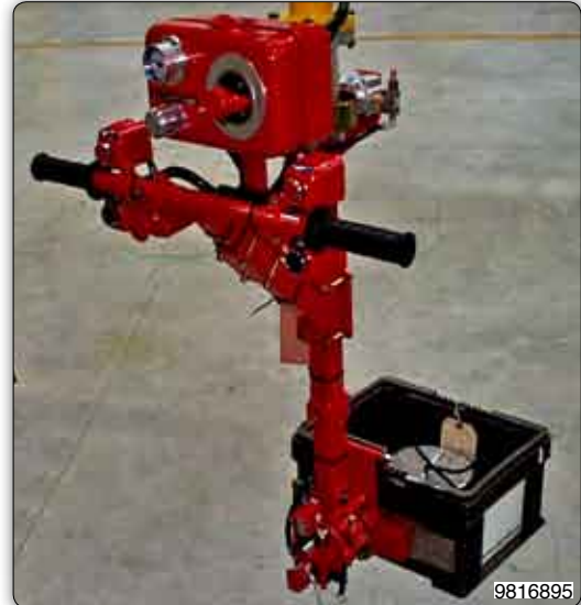
Handhabungs-Manipulator mit Gabelvorrichtung für die Aufnahme und Handhabung von Behältern.
