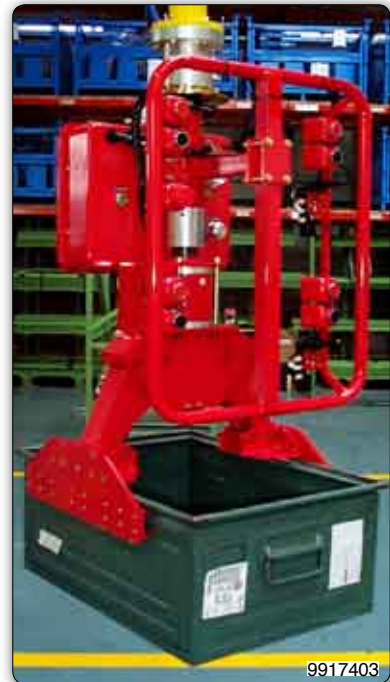
Handhabungs-Manipulator mit pneumatischer Greifvorrichtung für die Aufnahme von Behältern.
