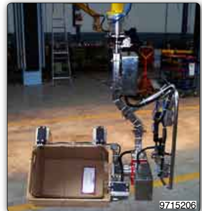
Handhabungs-Manipulator mit pneumatischer Greifvorrichtung aus Edelstahl zur Aufnahme und Entleerung von Apfelkästen.
