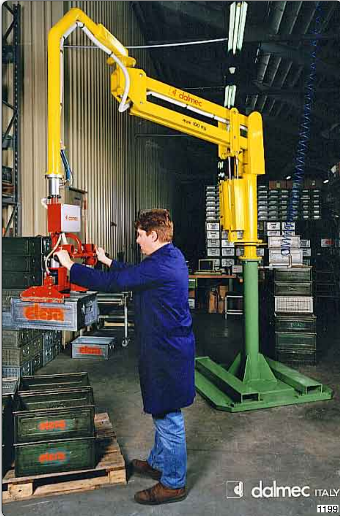
Handhabungs-Manipulator Typ PMC, Säulengerät auf einer verfahrenbaren Grundplatte, mit Greifvorrichtung zum Umsetzen von Behältern.
