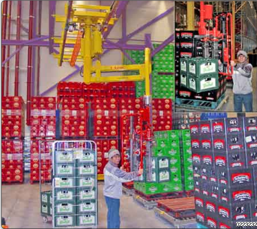
Handhabungs-Manipulator "Partner" Deckengerät an Laufbahnschienen verfahrbar, mit pneumatischer Motorisierung, mit verschiedenen regelbaren Haken zum Handhaben von 1 bis 8 Kisten für Getränke verschiedener Größen.
