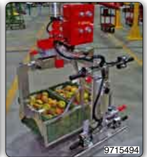
Handhabungs-Manipulator "Partner" Deckengerät an Laufbahnschienen verfahrbar, mit pneumatischer Motorisierung, mit verschiedenen regelbaren Haken zum Handhaben von 1 bis 8 Kisten für Getränke verschiedener Größen.
