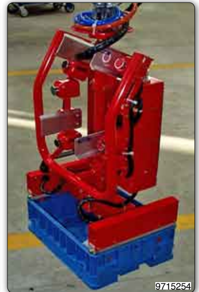
Handhabungs-Manipulator mit Greifvorrichtung für die Aufnahme am oberen Rand der Behälter.
