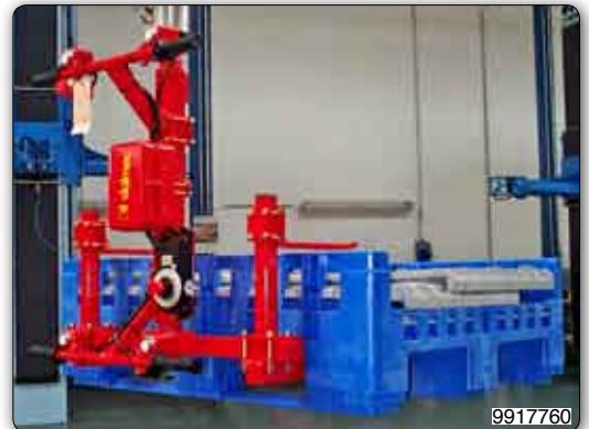
Handhabungs-Manipulator mit Greifvorrichtung für die Handhabung von Plastikkräben.
