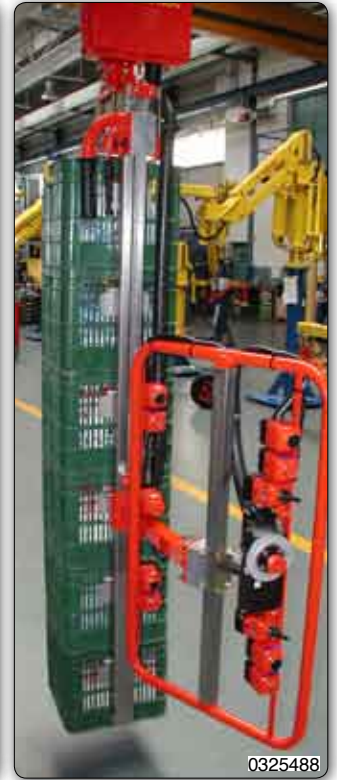
Handhabungs-Manipulator "Partner" Deckengerät an Laufbahnschienen verfahrbar, mit pneumatischer Motorisierung, mit verschiedenen regelbaren Haken zum Handhaben von 1 bis 8 Kisten für Getränke verschiedener Größen.
