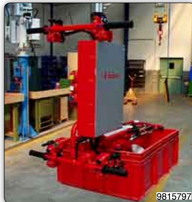
Handhabungs-Manipulator mit Greifvorrichtung für die Aufnahme und Handhabung von Plastikbehältern von verschiedenen Größen.
