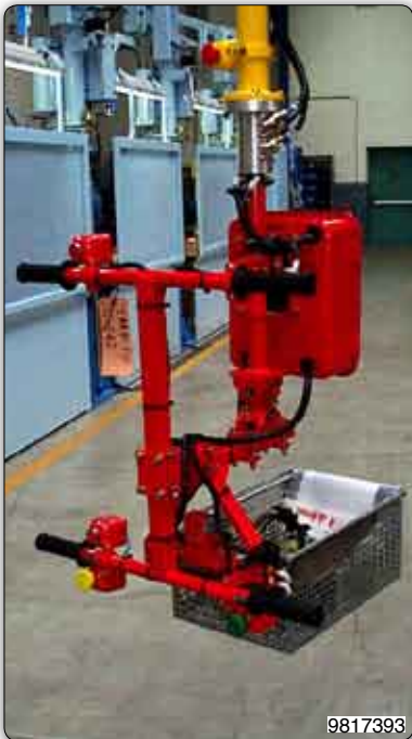
Handhabungs-Manipulator mit Gabelvorrichtung für die Handhabung von metallischen Behältern.
