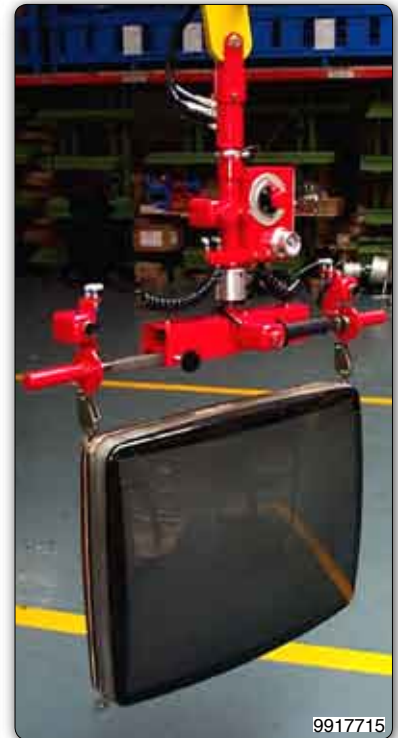
Handhabungs-Manipulator mit Hakenvorrichtung mit einstellbarem Achsabstand zur Aufnahme an den Ösen der Bildröhren.
