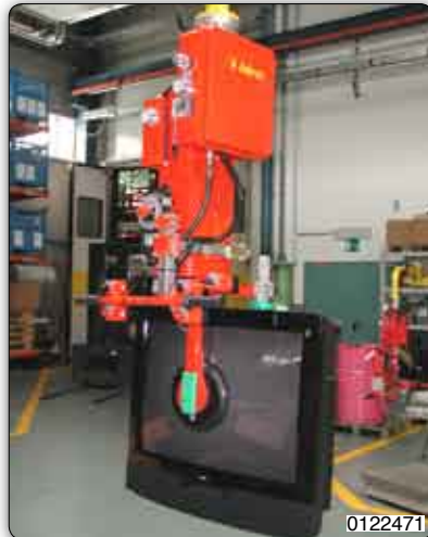
Handhabungs-Manipulator mit Saugvorrichtung zur Aufnahme und Handhabung von Fernsehgeräten.
