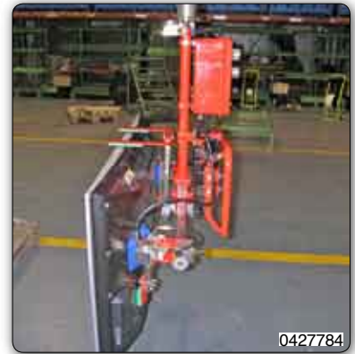
Handhabungs-Manipulator mit Saugvorrichtung zur Aufnahme und Handhabung von Fernsehgeräten LCD.
