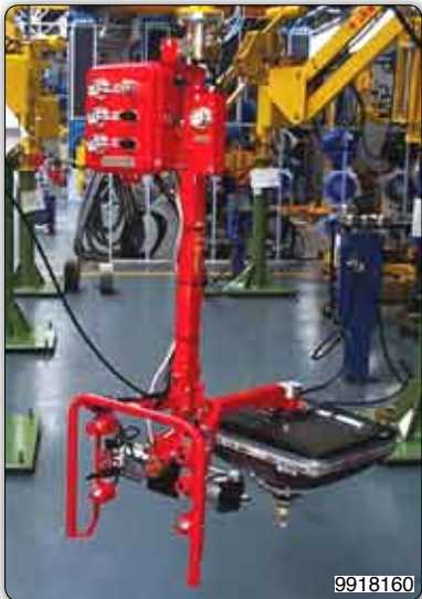
Handhabungs-Manipulator mit Saugvorrichtung (Venturi) zur Aufnahme und pneumatischen Drehung um 180° von Bildröhren, der Sauger ist manuell drehbar.
