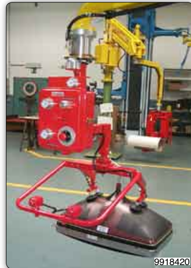
Handhabungs-Manipulator mit Saugvorrichtung (Venturi) zur Aufnahme und Handhabung von Bildröhren auf dem Konus.
