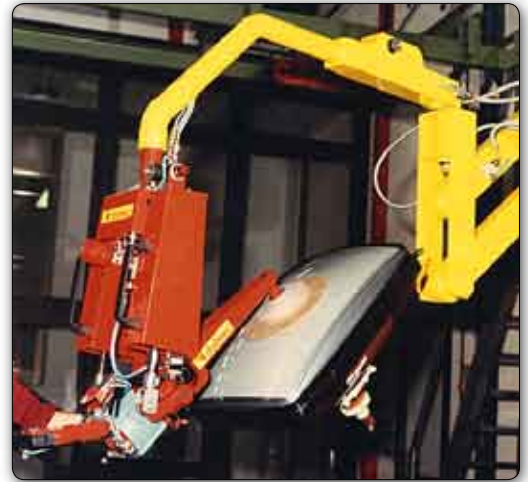
Handhabungs-Manipulatoren mit Saugvorrichtung (Venturi) zur Aufnahme, Schwenkung und Drehung der Bildröhren.
