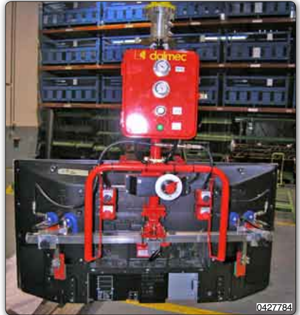
Handhabungs-Manipulator mit Saugvorrichtung zur Aufnahme und Handhabung von Fernsehgeräten LCD.
