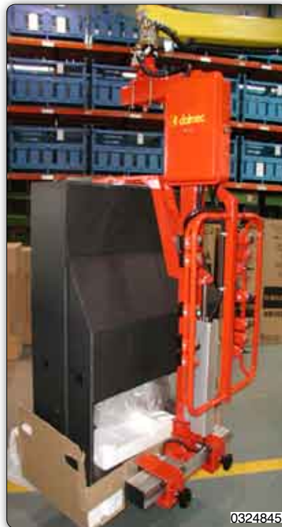
Handhabungs-Manipulator mit Gabelvorrichtung zur Handhabung der verpackten Fernsehgeräten.
