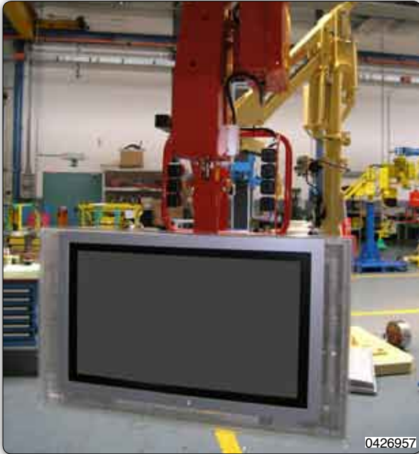
Handhabungs-Manipulator mit Saugvorrichtung zur Aufnahme und Handhabung von Fernsehgeräten LCD.
