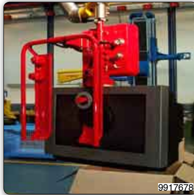
Handhabungs-Manipulator mit Saugvorrichtung zur Aufnahme und Handhabung von Fernsehgeräten.
