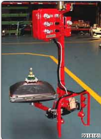
Handhabungs-Manipulator mit Saugvorrichtung (Venturi) zur Aufnahme und pneumatischen Drehung um 180° von Bildröhren, der Sauger ist manuell drehbar.
