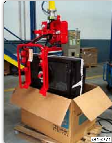
Handhabungs-Manipulator mit Saugvorrichtung zur Aufnahme von Fernsehgeräten auf dem Bildschirm und zur Ablage in den Verpackungskarten.
