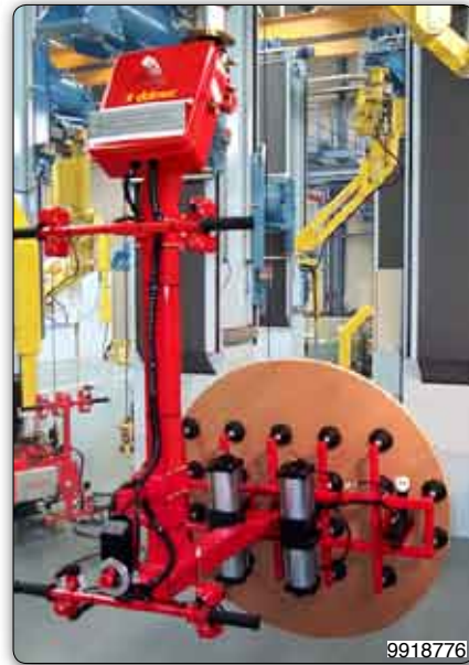
Handhabungs-Manipulator mit Saugvorrichtung zur Aufnahme und pneumatischen Drehung um 180° von Holzpaneelen.
