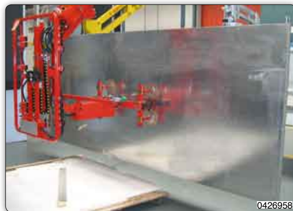
Handhabungs-Manipulator mit Saugvorrichtung zum Aufnehmen von Kunststoffplatten.
