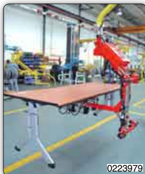
Saugvorrichtungen für die Handhabung und die pneumatische oder manuelle Schwenkung/Drehung verschiedener Produkttypen.
