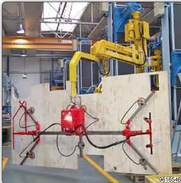
Handhabungs-Manipulator "Partner" Typ PMF, Deckengerät stationär mit Saugvorrichtung zur Handhabung und pneumatischen Schwenkung um 90° von Flachböden für Wohnmobile.
