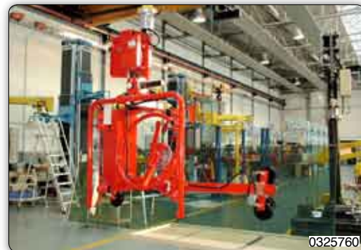
Saugvorrichtung zur Handhabung, manuellen Drehung um 360° und pneumatischen Schwenkung um 90° von Glasscheiben.
