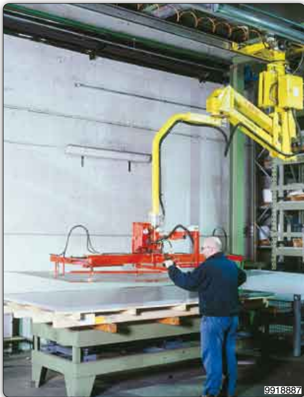
Handhabungs-Manipulator "Partner" Typ PMS, Deckengerät verfahrbar mit Saugvorrichtung für Blechtafeln aus Edelstahl. Bei dieser Anwendung werden großformatige Blechtafeln nicht nur umgesetzt, sondern auch gleichzeitig kontrolliert. Dies wird durch eine pneumatisch unterstützte Schwenkung ermöglicht.
