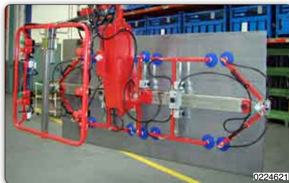
Handhabungs-Manipulator mit Saugvorrichtung zum Aufnehmen von Kunststoffplatten.
