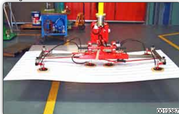
Handhabungs-Manipulator mit Saugvorrichtung zum Aufnehmen von Kunststoffplatten.
