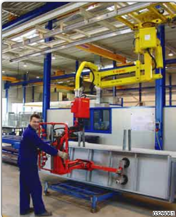
Handhabungs-Manipulator "Partner" Typ PMS, Deckengerät verfahrbar mit pneumatischer Antriebseinheit, mit einstellbarer Saugvorrichtung zur Handhabung und Schwenkung von großen Platten.
