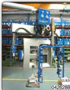
Saugvorrichtungen für die Handhabung und die pneumatische oder manuelle Schwenkung/Drehung verschiedener Produkttypen.
