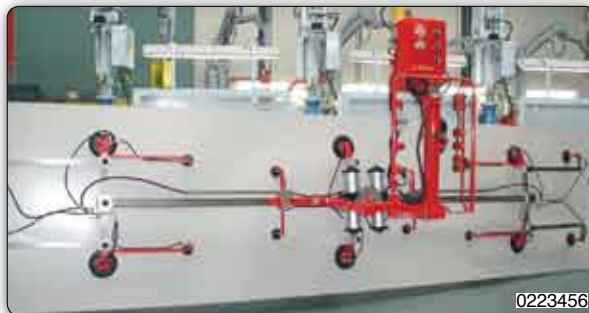
Handhabungs-Manipulator "Partner" Typ PMS, Deckengerät verfahrbar mit pneumatischer Antriebseinheit, mit einstellbarer Saugvorrichtung zur Handhabung und Schwenkung von großen Platten.
