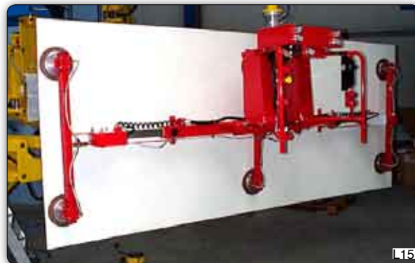
Bei dieser Aufnahmevorrichtung können laminierte Platten pneumatisch um 90° vertikal geschwenkt werden. Die Positionierung der einzelnen Sauger ist manuell einstellbar, je nach Größe der zu handhabenden Platten. Das Vakuum wird durch eine Ejektor-Düse, die in der Vorrichtung integriert ist, erzeugt.
