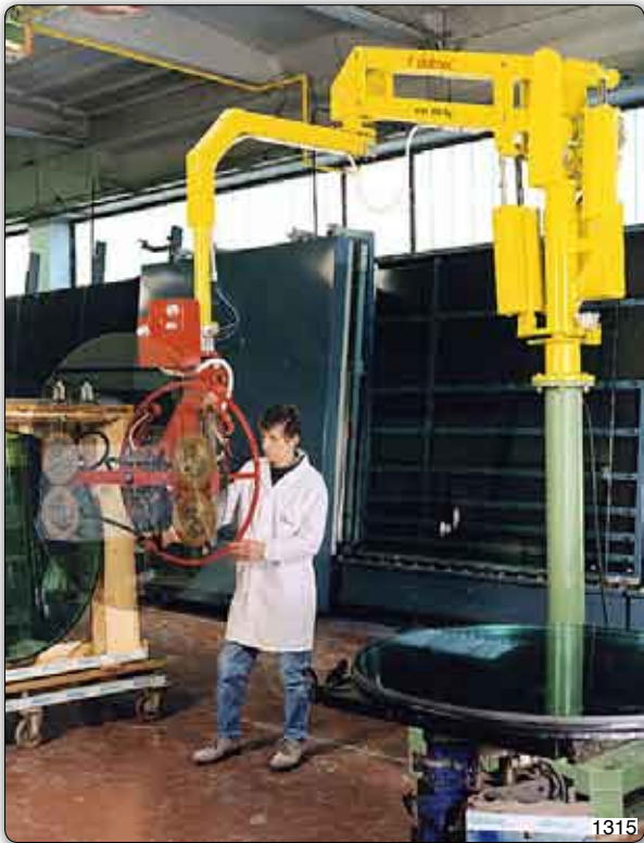
Handhabungs-Manipulator "Partner" Typ PMC, Säulengerät mit Saugvorrichtung zur Aufnahme der Glasscheiben vom Wagen und Ablage auf einem Bearbeitungstisch. Die Produkte werden pneumatisch um 90° geschwenkt und manuell um 360° gedreht.
