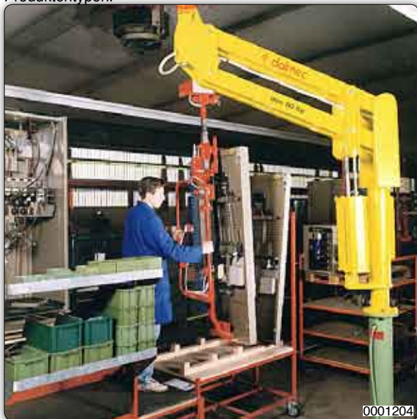
Handhabungs-Manipulator "Partner" Typ PMC, Säulengerät mit Greifvorrichtung für die Aufnahme und Handhabung von Türen für Getränkeautomaten.
