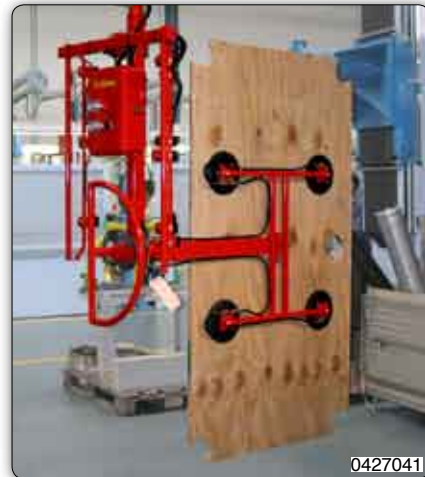
Handhabungs-Manipulator mit Saugvorrichtung zur Aufnahme und manuellen Drehung von Holzpaneelen.
