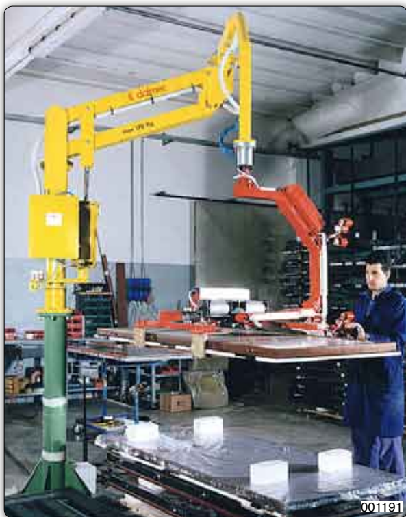
Schwere Sicherheitstüren werden mit diesem selbst zentrierenden Greifer aufgenommen, um 180° pneumatisch geschwenkt und auf Palette abgelegt.
