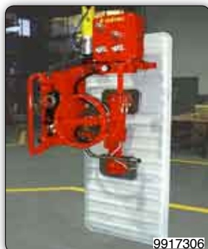
Saugvorrichtungen für die Handhabung und die pneumatische oder manuelle Schwenkung/Drehung verschiedener Produkttypen.
