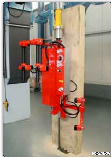
Handhabungs-Manipulator mit Saugvorrichtung mit Zentrierungen zur Handhabung und Schwenkung von besonderen Platten.
