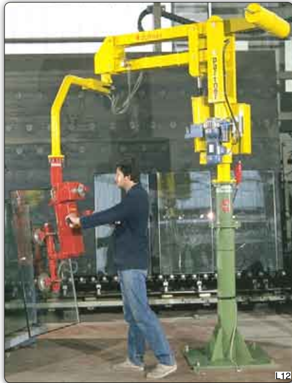
Mit diesem Handhabungs-Manipulator "Partner" Typ PMC, Säulengerät mit Saugvorrichtung werden Glasscheiben aus einem Förderer entnommen und auf einem Transportwagen abgelegt. Die Vakuumerzeugung erfolgt durch eine elektrische Pumpe.
