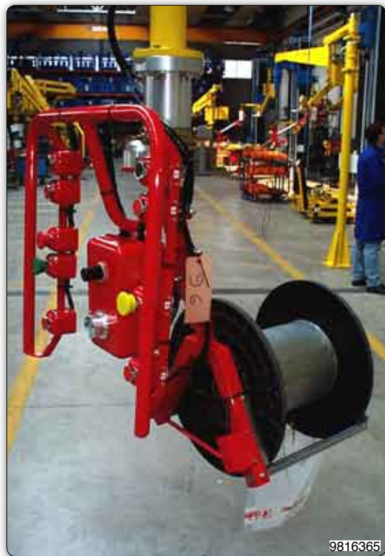
Handhabungs-Manipulator mit Gabelvorrichtung für die Aufnahme der Spulen unter den Flanschen und mit Sensoren für die Produkterkennung ausgestattet.
