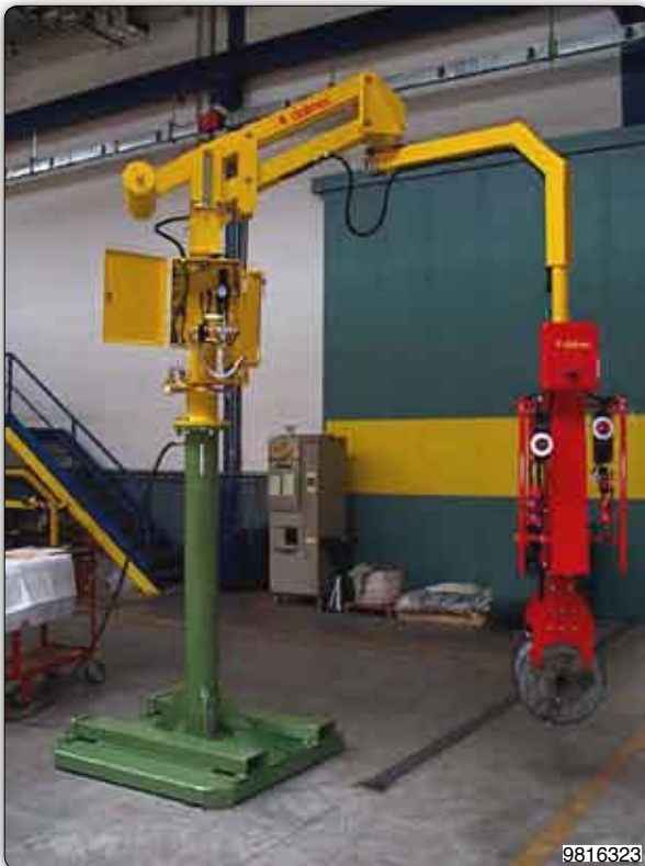
Handhabungs-Manipulator "Partner" Typ PMC, Säulengerät mit pneumatischer Greifvorrichtung. Die Spulen für Stahldraht werden am Flansch aufgenommen und pneumatisch um 90° geschwenkt.
