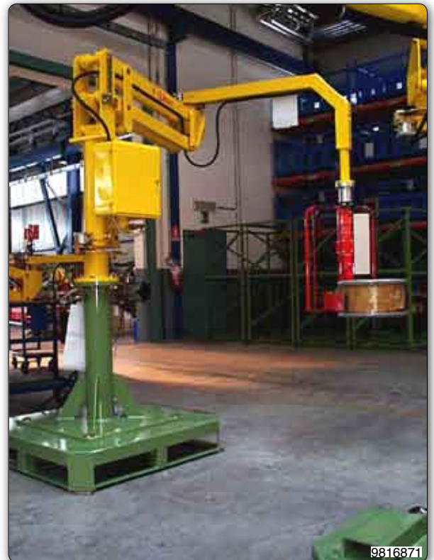
Handhabungs-Manipulator "Partner" Typ PMC, Säulengerät mit pneumatischer Greifvorrichtung für die Aufnahme von Spulen für Stahldraht am Außendurchmesser.
