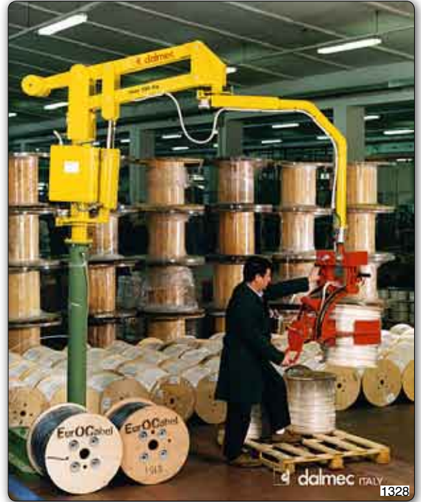
Handhabungs-Manipulator "Partner" Typ PMC, Säulengerät mit pneumatischer Greifvorrichtung zum Aufnehmen von Spulen für Stahldraht am Außendurchmesser. Die Schwenkung der Spulen von der Horizontalen in die Vertikale erfolgt pneumatisch.
