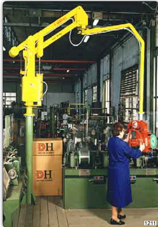
Handhabungs-Manipulator "Partner" Typ PMC, Säulengerät mit Greifvorrichtung für die Aufnahme von Drahtspulen am Außendurchmesser.
