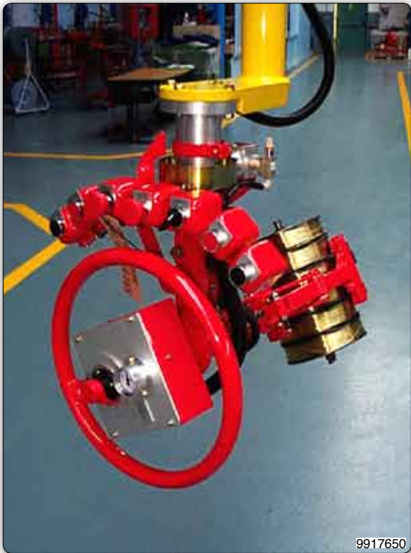
Handhabungs-Manipulator mit spezieller Greifvorrichtung für die Aufnahme von Vielfachspulen. Die Drehung um 90° erfolgt manuell.
