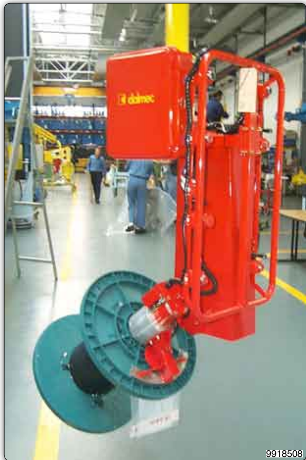
Handhabungs-Manipulator mit Innenspreizvorrichtung für Spulen und pneumatischer Schwenkung um 90°.
