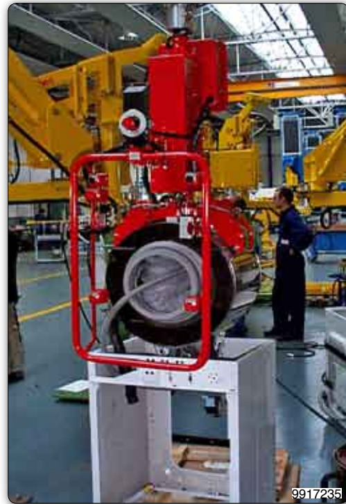
Greifvorrichtung für die Aufnahme und zum Einlegen der Waschtrommel von oben.
