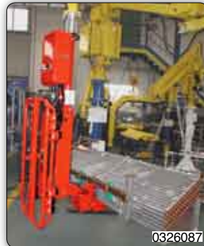
Greifvorrichtung zur Aufnahme und manuellen Drehung um 90° von Schlangen für Klimaanlage.
