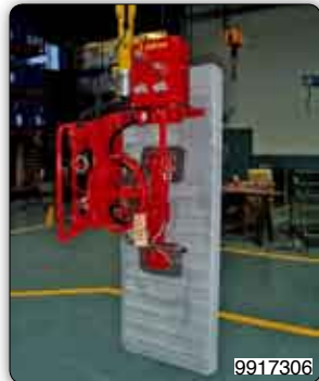
Saugvorrichtung zur Aufnahme von Austauschpaneelen für Kühlzellen.
