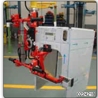
Hakenvorrichtung zur Handhabung von Waschmaschinekörpern.
