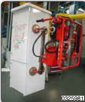
Saugvorrichtung zur Aufnahme und manuellen Drehung um 90° von Kühlschränken.
