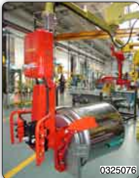
Greifvorrichtung zur Aufnahme und pneumatischen Schwenkung um 90° von Waschtrommeln.
