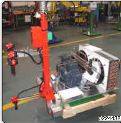
Gabelvorrichtung zur Aufnahme und Handhabung von Kühlschrankgruppen (Kompressor-Panel zum Wärmeaustausch).
