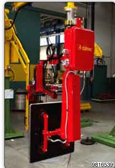
Handhabungs-Manipulator mit Greifvorrichtung zur Aufnahme und Handhabung von Kochplatten.
