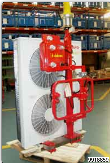
Handhabungs-Manipulator mit Gabelvorrichtung zur Handhabung von Klimaanlage auf Paletten.
