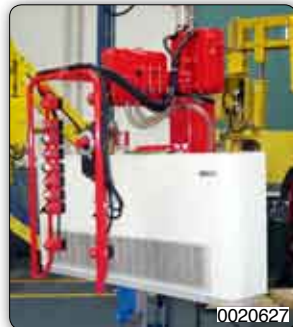
Saugvorrichtung zur Aufnahme und Schwenkung um 90° von Konvektoren.
