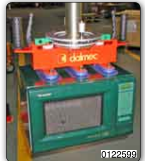
Saugvorrichtung zur Aufnahme und Handhabung von Mikrowellenöfen.
