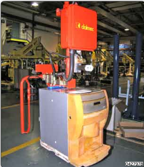
Handhabungs-Manipulator mit Saugvorrichtung zur Aufnahme und Handhabung von Getränkeautomaten.
