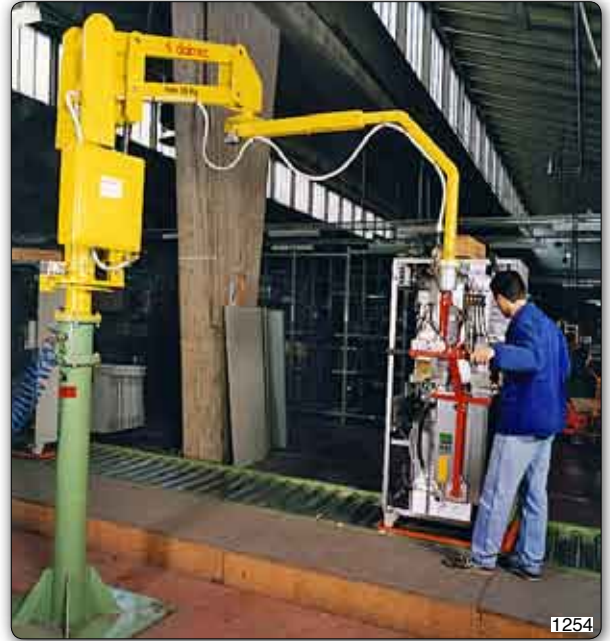
Handhabungs-Manipulator, Typ PMC, Säulengerät mit Gabelvorrichtung zur Handhabung von Teilen der Getränkeautomaten.
