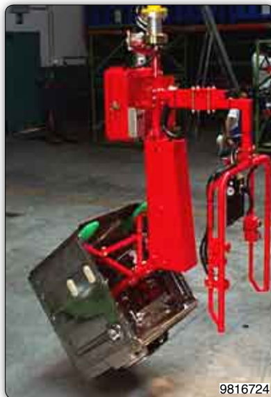
Handhabungs-Manipulator mit pneumatischer Greifvorrichtung zur Aufnahme und Schwenkung von inneren Rahmen für Geschirrspülmaschinen.
