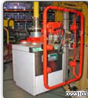
Saugvorrichtung für die Aufnahme und Handhabung von elektrischen Öfen.
