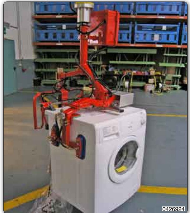
Handhabungs-Manipulator mit Saugvorrichtung zur Aufnahme und Handhabung von Waschmaschinen.
