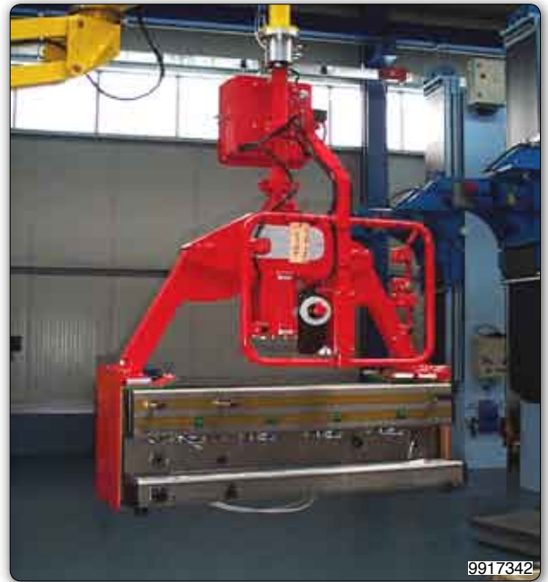
Handhabungs-Manipulator mit Greifvorrichtung zur Aufnahme und Handhabung von Kaffeemaschinen.
