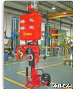
Greifvorrichtung zur Aufnahme und Handhabung von Kältschrankkompressoren.
