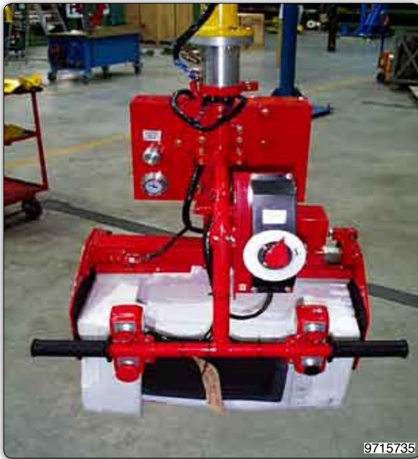
Handhabungs-Manipulator mit Greifvorrichtung zur Aufnahme und Handhabung von Mikrowellenöfen.
