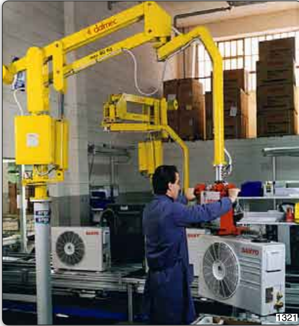
Handhabungs-Manipulator, Typ PMC, Säulengerät mit Saugvorrichtung zur Handhabung von Klimaanlageen.
