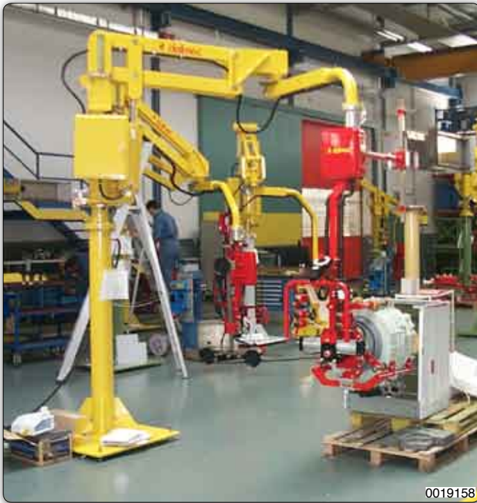
Handhabungs-Manipulator, Typ PMC, Säulengerät mit pneumatischer Greifvorrichtung für die Aufnahme, Drehung und zum Einlegen von Waschtrommeln in die Rahmen.
