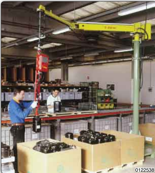
Handhabungs-Manipulator, Typ PFC, Säulengerät ausgerüstet mit Saugvorrichtung für die Handhabung von Kühlschrankkompressoren.
