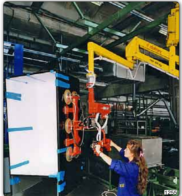
Handhabungs-Manipulator, Typ PMS Deckengerät verfahrbar, mit Saugvorrichtung zur Handhabung von Kühlschrankkörpern.
