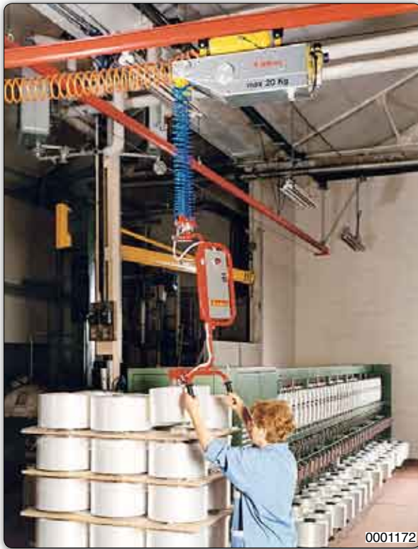
Handhabungs-Manipulator "Minipartner" Typ MPS, Deckengerät an Querbrücke verfahrbar mit pneumatischer Greifvorrichtung zur Aufnahme und Handhabung von Spulen.
