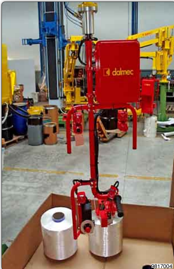
Handhabungs-Manipulator mit pneumatischem Spreizdorn. Die Spulen werden im Innendurchmesser aufgenommen und von der Horizontalen in die Vertikale, oder umgekehrt, manuell gedreht.
