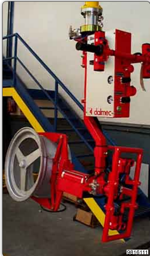
Handhabungs-Manipulator mit Greifvorrichtung zur Aufnahme von Alufelgen. Die Vorrichtung ist manuell drehbar.
