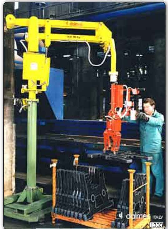
Handhabungs-Manipulator "Partner" Typ PMC, Säulengerät mit verfahrbarer Grundplatte, mit pneumatischer Greifbackenvorrichtung für die Handhabung von Gussteilen.
