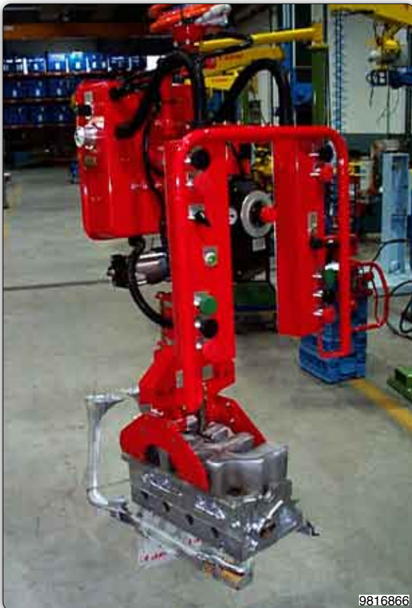
Handhabungs-Manipulator mit pneumatischer Greifvorrichtung zur Aufnahme und Drehung von Zylinderköpfen aus Aluminium.
