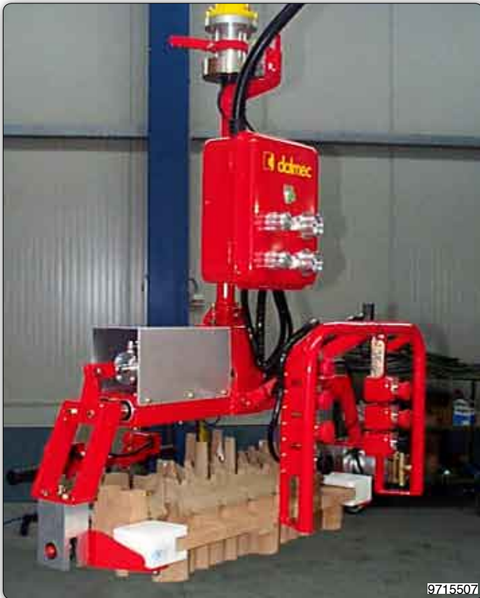
Handhabungs-Manipulator mit pneumatischer Greifvorrichtung zum Aufnehmen und Drehung von Gusskernen.
