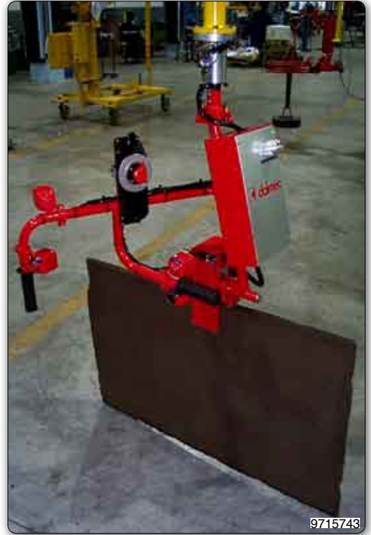
Handhabungs-Manipulator mit pneumatischer Greifvorrichtung zum Handhaben von Schamotteplatten.
