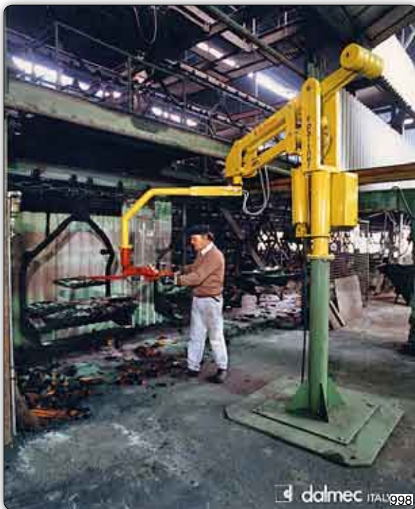
Handhabungs-Manipulator "Partner" Typ PMC, Säulengerät, mit pneumatischer Greifvorrichtung zur Handhabung von Feingussstücken.
