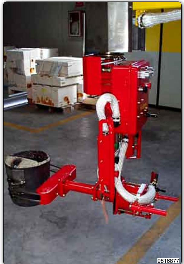
Handhabungs-Manipulator mit pneumatischer Greifereinheit zum Handhaben von Gießpfannen. Die Vorrichtung ist manuell drehbar.
