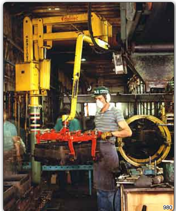
Handhabungs-Manipulator "Partner" Typ PMC, Säulengerät, mit pneumatischer Greifvorrichtung für die Handhabung von Kernkasten.
