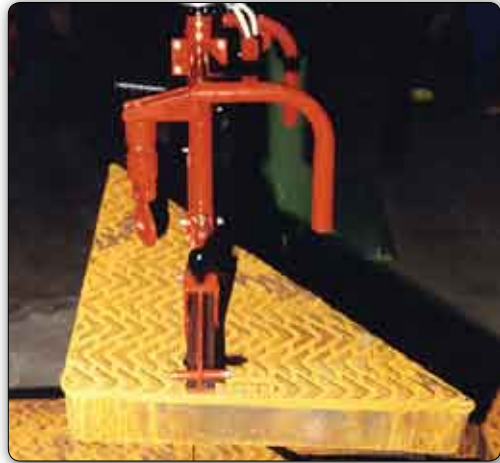
Handhabungs-Manipulator "Partner" Typ PMC, Säulengerät, mit Aufnahmevorrichtung zum Handhaben von Gußeisendeckeln.
