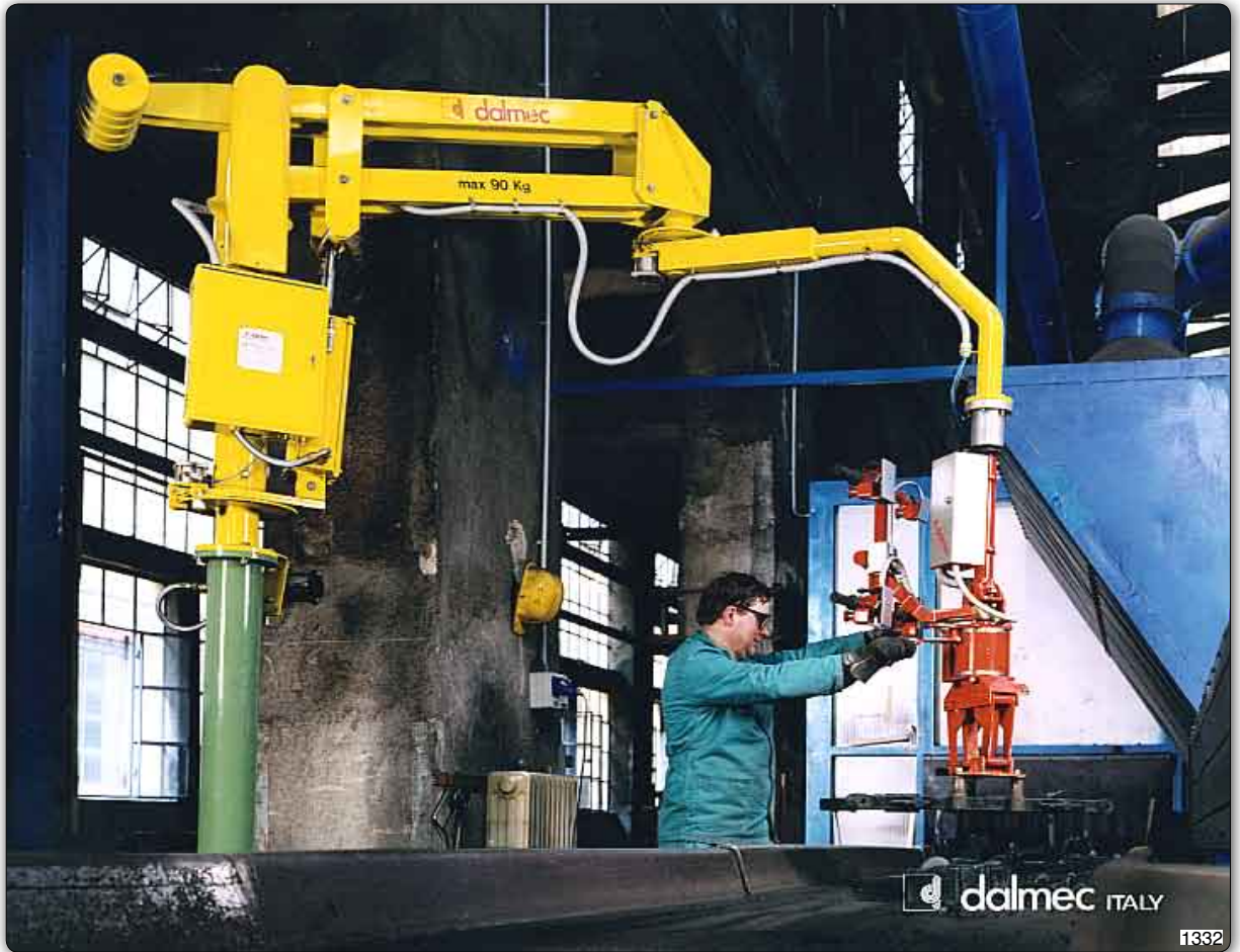
Handhabungs-Manipulator "Partner" Typ PMC, Säulengerät, mit pneumatischer Greifvorrichtung für die Handhabung von Gussteilen.
