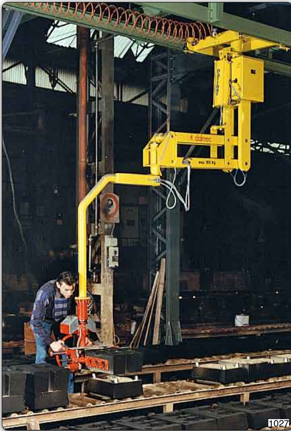
Handhabungs-Manipulator "Partner" Typ PMS, Deckengerät verfahrbar, mit Greifvorrichtung zur Aufnahme von Gießformen.
