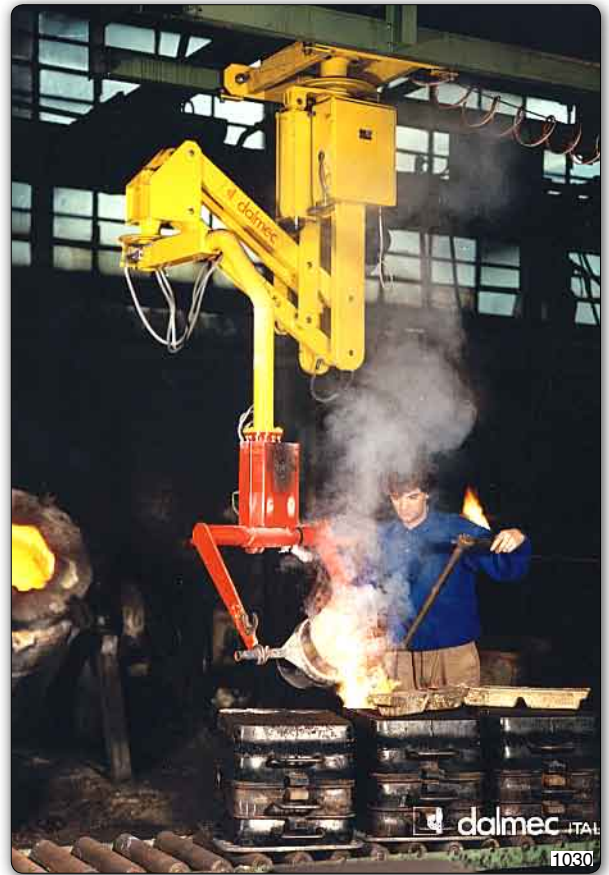
Handhabungs-Manipulator "Partner" Typ PMS, Deckengerät verfahrbar, mit Gabelvorrichtung zum Handhaben von Gießpfannen oder Gießtiegel.
