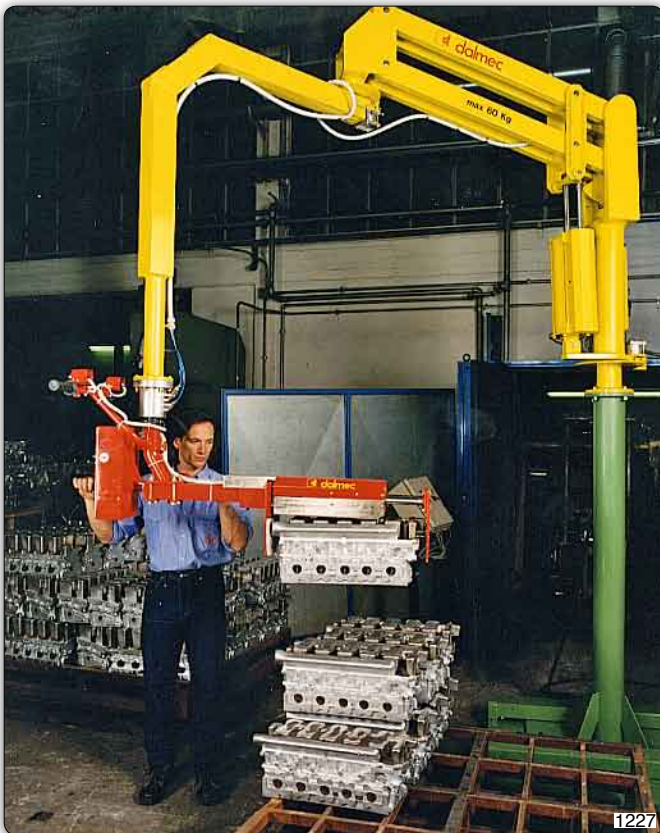
Handhabungs-Manipulator "Partner" Typ PMC, Säulengerät, mit Greifvorrichtung zum Handhaben von Zylinderköpfen aus Aluminium.
