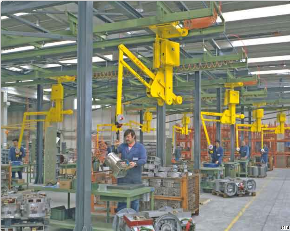
Handhabungs-Manipulatoren "Partner" Typ PSS, deckenverfahrbar, zum Montieren von Elektromotoren. Laufbahnen und Stahlbau aus dem Dalmecc-Lieferprogramm.
