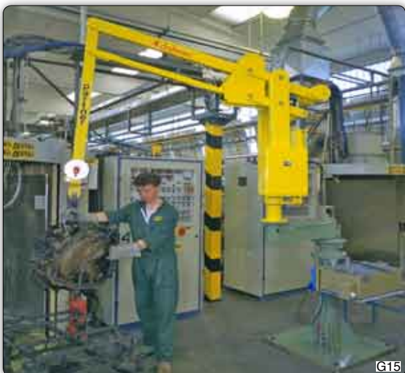
Handhabungs-Manipulatoren "Partner" Typ PSC, Säulengerät mit auskrager Säuleneinheit, für die Handhabung von Gussformen für Harzprodukte.
