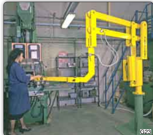
Handhabungs-Manipulator "Partner" Typ PMC, mit verkürzter Säuleneinheit und abgewinkeltem Auslegearm. Spezieller Flansch zur Aufnahme von Sandmasken aus einem Regal.
