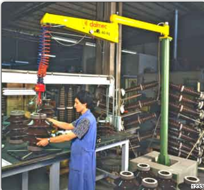
Ein müheloses Umsetzen der Isolatoren ermöglicht dieser Handhabungs-Manipulator "Posivel" Typ PVC. Das Säulengerät ist mit einem Ladegeschirr ausgestattet.
