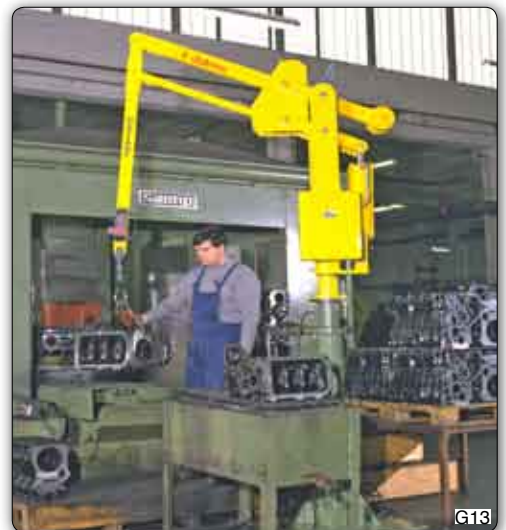
Handhabungs-Manipulator "Partner" Typ PSC, Säulengerät zum Handhaben von Zylinderköpfen an einer Reinigungsanlage.
