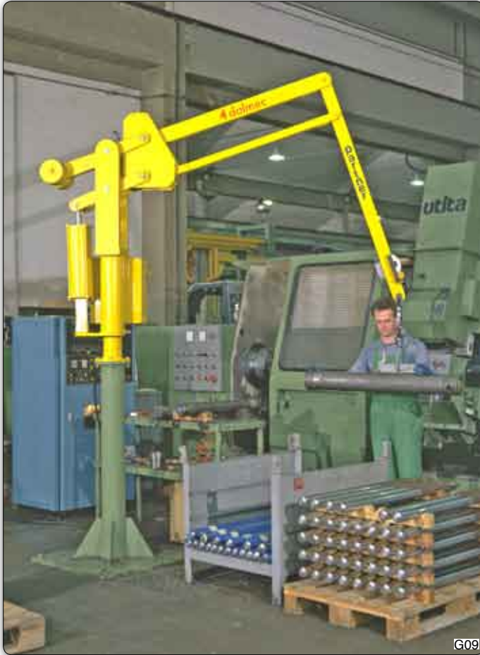
Handhabungs-Manipulator "Partner" Typ PSC, Säulenausführung mit vergrößertem Arbeitsbereich zum Handhaben von Hydraulik-Zylindern.
