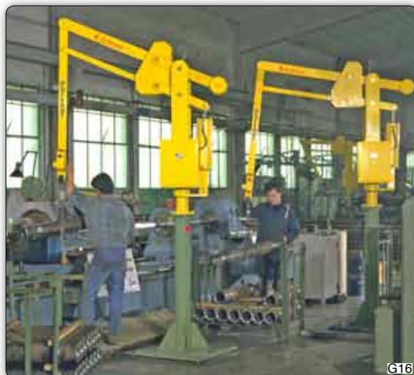
Handhabungs-Manipulator "Partner" Typ PSC, Säulengerät zum Beschicken einer Werkzeugmaschine mit Führungsbuchsen.
