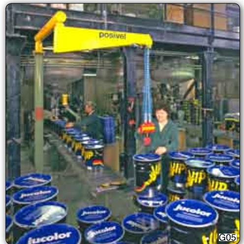
Handhabungs-Manipulator "Posivel" Typ PVC, Säulengerät mit Aufnahmehaken für die Handhabung von Eimern.
