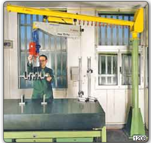
Handhabungs-Manipulator "Minipartner" Typ MPC, Säulenschwenkarm, für die Handhabung von Kurbelwellen an einem Kontrolltisch.
