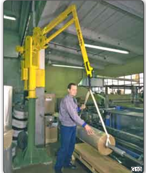
Handhabungs-Manipulator "Partner" Typ PSC, Säulengerät zum Aufnehmen und Umsetzen von Folienrollen.
