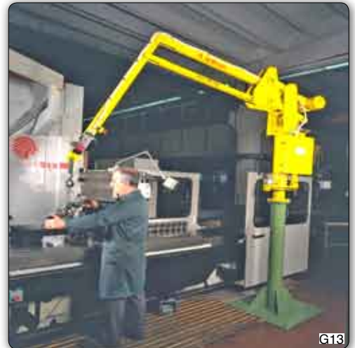
Handhabungs-Manipulator "Partner" Typ PSC, Säulenausführung, zum Beschicken einer Werkzeugmaschine mit Kurbelwellen.
