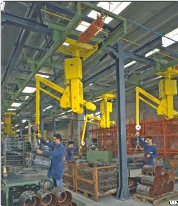
Handhabungs-Manipulator "Partner" Typ PSS, Deckengerät verfahrbar zur Montage von Elektromotoren, Laufbahnen und Stahlbaukonstruktion von Dalmecc.
