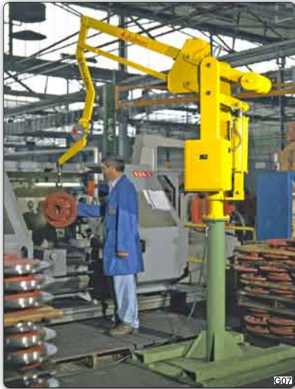
Handhabungs-Manipulator "Partner" Typ PSC, Säulengerät mit speziell geformtem Auslegearm zum Handhaben von Planetenträgern.
