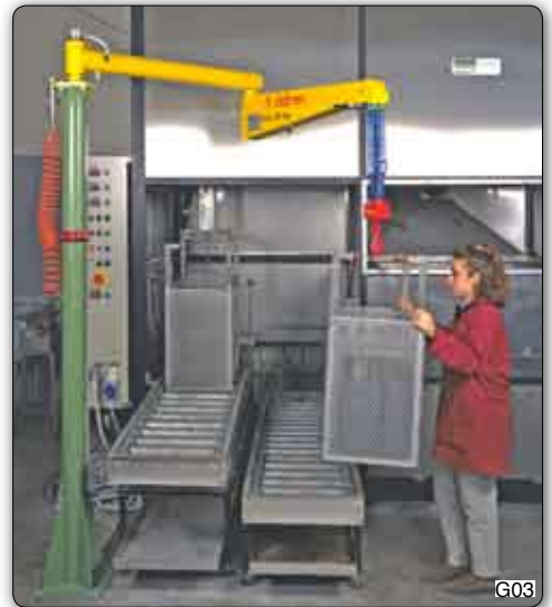
Handhabungs-Manipulator "Posivel" Typ PVC, Säulengerät für die Handhabung von Behältern an einer Waschanlage.
