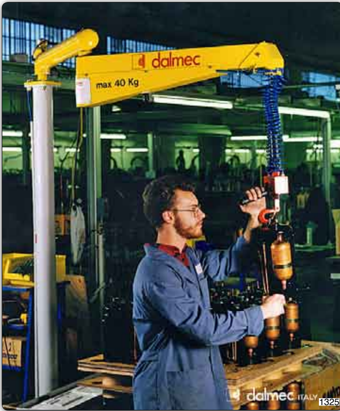
Handhabungs-Manipulator "Posivel" Typ PVC, Säulengerät für die Handhabung von Kühlern für Klimatisatoren.
