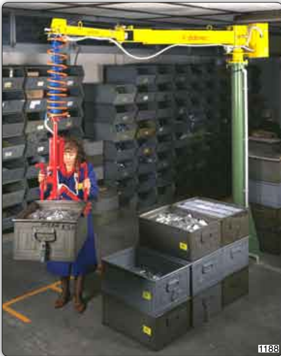
Handhabungs-Manipulator "Posifil" Typ PFC, Säulengerät mit einer gabelförmig Greifereinheit zum Aufnehmen der Kästen an den Längsseiten.
