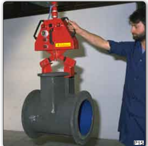
Handhabungs-Manipulator mit pneumatischer Greifvorrichtung für Absperrventile. Die Greiferbacken sind verstellbar, um die Aufnahme von Ventilen unterschiedlicher Größe zu ermöglichen.
