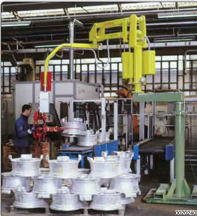
Handhabungs-Manipulator "Partner" Typ PMC, Säulengerät mit Greifvorrichtung zur Aufnahme und Handhabung von mechanischen Teilen mit unterschiedlichen Durchmessern.
