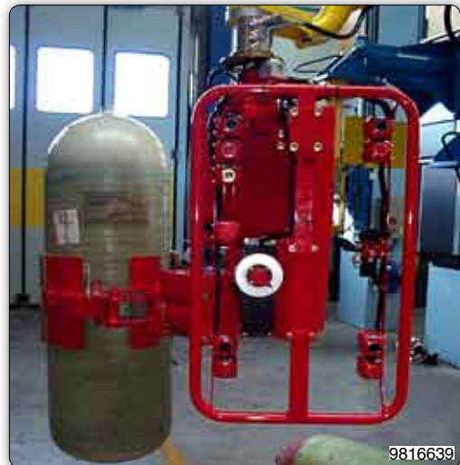
Mit dieser pneumatischen Greifvorrichtung werden die Druckbehälter aufgenommen und um 90° pneumatisch geschwenkt.
