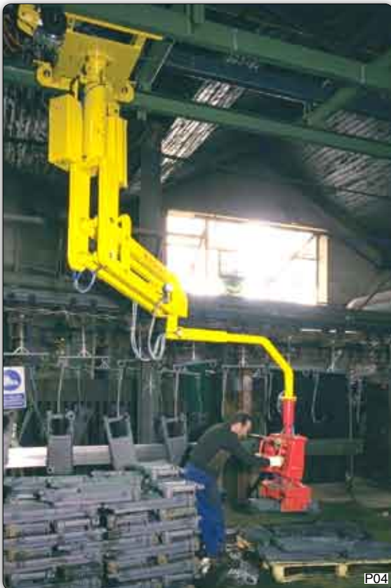
Handhabungs-Manipulator "Partner" Typ PMS, Deckengerät verfahrbar, mit pneumatischer Greifvorrichtung zur Aufnahme von Gussteilen. Die Teile werden aus einem Kettenförderer entnommen, um 90° pneumatisch geschwenkt und auf Palette abgelegt. Befestigungseinheiten und Laufschienen aus dem Dalmecc Lieferprogramm.
