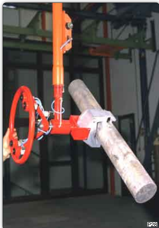
Pneumatische Greifvorrichtung zum Handhaben von Alu-Rohlingen. Die Vorrichtung ist manuell drehbar um 180°.
