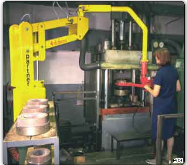
Handhabungs-Manipulator "Partner" Typ PMC, Säulengerät mit verkürzter Säuleneinheit speziell für den Einsatz in niedrigen Räumen konzipiert. Hier werden Kollektoren in eine Presse eingelegt. Die Greifeinheit ermöglicht, die Produkte in versetzter Lage zur vertikalen Drehachse der Greifvorrichtung zu handhaben.
