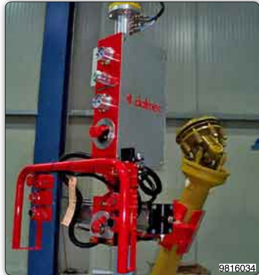
Handhabungs-Manipulator mit pneumatischer Greifvorrichtung zur Aufnahme und Drehung von Getriebewellen.
