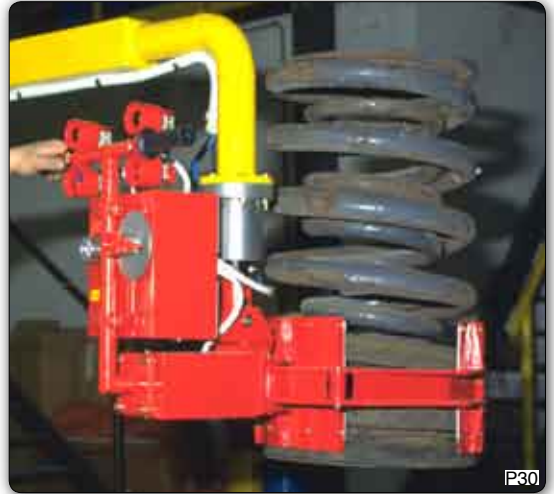
Handhabungs-Manipulator mit Greifvorrichtung zur Aufnahme der Federung eines Eisenbahnwagens und Ablage auf einer Kontrollmaschine.
