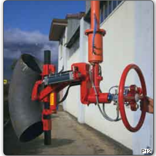
Handhabungs-Manipulator mit einer Vorrichtung mit pneumatischen Greiferbacken zur Aufnahme von Rohrbögen. Pneumatische Schwenkung um 90° und manuelle Drehung um 180°.
