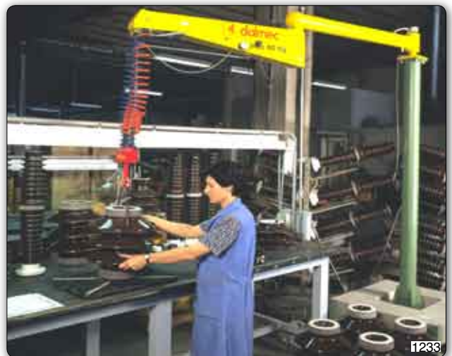
Ein müheloses Umsetzen der Isolatoren ermöglicht dieser Handhabungs-Manipulator "Posivel" Typ PVC. Das Säulengerät ist mit einem Ladegeschirr ausgestattet.
