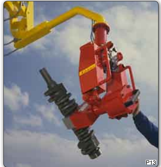
Handhabungs-Manipulator mit pneumatischer Greifvorrichtung zum Handhaben von Kurbelwellen an unterschiedlichen Arbeitsplätzen.
