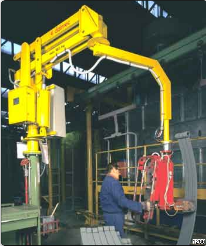
Auch Elektro-Permanent-Magneten werden in Aufnahmevorrichtungen integriert. Bei diesem Handhabungs-Manipulator "Partner" Typ PMC, Säulengerät ist eine pneumatische Schwenkung um 90 ° erforderlich. Es können pro Arbeitshub sogar zwei oder drei Bauteile umgesetzt werden.
