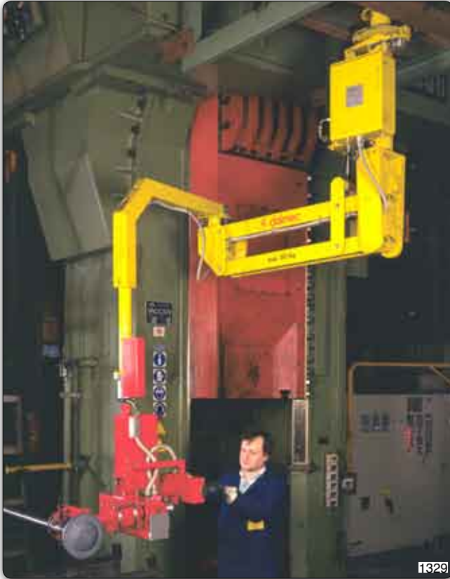
Handhabungs-Manipulator "Partner" Typ PMF, Deckengerät stationär mit pneumatischer Greifvorrichtung zur Aufnahme von Halbachsen vom Transportwagen, pneumatischen Schwenkung und Ablage in einer Gesenkpresse.
