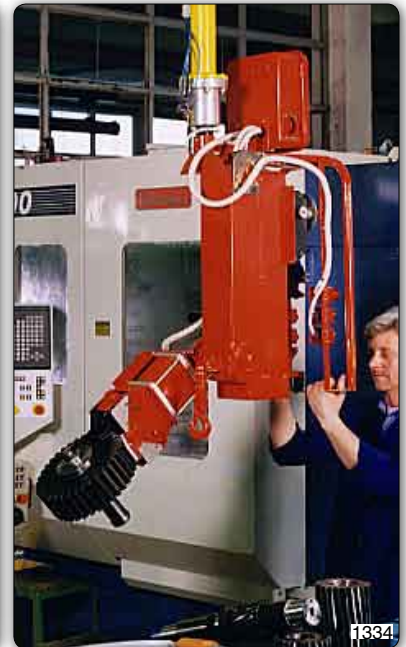
Handhabungs-Manipulator "Partner" Typ PMC, Säulengerät mit einer speziellen Greifvorrichtung zur Aufnahme, Schwenkung und Drehung von Zahnrädern.
