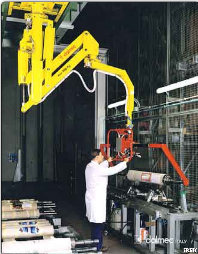
Handhabungs-Manipulator "Partner" Typ PMS, Deckengerät verfahrbar für die Aufnahme von Druckwalzen. Die Aufnahmevorrichtung besteht aus zwei Bügeln mit speziell ausgeformten Buchsen. Die Druckwalzen werden von Palette aufgenommen und auf einem Halter im automatischen Lager abgelegt.
