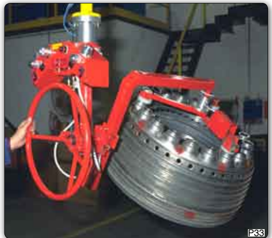
Diese Greifvorrichtung zum Handhaben von Auspuffingen von Flugzeugmotoren dient zur Beschickung einer Schweißanlage. Die manuelle Schwenkung der Auspuffringe erfolgt durch ein spezielles Lenkrad.
