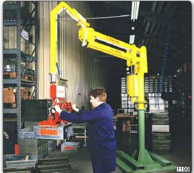
Handhabungs-Manipulator "Partner" Typ PMC, Säulengerät mit pneumatischer Greifvorrichtung zur Aufnahme von Behältern.
