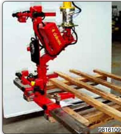
Einstellbare Gabelvorrichtung mit Sperre.
