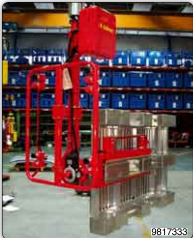
Spezielle Gabelvorrichtung für die Aufnahme und Handhabung der Paletten aus Edelstahl.
