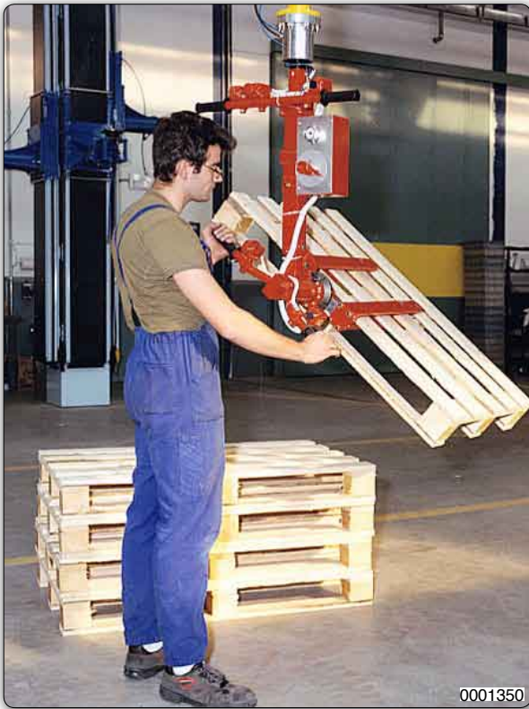
Handhabungs-Manipulator mit Gabelvorrichtung mit manueller Drehung um 180° der Paletten.
