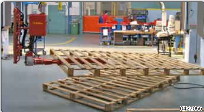
Handhabungs-Manipulator mit Greifvorrichtung zur Aufnahme und pneumatischer Drehung von speziellen Paletten.
