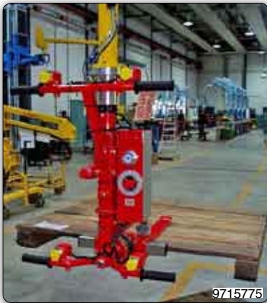
Gabelvorrichtung mit manueller Drehung der Last.
