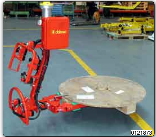
Handhabungs-Manipulator mit Greifvorrichtung und manueller Drehung von speziellen Paletten.
