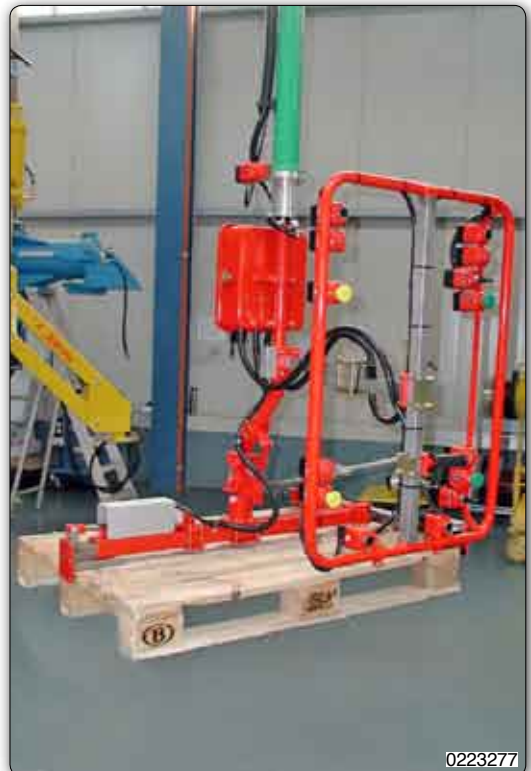
Handhabungs-Manipulator mit Greifvorrichtung zur Aufnahme und Handhabung von Paletten.
