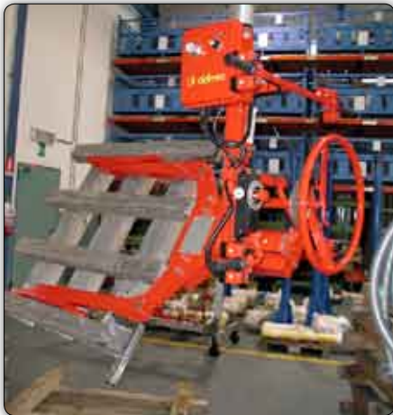
Spezielle Gabelvorrichtung für die Aufnahme und Handhabung der Paletten aus Edelstahl.
