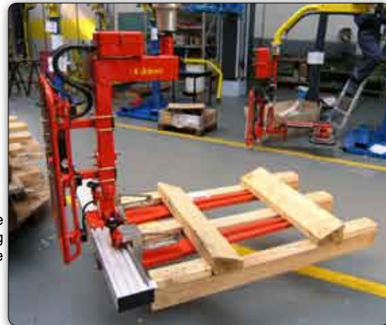
Einstellbare Gabelvorrichtung mit pneumatischer Drehung der Last und teleskopierbaren Bedienelementen.
