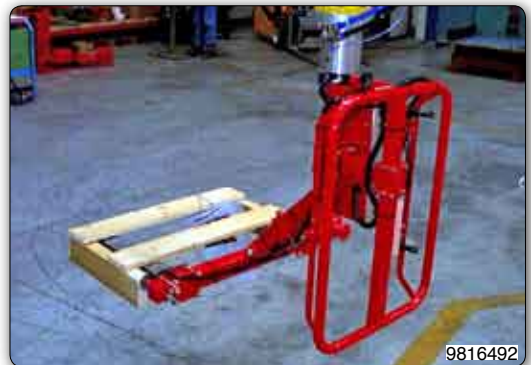
Handhabungs-Manipulator mit Gabelvorrichtung und Sensor für die Produkterkennung zur Handhabung von Paletten.
