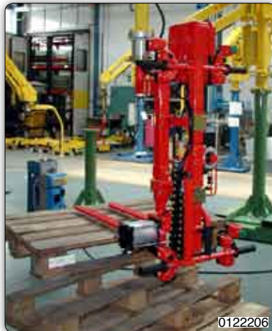
Einstellbare Gabelvorrichtung mit pneumatischer Drehung der Last und teleskopierbaren Bedienelementen.
