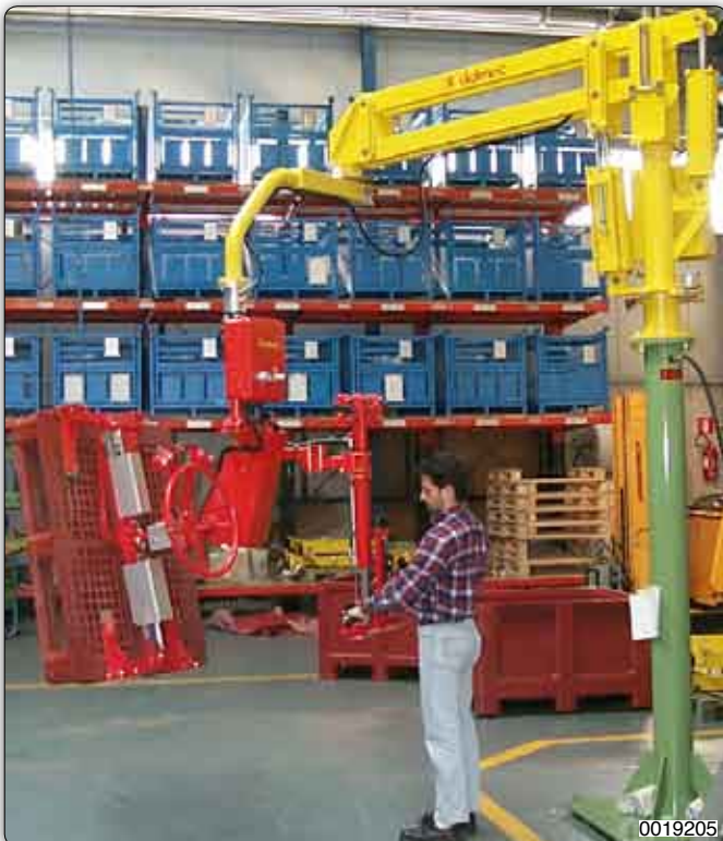
Handhabungs-Manipulator Typ PMC, Säulengerät mit Greifvorrichtung zur Aufnahme, pneumatischen Schwenkung und manuellen Drehung von Plastikpaletten.
