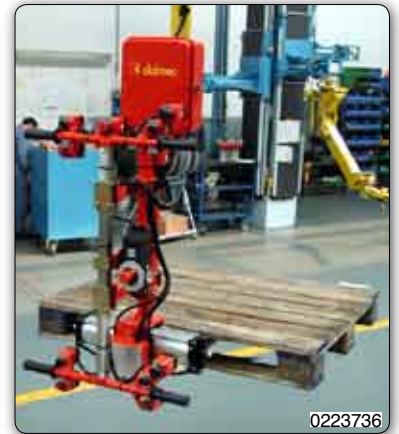
Gabelvorrichtung mit pneumatischer Drehung der Last.
