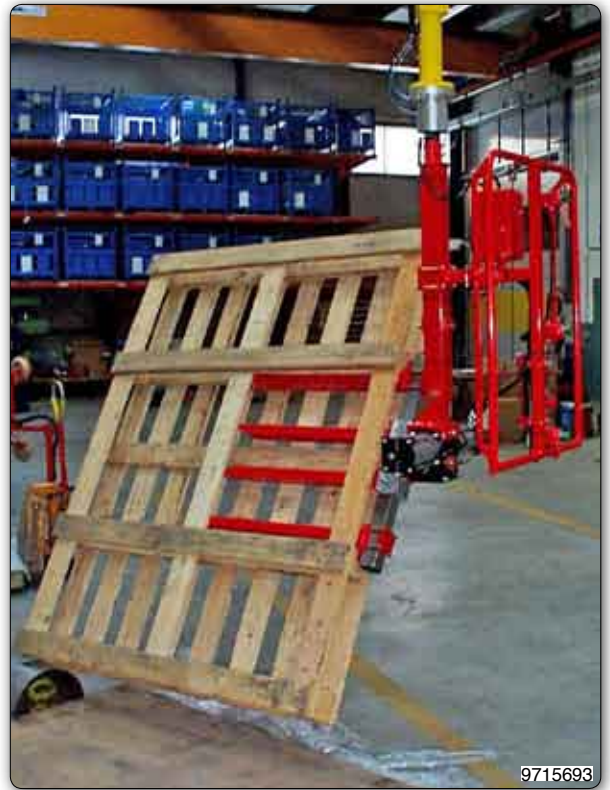
Handhabungs-Manipulator mit Gabelvorrichtung mit pneumatischer Drehung um 180° zur Aufnahme und zum Drehen der Paletten.
