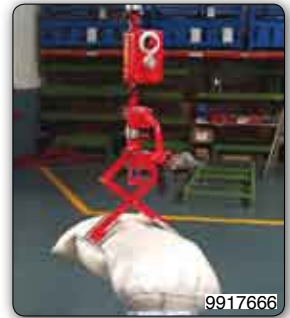
Handhabungs-Manipulator "Partner" Typ PSC, Säulengerät mit Saugvorrichtung zum Umsetzen der Säcke von der Palette auf die Mischeinrichtung.
