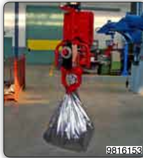
Bis ca. 2 m hoch lassen sich Säcke mit diesem Handhabungs-Manipulator "Partner" Typ PSC, Säulengerät, palettieren bzw. depalettieren.
