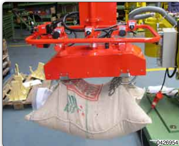
Handhabungs-Manipulator mit Greifvorrichtung bestehend aus einziehbaren Haken für die Aufnahme von Jute-Säcken.
