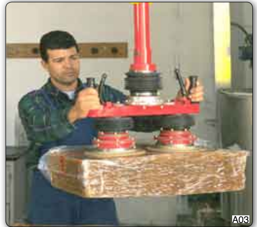
Diese Saugvorrichtung für Kautschukballen besteht aus zwei gelenkigen, unabhängigen Saugern.
