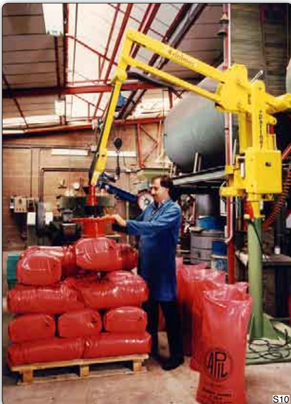
Handhabungs-Manipulator "Partner" Typ PSC, Säulengerät zum Umsetzen der Säcke von der Sackfüllmaschine auf die Palette.
