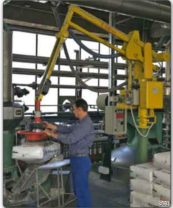
Handhabungs-Manipulator "Partner" Typ PSC, Säulengerät mit Saugvorrichtung zum Umsetzen der Säcke von der Palette auf die Mischeinrichtung.
