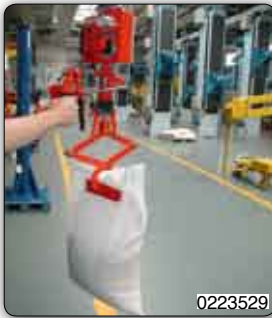
Bis ca. 2 m hoch lassen sich Säcke mit diesem Handhabungs-Manipulator "Partner" Typ PSC, Säulengerät, palettieren bzw. depalettieren.
