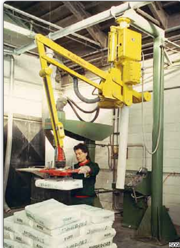
Handhabungs-Manipulator "Partner" Typ PSF, Deckengerät stationär zum Umsetzen der Säcke von der Sackfüllmaschine auf die Palette.
