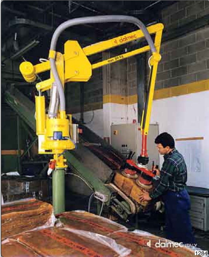
Handhabungs-Manipulator "Partner" Typ PSC, Säulengerät mit Saugvorrichtung für die Beschickung einer Zerkleinerungsmaschine mit Kautschukballen. Die "Extra Hub" Einrichtung ermöglicht ein einfaches Lösen des oberen von dem unteren Kautschukballen.
