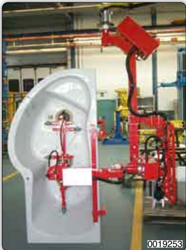
Handhabungs-Manipulator (Venturi) zur Aufnahme und Drehung von Badewannen.
