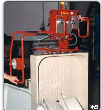
Handhabungs-Manipulator Typ PMF, Deckengerät, mit Saugvorrichtung (Venturi) zur Aufnahme und manuellen Drehung von Duschplatten.
