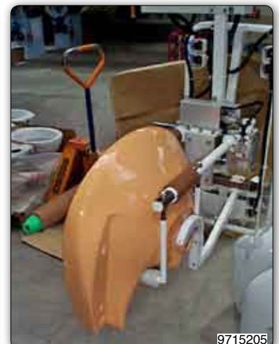
Handhabungs-Manipulator mit einstellbarer Gabelvorrichtung zur Aufnahme und Handhabung von Waschbecken.
