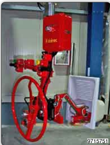
Handhabungs-Manipulator mit Saugvorrichtung (Venturi) zur Aufnahme und manuellen Drehung von Waschbecken.
