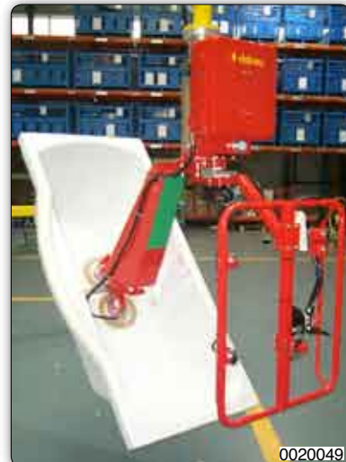
Handhabungs-Manipulator mit Saugvorrichtung (Venturi) zur Aufnahme und Schwenkung von Badewannen.
