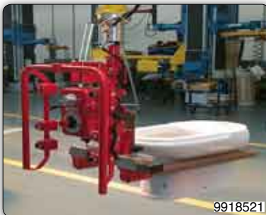
Einstellbare Gabelvorrichtung zur Handhabung der WC.
