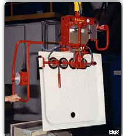
Handhabungs-Manipulator mit Saugvorrichtung (Venturi) zur Aufnahme der Duschplatten.
