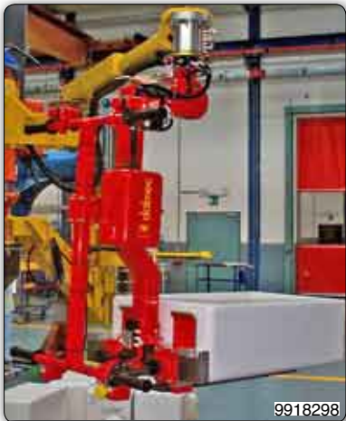
Handhabungs-Manipulator mit einstellbarer Gabelvorrichtung zur Handhabung von Spülbecken.
