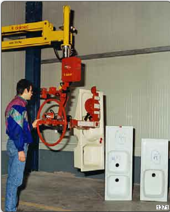
Handhabungs-Manipulator "Partner" Typ PMF, Deckengerät, mit wechselbarer Saugvorrichtung zur Aufnahme und Handhabung von Waschbecken mit verschiedenen Größen.
