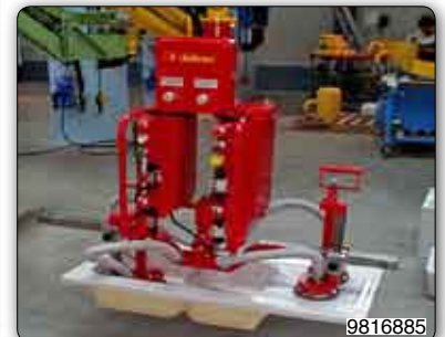
Handhabungs-Manipulator mit einstellbarer Saugvorrichtung (Venturi) zur Aufnahme und Schwenkung von Waschbecken.
