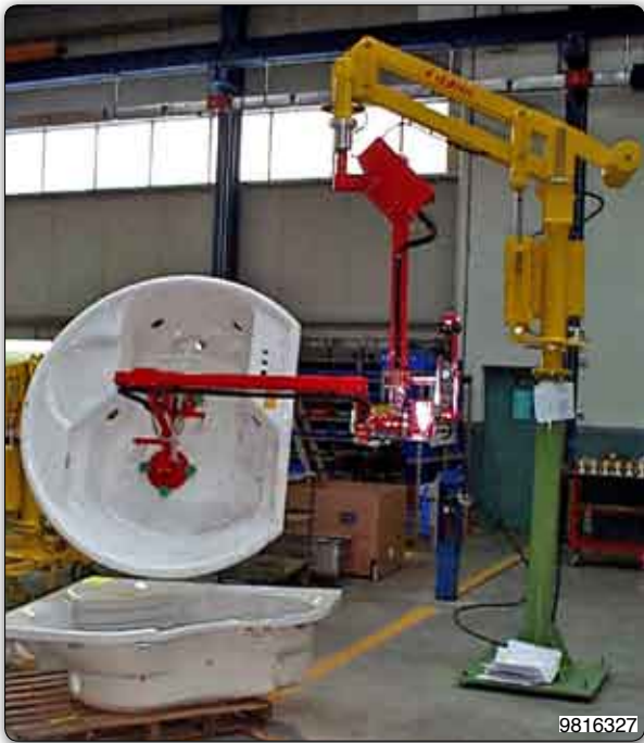
Handhabungs-Manipulator (Venturi) zur Aufnahme und Drehung von Badewannen.
