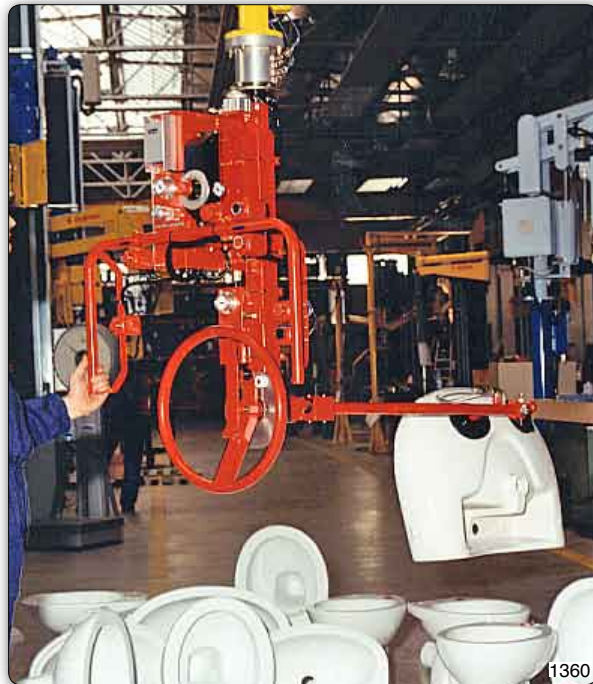
Handhabungs-Manipulator mit einstellbarer Saugvorrichtung zur Aufnahme und Handhabung von sanitären Anlagen mit manueller Drehung.
