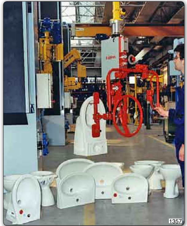
Handhabungs-Manipulator mit Saugvorrichtung zur Aufnahme und manuellen Drehung der WC.
