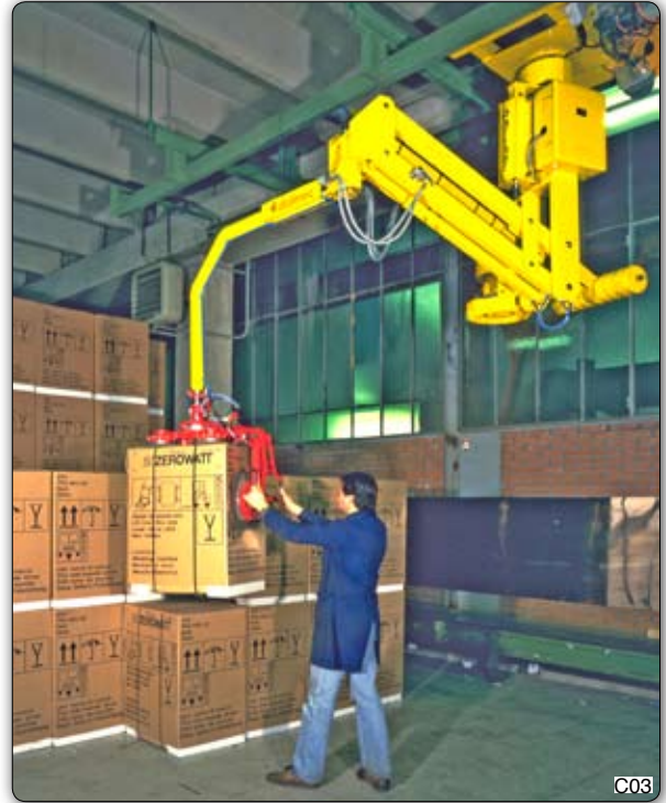
Handhabungs-Manipulator "Partner" Typ PMS, Deckengerät verfahrbar. Die Kartons mit Waschmaschinen verschiedener Modelle als Inhalt werden vom Transportband auf die Palette umgesetzt. Die Gesamtanlage, komplett mit pneumatischer Antriebseinheit, wurde von Dalmec geplant und realisiert.
