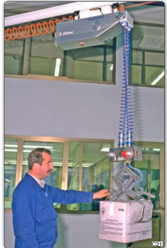
Butter-Riegel ohne Innenverpackung sind in diesem Karton. Wenn Sie die Eigenschaft von Butter bei unterschiedlichen Temperaturen berücksichtigen, wird es klar, dass Greifvorrichtung (aus Stahl) und Druckregler sensibel auf die Konsistenz des Inhalts reagieren müssen. Das alles geschieht mit einem Handhabungs-Manipulator "Minipartner" Typ MPS. Ausgerüstet ist das Säulengerät mit einer Hängeschiene.
