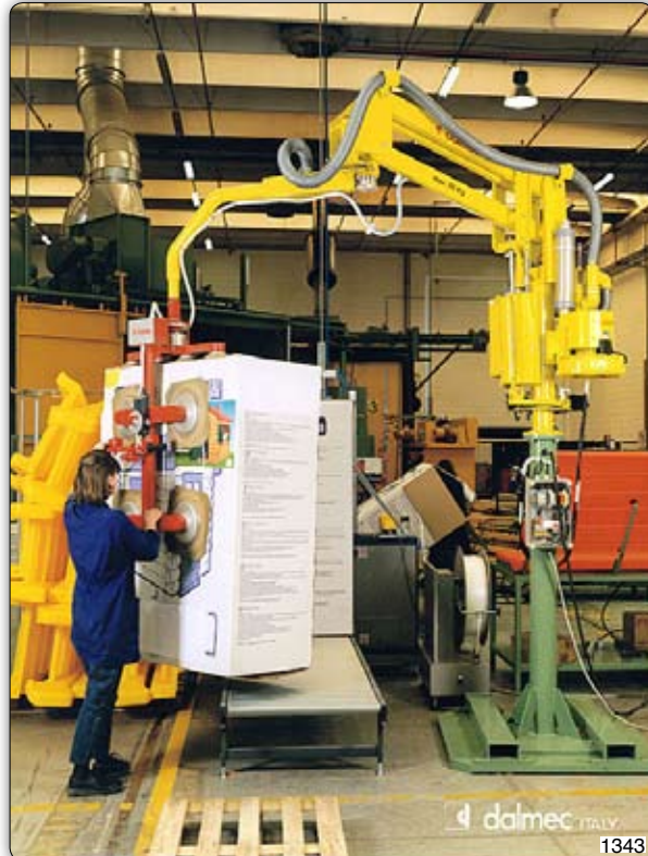
Dieses Säulengerät lässt sich mit dem Gabelstapler an den jeweiligen Einsatzort bringen. Mit der Saugplatte am Handhabungs-Manipulator "Partner" Typ PMC holt die Bedienerin Kartons vom Förderband und setzt sie auf Paletten ab.
