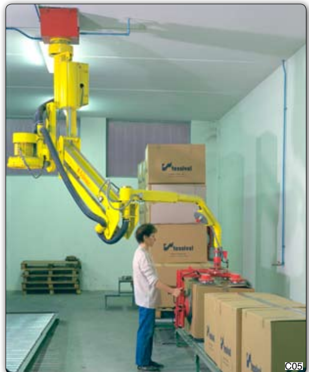
Handhabungs-Manipulator "Partner" Typ PMF, Deckengerät stationär mit Saugvorrichtung zum Umsetzen von Kartons vom Laufband auf die Palette.
