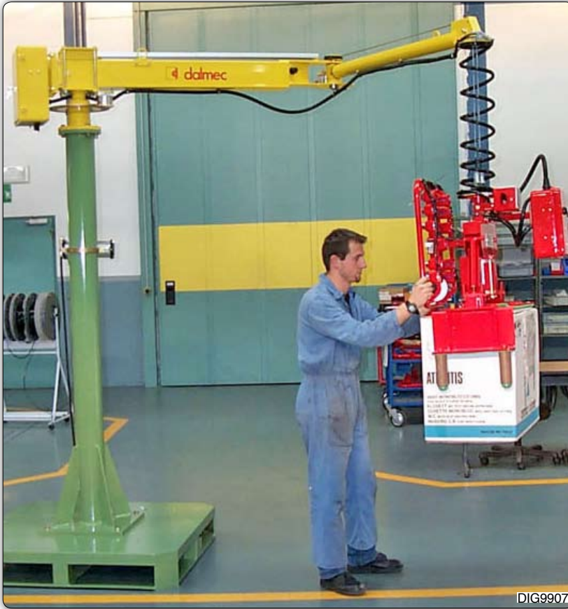
Handhabungs-Manipulator "Posifil" Typ PFC, Säulengerät mit Greifvorrichtung. Dieser Greifer ermöglicht das Aufnehmen und Einpacken von Sanitärartikeln. Anschließend werden die verschlossenen Kartons aufgenommen und palettiert.
