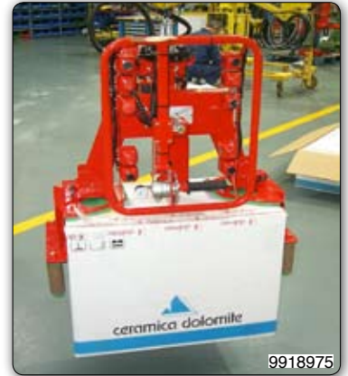
Handhabungs-Manipulator "Posifil" Typ PFC, Säulengerät mit Greifvorrichtung. Dieser Greifer ermöglicht das Aufnehmen und Einpacken von Sanitärartikeln. Anschließend werden die verschlossenen Kartons aufgenommen und palettiert.
