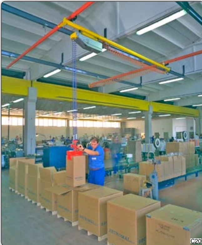
Handhabungs-Manipulator "Minipartner" Typ MPS, Deckengerät an Laufbahnschienen und Laufbahnbrücke verfahrbar mit einer pneumatischen Greifvorrichtung für die Handhabung von Kartons verschiedener Größen und Gewichte. Durch eine Proportionalventil Handgriffsteuerung ist ein schneller und einfacher Lastgewichtsausgleich möglich. Laufbahnschienen und Laufbahnbrücke sind von Dalmecc.
