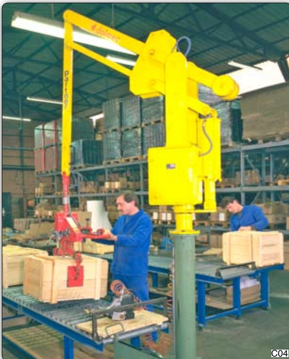
Handhabungs-Manipulator "Partner" Typ PSC, Säulengerät mit pneumatischer Greifvorrichtung. Die speziell ausgeformten Greiferbacken ermöglichen dem Bediener das Umsetzen einer besonders großen Palette von Holzkisten.
