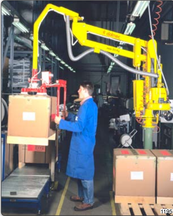
Handhabungs-Manipulator "Partner" Typ PMC, Säulengerät mit Saugvorrichtung für die Aufnahme von Kartons. Die verkürzte Säuleneinheit gewährleistet den Einsatz in einem niedrigen Arbeitsraum.
