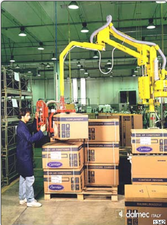
Handhabungs-Manipulator "Partner" Typ PMC, Säulengerät mit Saugvorrichtung zum Umsetzen von Kartons vom Transportband auf die Paletten.
