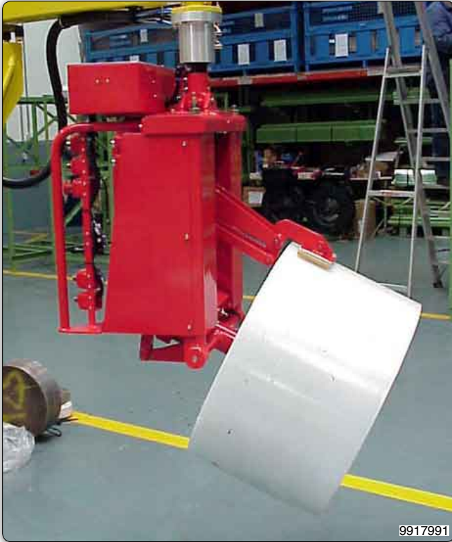
Handhabungs-Manipulator mit Innenspreizvorrichtung und Antiteleskopiereinheit. Die Spulen werden im Innendurchmesser aufgenommen und pneumatisch um 90° geschwenkt.
