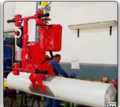
Handhabungs-Manipulator mit pneumatischer Greifvorrichtung zum Aufnehmen von Rollen am Außendurchmesser. Die speziell ausgeformten Greifer erleichtern die Aufnahme der gestapelten Rollen.
