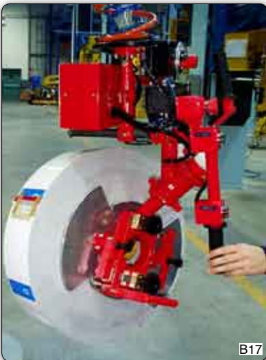
Handhabungs-Manipulator mit Saugvorrichtung "Venturi" für die Aufnahme und manuelle Schwenkung der Spulen von der Horizontalen in die Vertikale.
