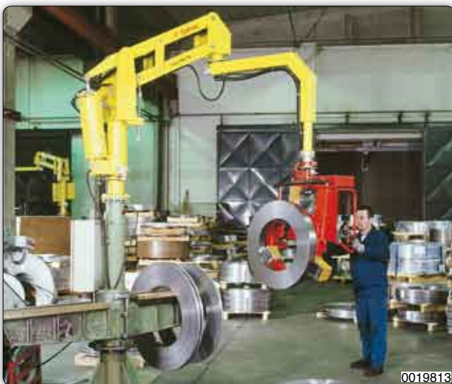
Handhabungs-Manipulator "Partner" Typ PMC, Säulengerät, mit Magnetvorrichtung zur Aufnahme und Schwenkung um 90° von Stahlbandrollen.
