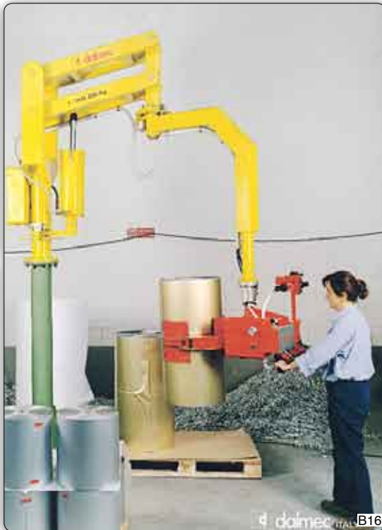
Handhabungs-Manipulator "Partner" Typ PMC, Säulengerät mit Greifvorrichtung für die Aufnahme der Spulen am Außendurchmesser und pneumatischer Drehung um ±90°.
