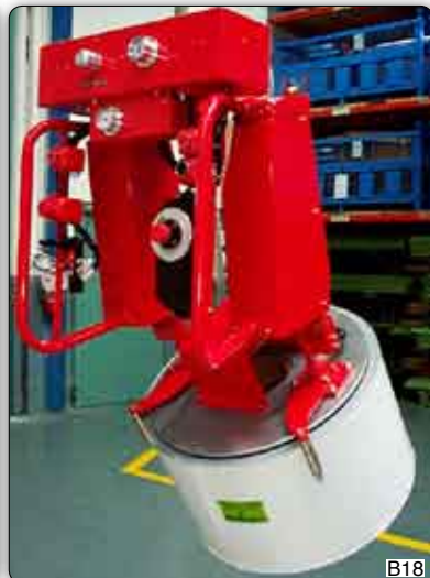
Handhabungs-Manipulator mit ringförmiger Saugvorrichtung "Venturi" für die Aufnahme und pneumatische Schwenkung der Spulen um 90°.
