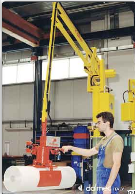
Handhabungs-Manipulator "Partner" Typ PSC, Säulengerät mit Greifvorrichtung für die Aufnahme der Rollen am Außendurchmesser.
