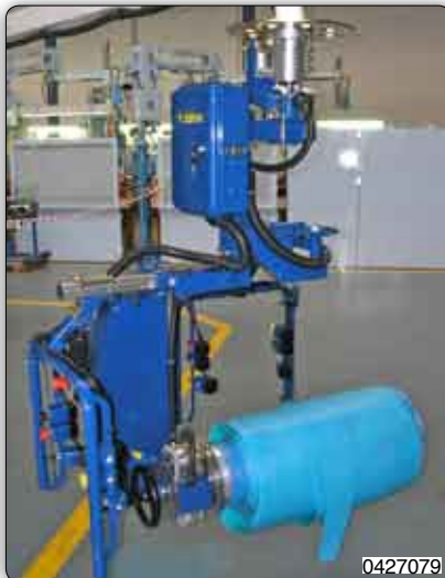
Handhabungs-Manipulator mit Spreizdorn zur Aufnahme, Schwenkung und manueller Drehung von Spulen.
