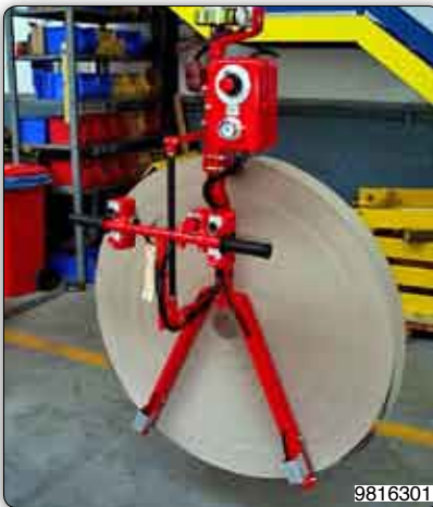
Gabelvorrichtung zur Handhabung der Spulen.
