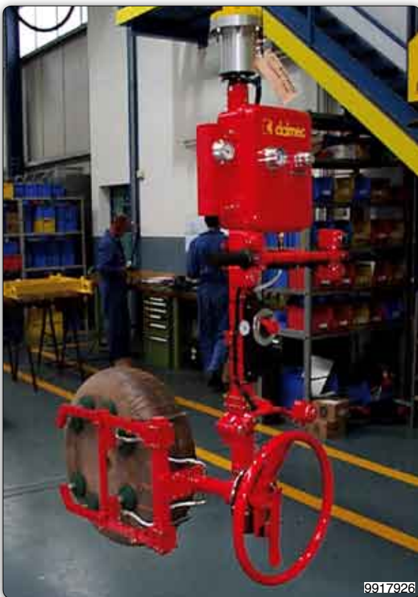
Handhabungs-Manipulator mit Saugvorrichtung (Venturi) zur Aufnahme und manuellen Drehung von Gasbehältern.
