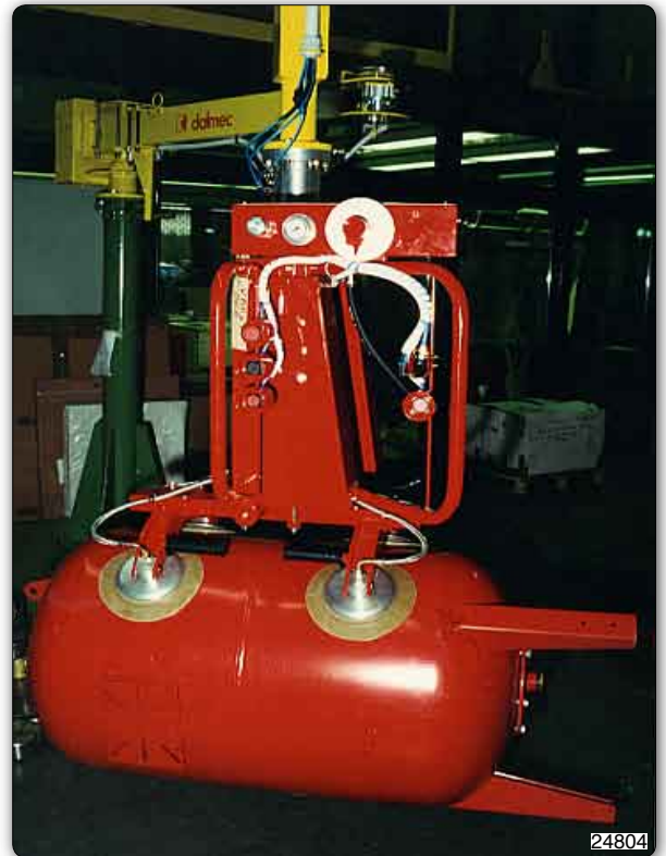
Handhabungs-Manipulator mit Saugvorrichtung (Venturi) zur Aufnahme und Schwenkung von Druckbehältern.
