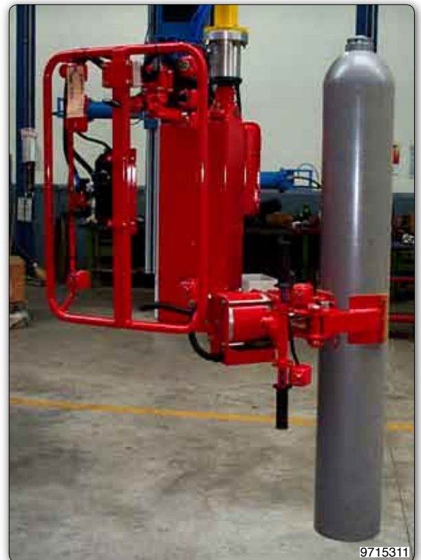
Handhabungs-Manipulator mit pneumatischer Greifvorrichtung zur Aufnahme, pneumatischen Schwenkung um 90° und manuellen Drehung um 180° von Druckbehältern unterschiedlicher Größen.
