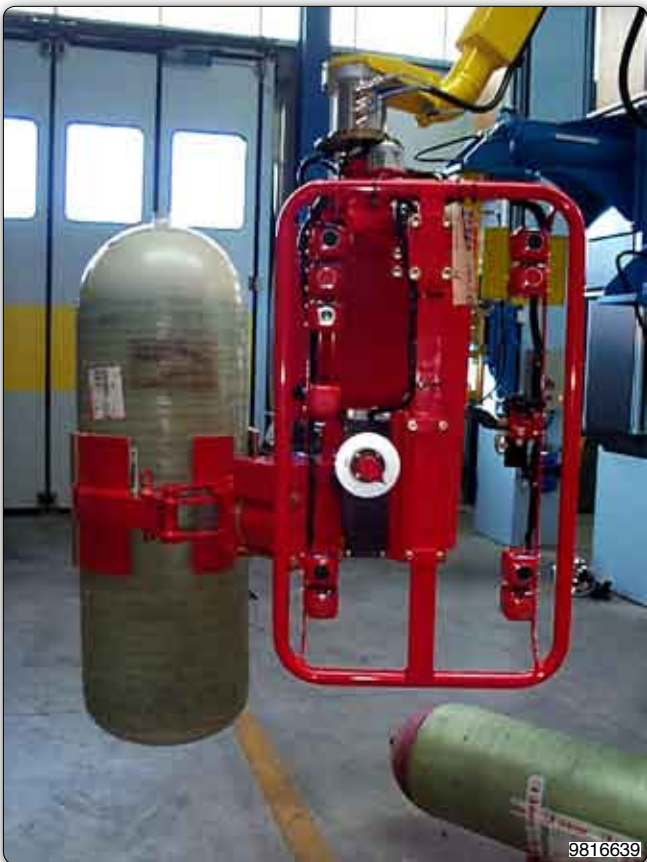
Handhabungs-Manipulator mit pneumatischer Greifvorrichtung zur Aufnahme und pneumatischen Schwenkung um 90° von Druckbehältern mit verschiedenen Größen.
