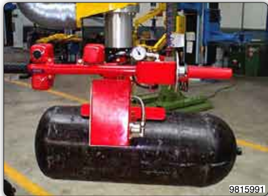
Handhabungs-Manipulator mit Saugvorrichtung (Venturi) zur Aufnahme und Abstellung von Gastanks GPL in den Fahrzeugen.
