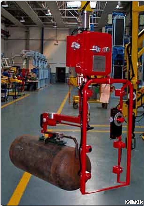
Handhabungs-Manipulator mit Saugvorrichtung (Venturi) zur Aufnahme und manuellen Drehung von Boilern.
