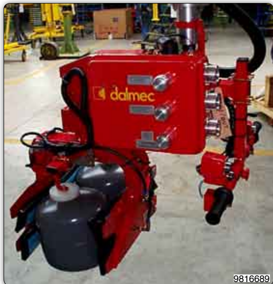
Handhabungs-Manipulator mit Aufnahmeverrichtung bestehend aus aufblasbarem Druckkissen zur Aufnahme von einem oder zwei Druckbehältern.
