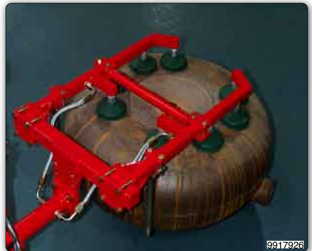
Handhabungs-Manipulator mit Saugvorrichtung (Venturi) zur Aufnahme und manuellen Drehung von Gasbehältern.
