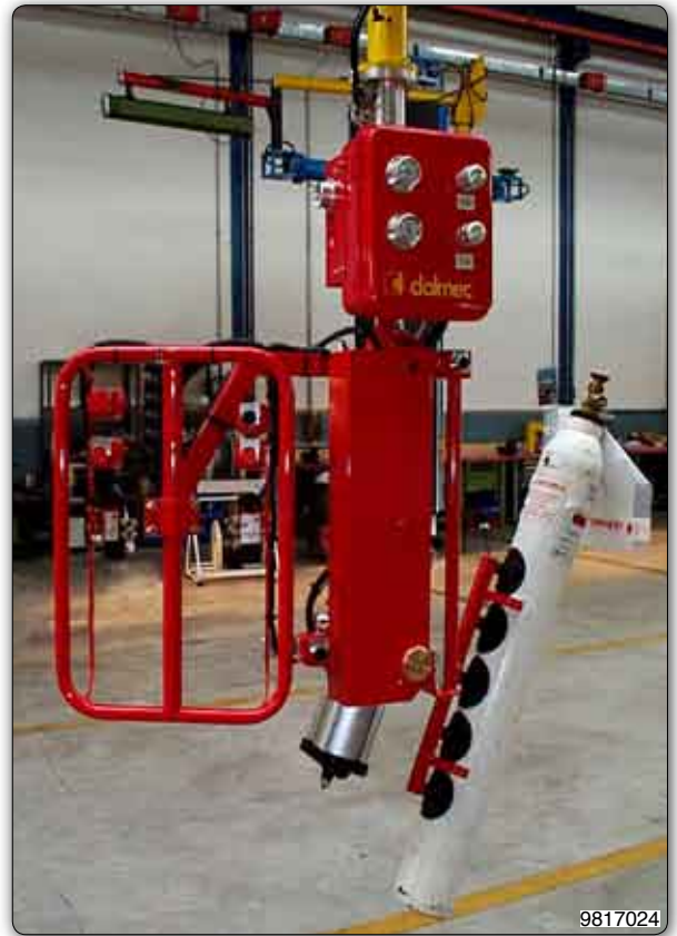
Handhabungs-Manipulator mit Saugvorrichtung (Venturi) zur Aufnahme und Schwenkung von Druckbehältern.
