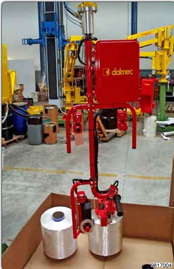
Manipulador con implemento de expansión neumática para la toma de la bobina, con rotación manual de horizontal a vertical, o viceversa.
