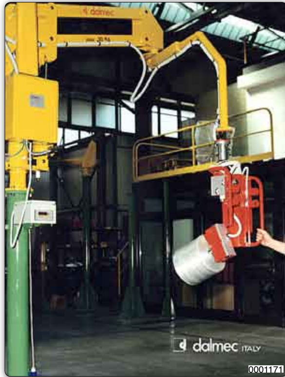
Manipulador Partner tipo PMC a columna, equipado con mandrín para toma e inclinación neumática de 90° de las bobinas. El Manipulador equipa una célula de carga para el pesaje de las bobinas en fase de equilibrio.
