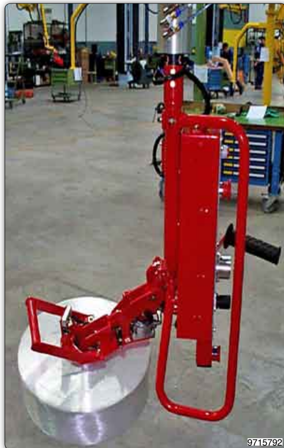
Manipulador con implemento de toma constituido por un expansor para la toma de bobinas de hilo, con rotación manual de horizontal a vertical o viceversa.
