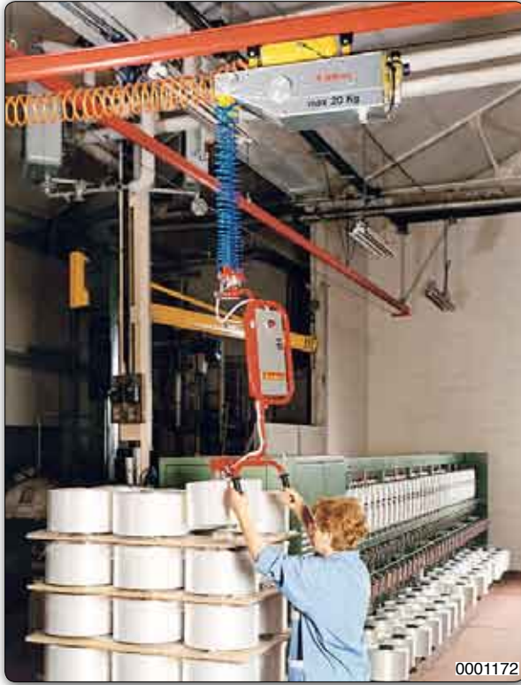
Manipulador Minipartner tipo MPS suspendido corredero en puente grúa ligero, provisto de pinza neumática para la toma y la manipulación de bobinas.
