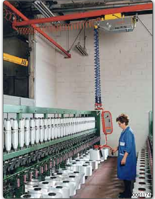
Manipulador Minipartner tipo MPS suspendido corredero en puente grúa ligero, provisto de pinza neumática para la toma y la manipulación de bobinas.
