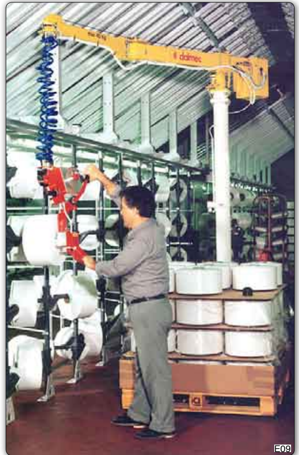
Manipulador Posifil tipo PFC a columna, con expansor para la toma de bobinas de hilo dispuestas en un palet con su eje en vertical y su posterior posicionamiento en los soportes de una desbobinadora con el eje en posición horizontal.
