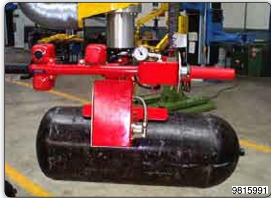
Manipulador con implemento de toma con ventosas (Venturi) realizado para la toma y el montaje de depósitos GPL en el automóvil.
