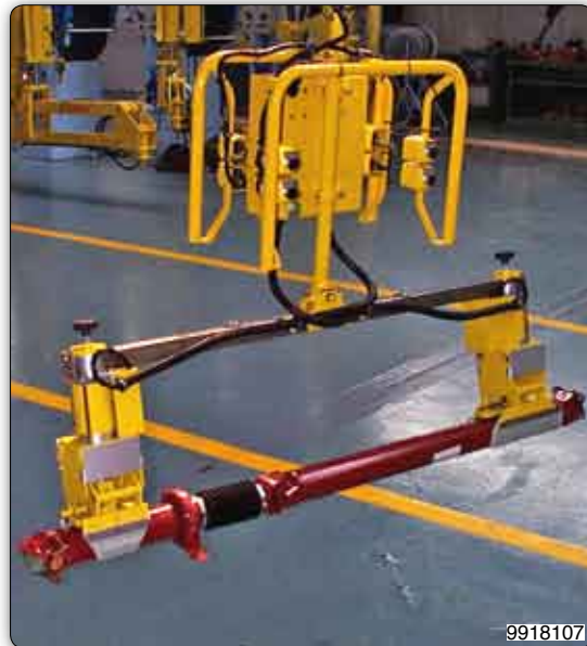
Manipulador con un implemento con doble cabezal de toma con pinzas regulables para la toma de ejes de transmisión.
