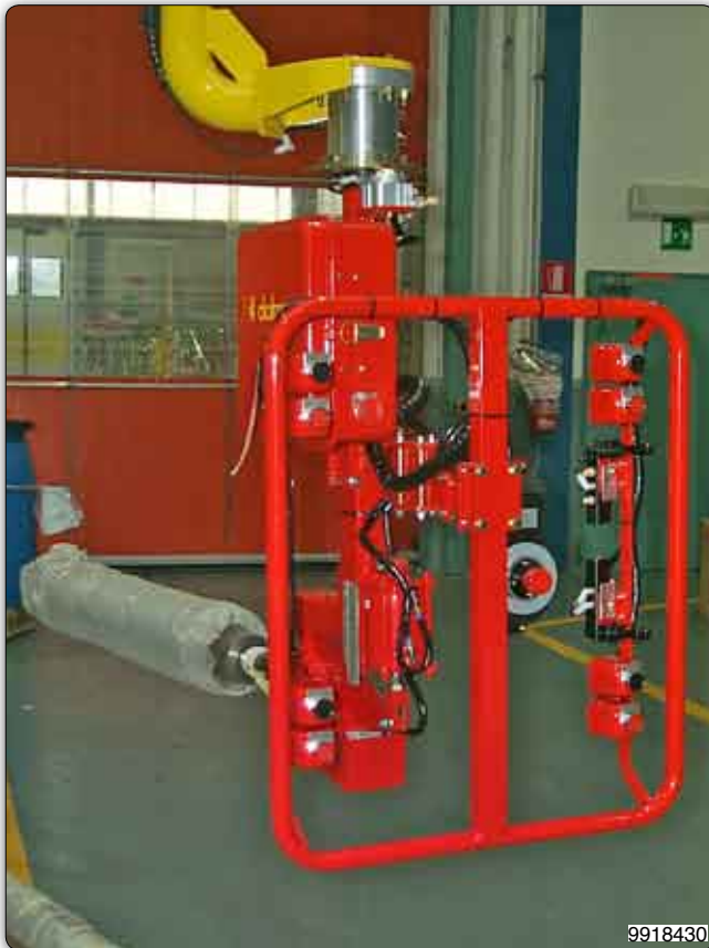
Manipulador con pinza neumática para la toma y la manipulación de ejes.
