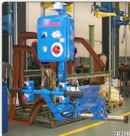
Manipulador equipado con pinza neumática realizada para la toma y la inclinación de ejes.
