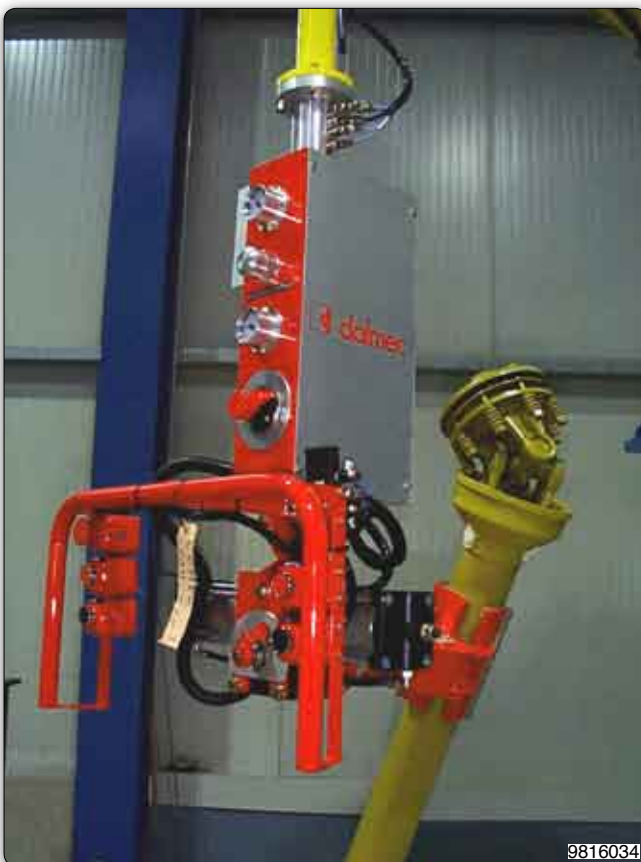
Manipulador con pinza neumática para la toma y la rotación de ejes de transmisión.
