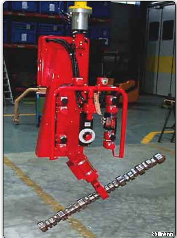
Manipulador con pinza neumática para la toma y la inclinación de ejes mecánicos.
