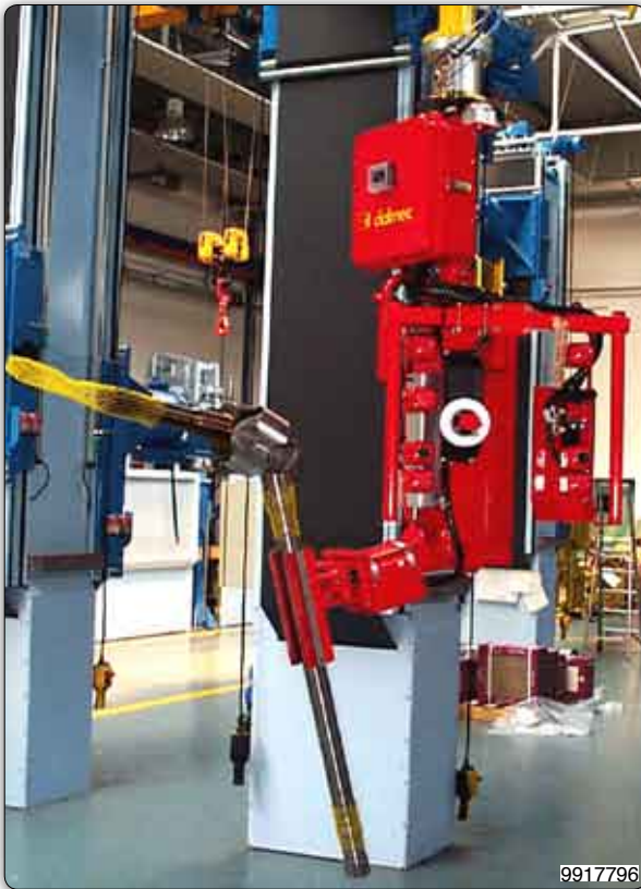
Manipulador con pinza neumática realizada para la toma, la inclinación y la rotación de ejes de trasmisión.
