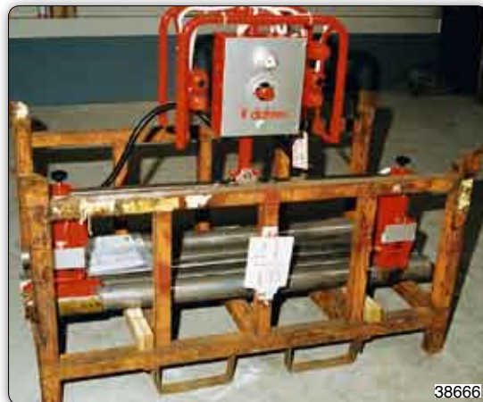
Manipulador con implemento con doble cabezal para la toma y la manipulación de ejes de transmisión.
