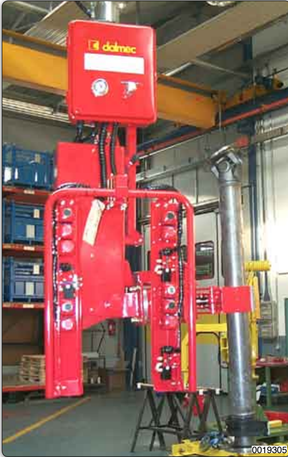
Manipolatore con attrezzo a ganasce per presa e rotazione di alberi di trasmissione.
