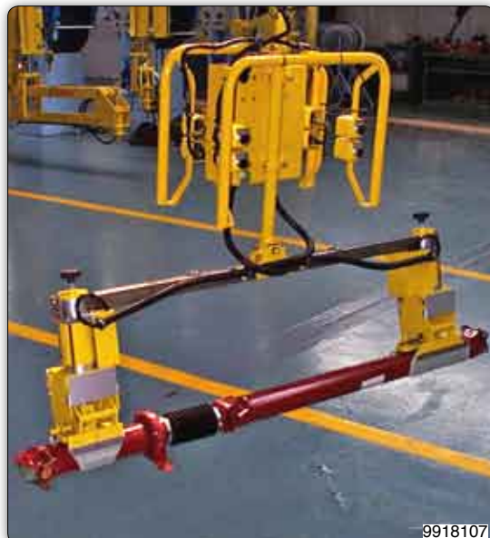
Manipolatore con attrezzo con doppia testina di presa a ganasce regolabili per presa alberi di trasmissione.
