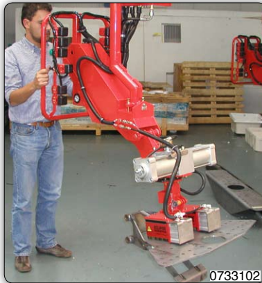
Manipolatore con attrezzo a magneti permanenti multipolari ad azionamento pneumatico, per la presa ed il sollevamento di manufatti in acciaio.
