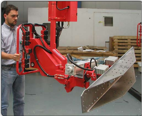
Manipolatore con attrezzo a magneti permanenti multipolari ad azionamento pneumatico, con interasse regolabile manualmente, per la presa ed il sollevamento di rotoli bandella acciaio.
