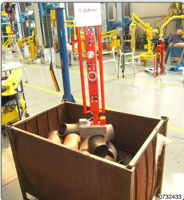
Manipolatore con attrezzo a magneti permanenti multipolari ad azionamento pneumatico, per la presa ed il sollevamento di curve in acciaio poste alla rinfusa in un cassone.
