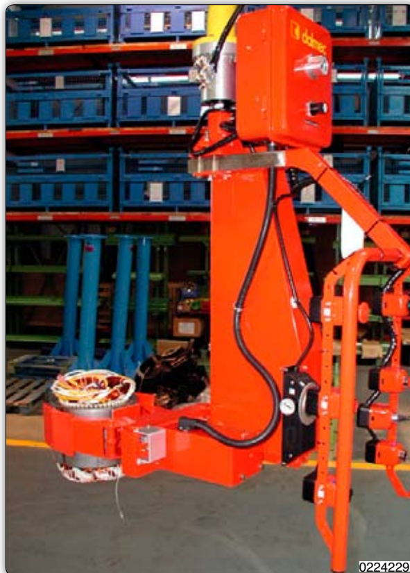
Manipolatore corredato di attrezzo a ganasce per presa sul diametro esterno di statori elettrici, idoneo al prelievo ed alla movimentazione degli elementi da una rulliera e, previa rotazione pneumatica di 90°, al deposito degli stessi su pallet.
