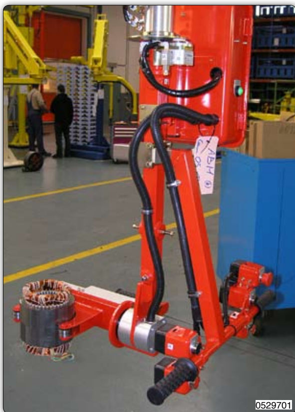
Manipolatore corredato di attrezzo a ganasce per presa sul diametro esterno di statori elettrici, con rotazione ed inclinazione manuale della statore.
