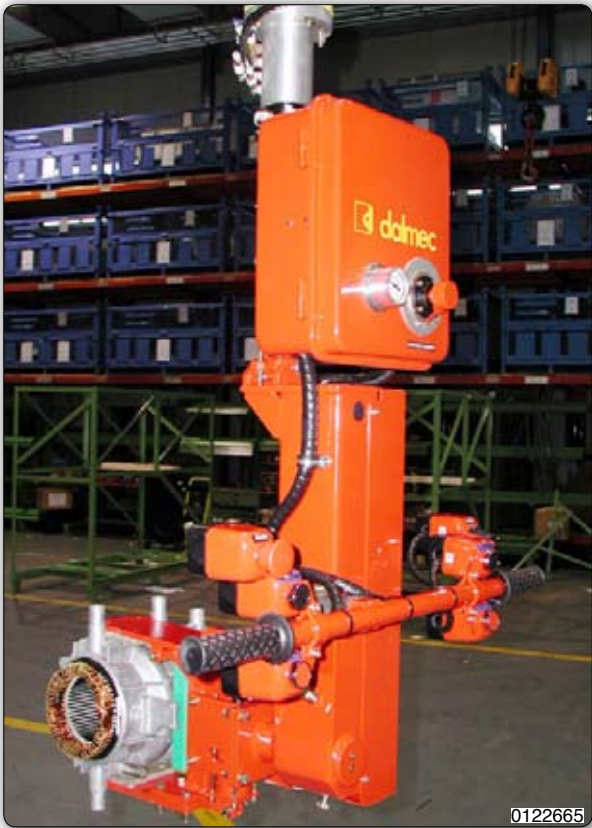
Manipolatore corredato di attrezzo a ganasce per presa sul diametro esterno di motori elettrici, completo di sistema rotazione pneumatica.
