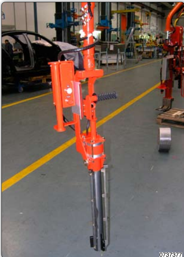
Manipolatore corredato di attrezzo a ganasce per presa pacchi lamierini.
