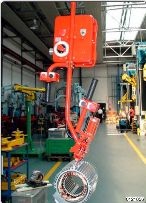
Manipolatore corredato di attrezzo a ganasce per presa e movimentazione di motori elettrici.
