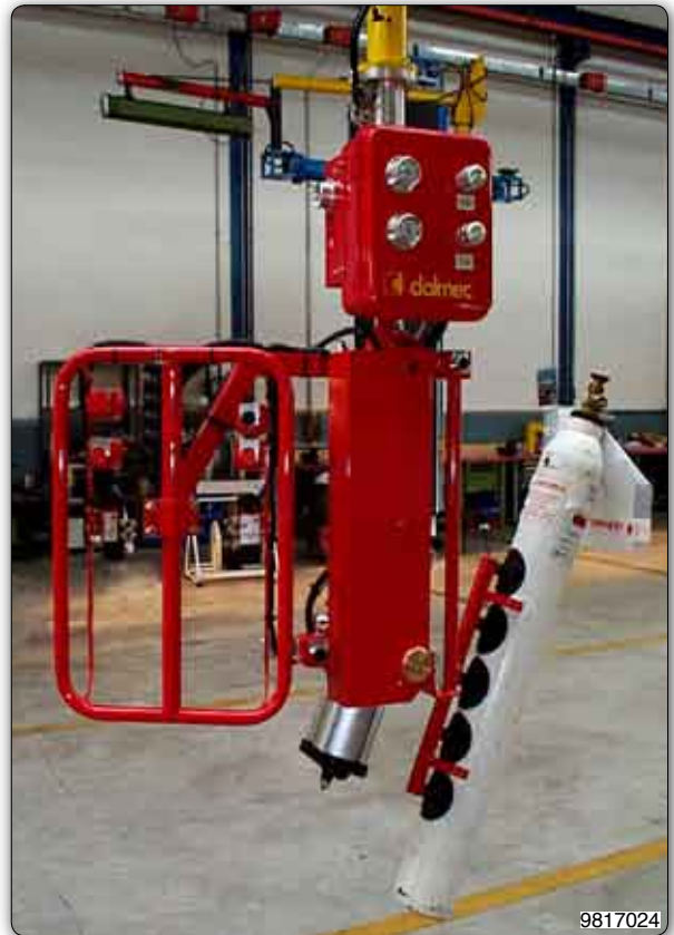
Manipolatore con attrezzo a ventosa (Venturi) per presa e inclinazione di bombole.
