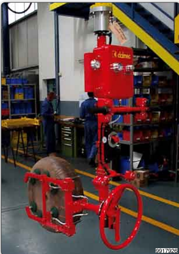
Manipolatore con attrezzo a ventosa (Venturi) per presa e rotazione manuale di serbatoi a ciambella.
