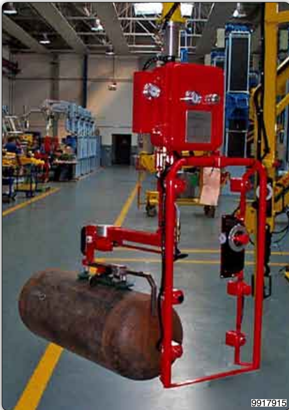
Manipolatore con attrezzo a ventosa (Venturi) per presa e rotazione manuale di serbatoi.
