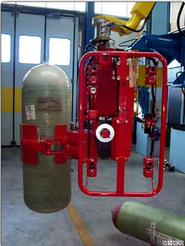
Manipolatore con pinza pneumatica per presa ed inclinazione pneumatica a 90° di bombole di varie dimensioni.
