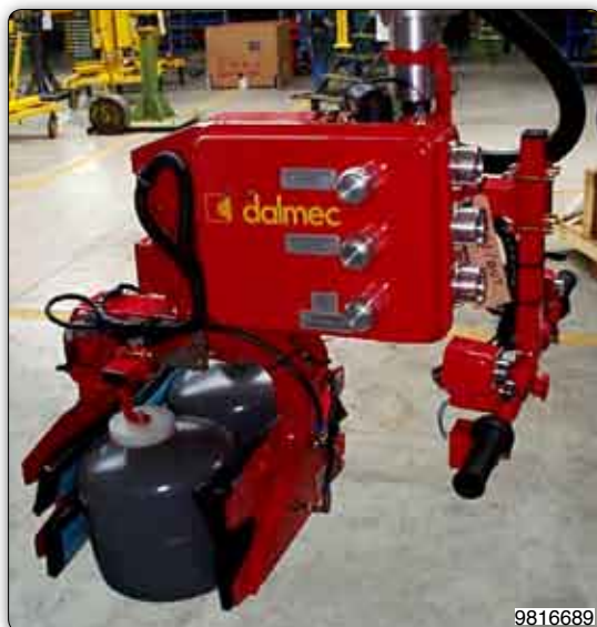
Manipolatore con attrezzo a cuscini gonfiabili per presa di una o due bombole.
