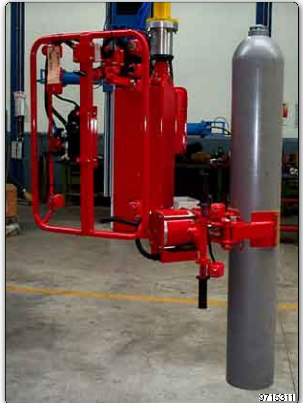
Manipolatore con pinza pneumatica per presa, inclinazione pneumatica a 90° e capovolgimento manuale a 180° di bombole di varie dimensioni.
