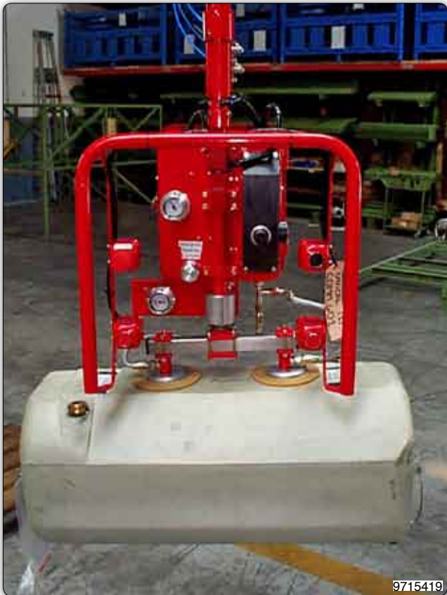
Manipolatore con attrezzo a ventose (Venturi) regolabili per presa e movimentazione di serbatoi.
