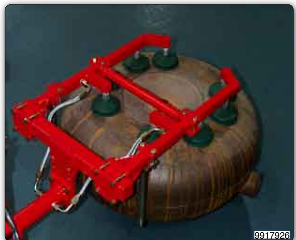
Manipolatore con attrezzo a ventosa (Venturi) per presa e rotazione manuale di serbatoi a ciambella.
