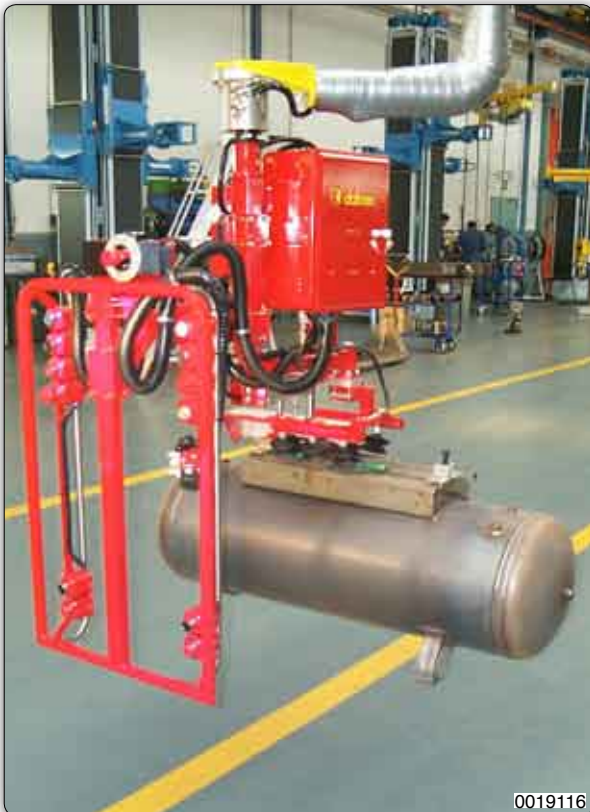
Manipolatore con attrezzo a ventose (Venturi) per presa e movimentazione di serbatoi.
