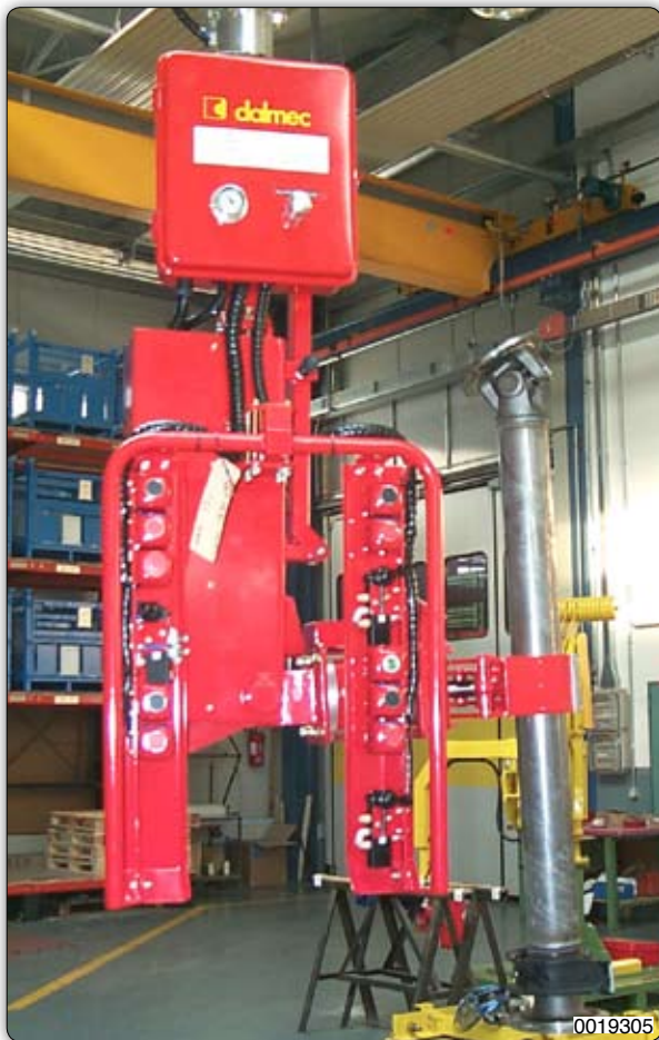
Манипулятор с зажимным вращающимся захватом для перемещения трансмиссионных валов.
