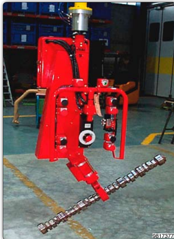
Манипулятор с пневматическими зажимами для захвата, наклона и поворота трансмиссионных валов.
