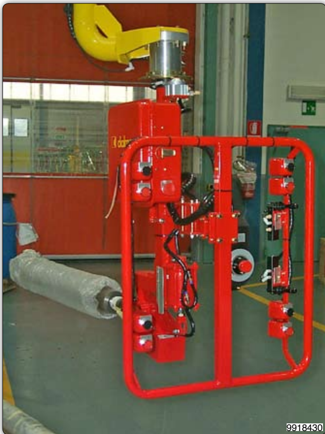
Манипулятор с пневматическими зажимами для захвата и перемещения валов.
