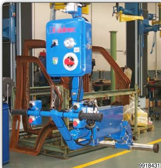
Манипулятор с пневматическим зажимным захватом для наклона и перемещения валов.
