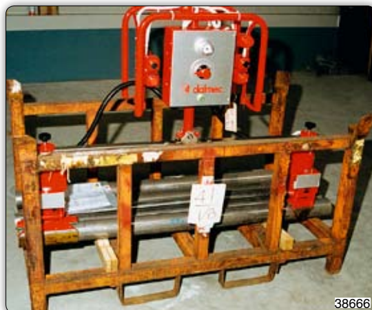
Манипулятор с двойным захватом для перемещения трансмиссионных валов.
