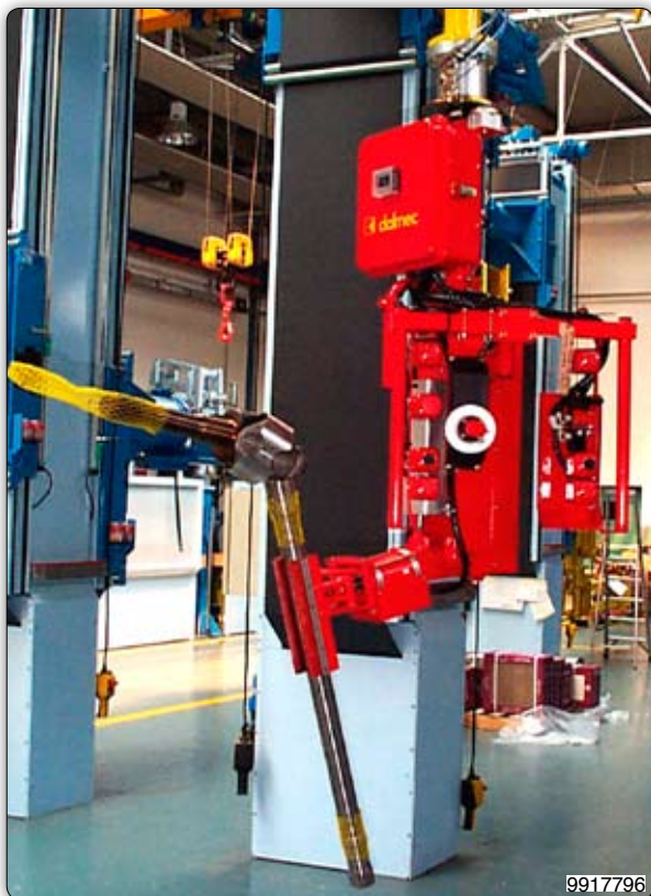
Манипулятор с пневматическими зажимами для захвата, наклона и поворота трансмиссионных валов.
