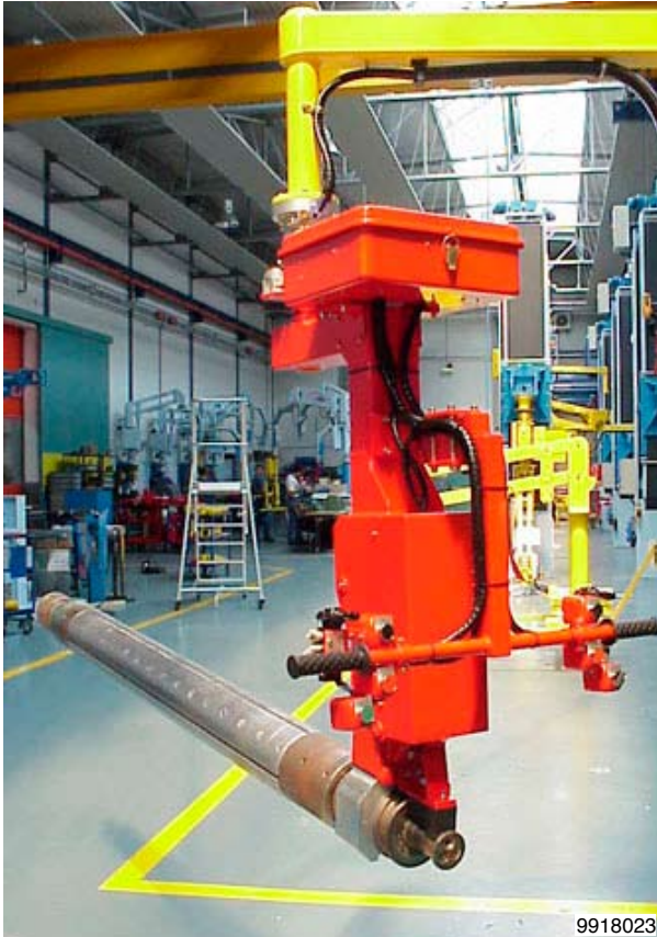
Manipolatore con attrezzo a ganasce per alberi portabobine.
