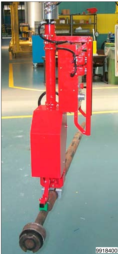
Manipolatore con pinza pneumatica per presa e movimentazione di alberi portabobine.
