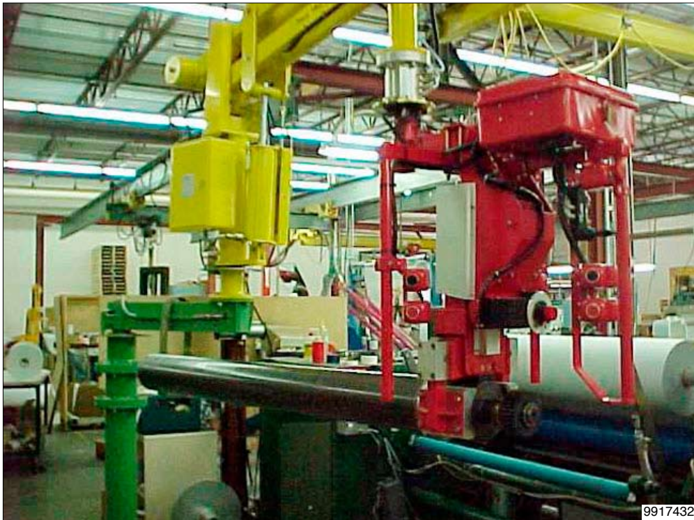
Manipolatore Partner tipo PRC, esecuzione a colonna disassata con attrezzo a ganasce per presa e movimentazione di alberi portabobine.
