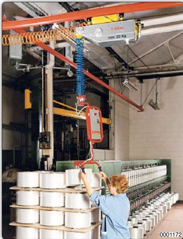
Манипулятор Minipartner типа MPS в подвесном исполнении на траверсе, оборудованный пневматическим зажимом для захвата и перемещения катушек.
