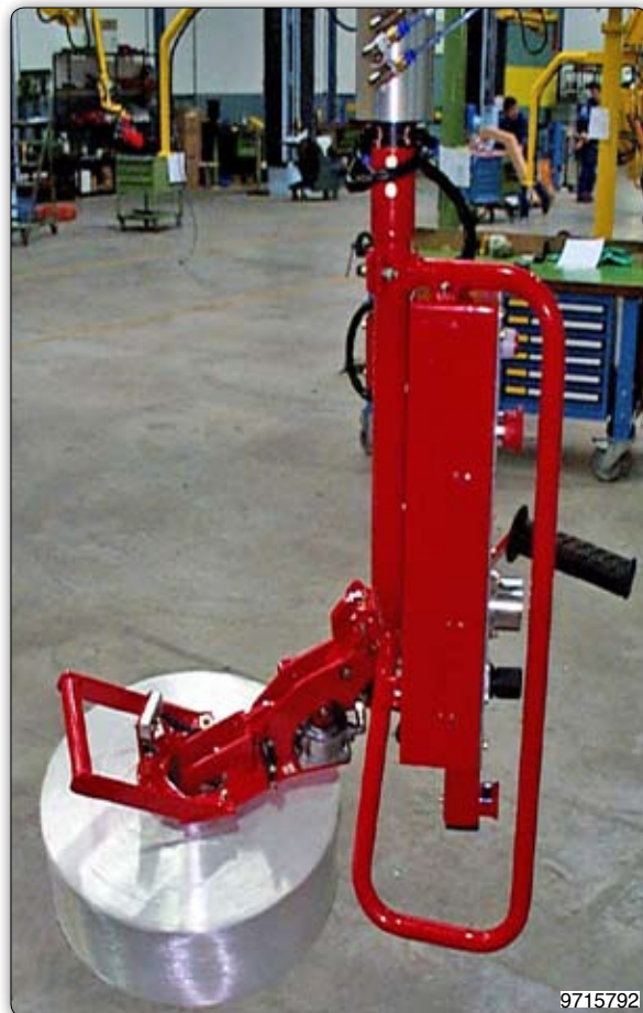
Манипулятор с приспособлением, состоящим из раздвижного патрона, предназначенным для захвата ниточных катушек с устройством ручного поворота, начиная с горизонтального положения оси перемещаемой катушки в вертикальное или наоборот.
