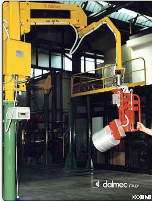
Манипулятор Partner типа РМС в исполнении на стойке оборудованный раздвижным патроном. Манипулятор позволяет осуществлять наклон катушки на 90° и оборудован мессдозой для контроля веса перемещаемой катушки.
