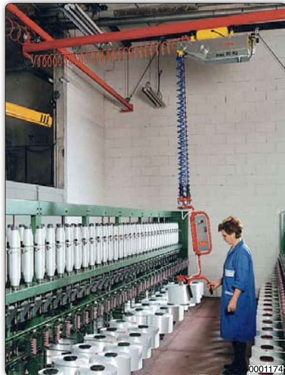
Манипулятор Minipartner типа MPS в подвесном исполнении на траверсе, оборудованный пневматическим зажимом для захвата и перемещения катушек.
