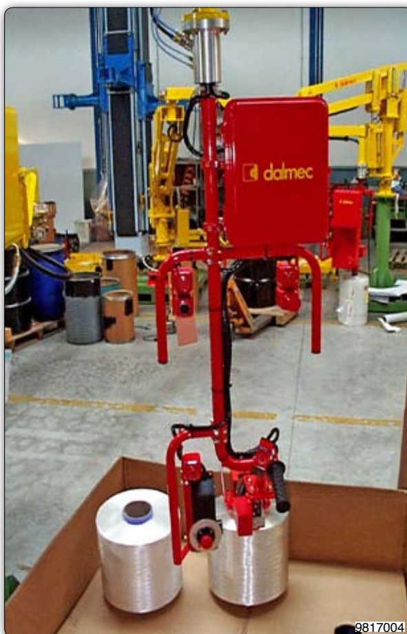
Манипулятор с раздвижным пневматическим приспособлением для захвата катушек и ручным поворотом с горизонтального положения в вертикальное или наоборот.
