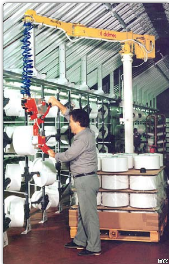
Манипулятор Posifil типа PFC в исполнении на стойке, оборудованный раздвижным патроном для захвата катушек с пряжей, расположенных на поддоне в вертикальном положении, предназначенный для их позиционирования на штырях размотки в горизонтальном положении.
