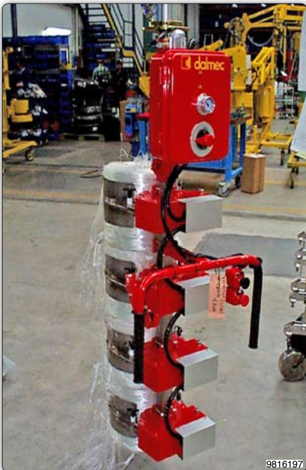
Манипулятор с зажимными приспособлением для захвата, состоящим из 4-х узлов зажимных пластин, предназначенным для одновременного захвата нескольких катушек стекловолокна.
