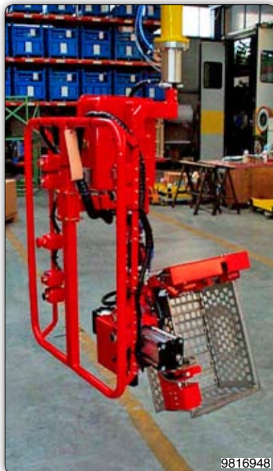
Манипулятор с пневматическим приспособлением для захвата и поворота ящиков.
