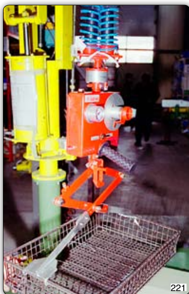
Манипулятор с ножничным приспособлением для захвата и перемещения металлических корзин.
