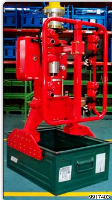
Манипулятор с пневматическим приспособлением для захвата ящиков.
