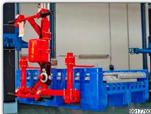
Манипулятор с вильчатым захватом, предназначенный для перемещения пластмассовых ящиков.
