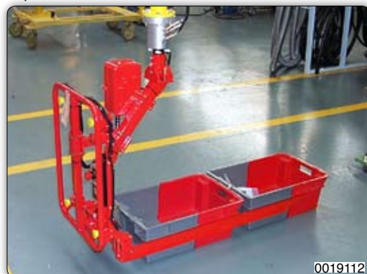
Манипулятор с вильчатым захватом для перемещения ящиков.
