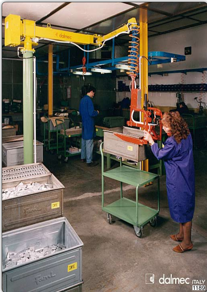
Манипулятор Fosfil типа PFC в исполнении на стойке, оборудованный вильчатым захватом для перемещения ящиков.
