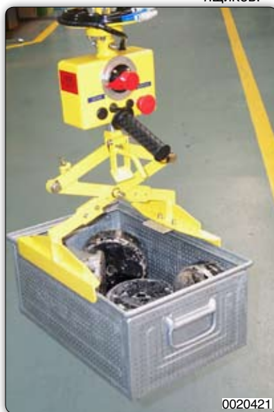
Манипулятор с ножничным приспособлением для захвата и перемещения ящиков.
