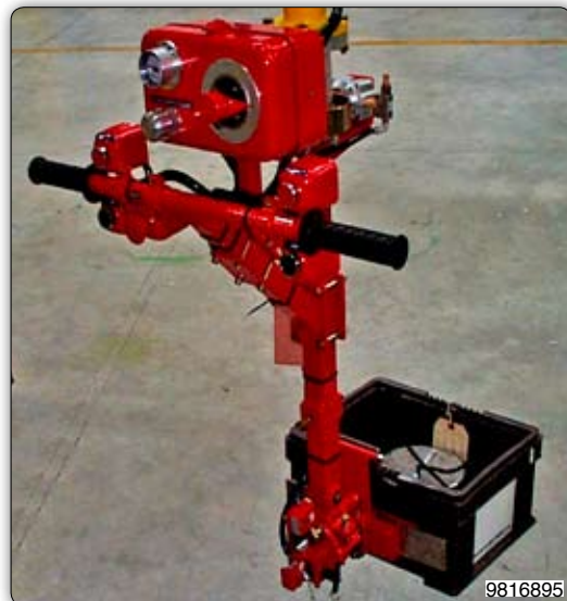
Манипулятор с вильчатым захватом для перемещения ящиков.
