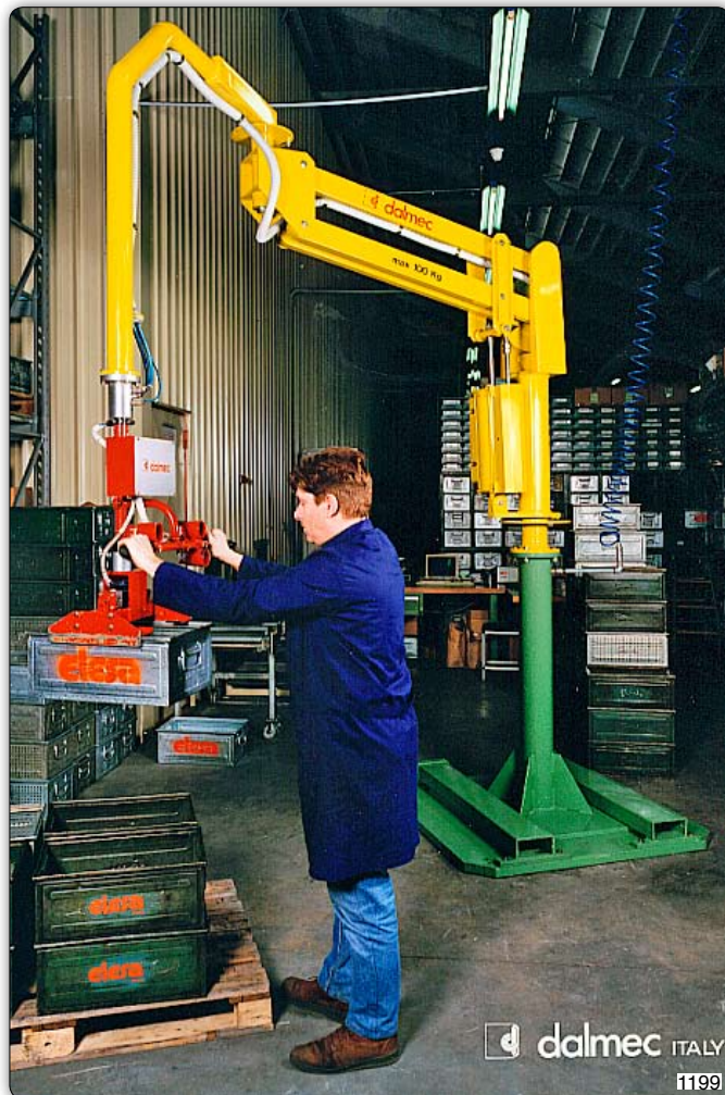
Манипулятор Partner типа PMS в исполнении на стойке и самоустойчивом основании, оборудован зажимным приспособлением для захвата и предназначенный для перемещения ящиков.
