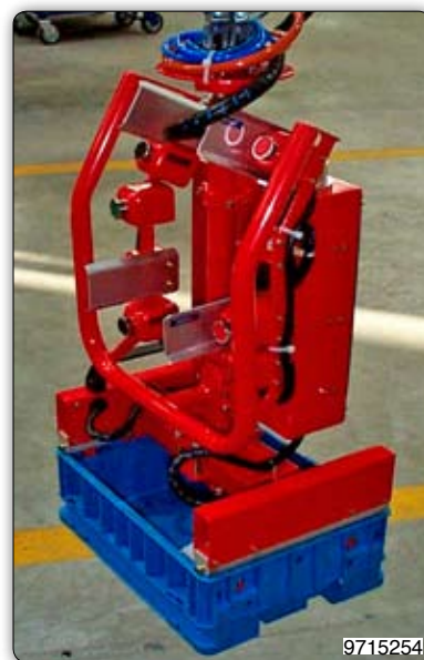
Манипулятор с зажимным приспособлением для захвата ящиков за верхние кромки боковин.
