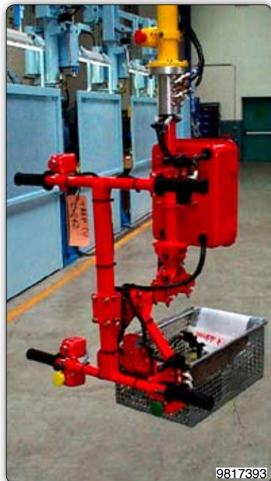
Манипулятор с вильчатым захватом для перемещения металлических ящиков.
