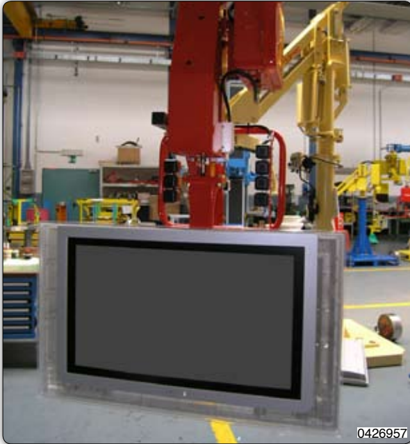
Манипулятор с приспособлением с присосами для захвата и перемещения телевизоров с ж/к экранами.
