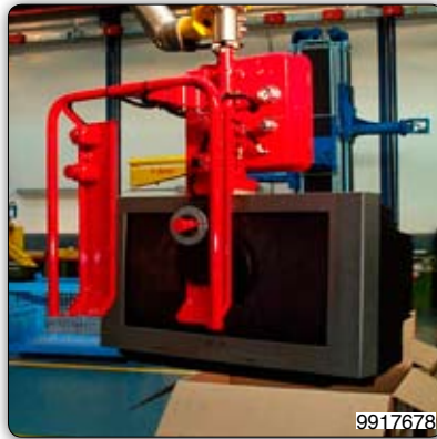
Манипулятор с приспособлением с присосами для захвата и перемещения телевизоров.
