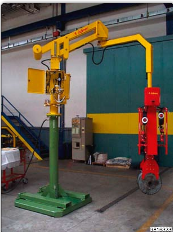
Манипулятор Partner типа PMS в исполнении на стойке, оборудованный пневматическим зажимным приспособлением для захвата за фланцы катушек с металлической проволокой и с пневмоприводом для наклона катушки на 90°.
