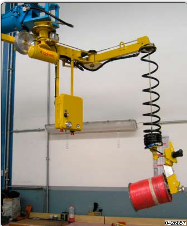
Манипулятор Speedyfil типа SPF в подвесном исполнении, оборудованный специальным приспособлением для захвата с раздвижным патроном, вставляемым в центральное отверстие катушки, и с ручным поворотом на 90°. Приспособление для захвата позволяет выполнять захват и автоматический отпуск катушки.
