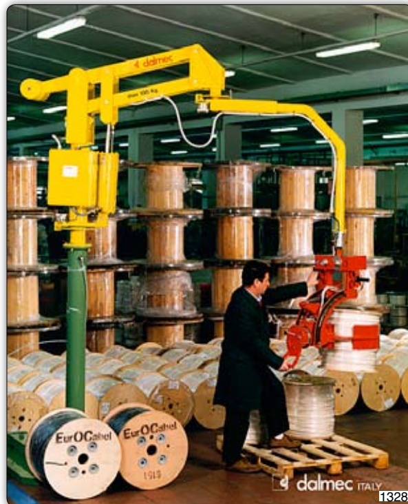
Манипулятор Partner типа PMS в исполнении на стойке, оборудованный пневматическим зажимным приспособлением для захвата катушек с металлической проволокой за боковую часть между фланцами и с пневмоприводом для наклона катушки с горизонтального положения в вертикальное.
