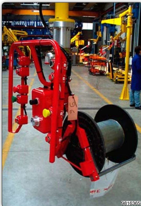
Манипулятор с двух-стержневым вильчатым захватом катушек за фланцы оборудованный устройством детекции груза.
