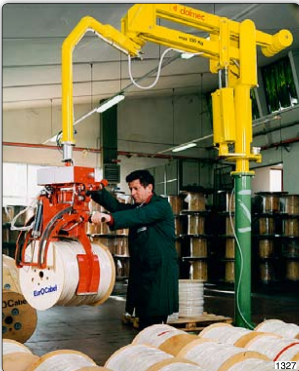
Манипулятор Partner типа PMS в исполнении на стойке, оборудованный пневматическим зажимным приспособлением для захвата катушек с металлической проволокой за боковую часть между фланцами и с пневмоприводом для наклона катушки с горизонтального положения в вертикальное.
