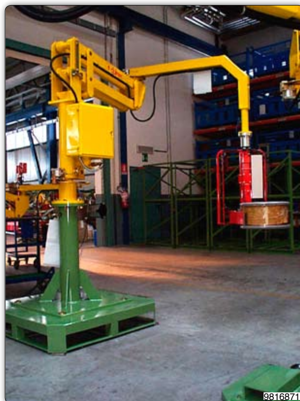
Манипулятор Partner типа PMS в исполнении на стойке, оборудованный пневматическим зажимным приспособлением для захвата катушек с металлической проволокой за боковую часть между фланцами.
