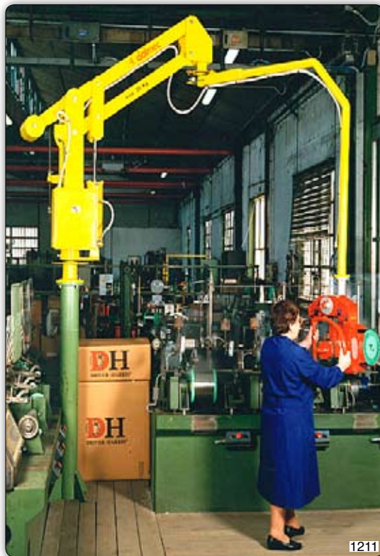
Манипулятор Partner типа PMC в исполнении на стойке, оборудованный зажимным приспособлением для захвата катушек с металлической проволокой за боковую часть между фланцами.
