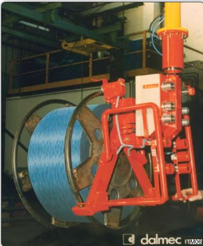
Пневматическая система для перемещения металлических катушек с захватом за фланцы. Поворот катушки с горизонтального в вертикальное положение осуществляется при помощи двух пневмоцилиндров.
