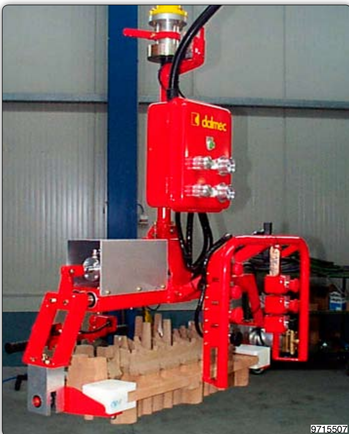
Манипулятор с зажимным приспособлением для захвата и переворота литейных стержней.
