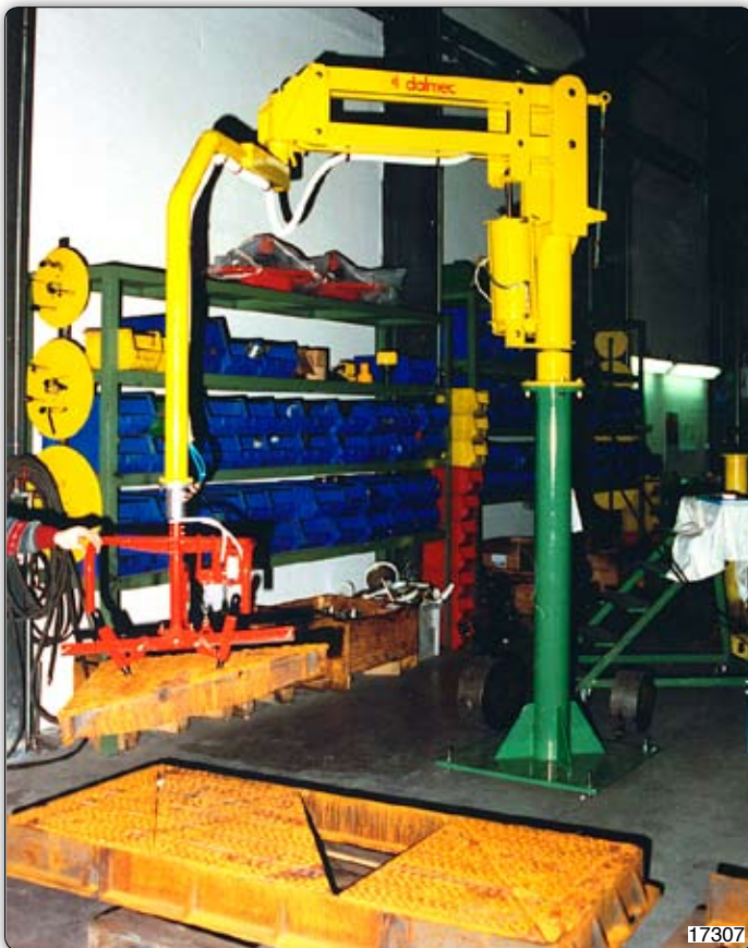
Манипулятор Partner типа PMC в исполнении на стойке с приспособлением для перемещения чугунных покрытий.
