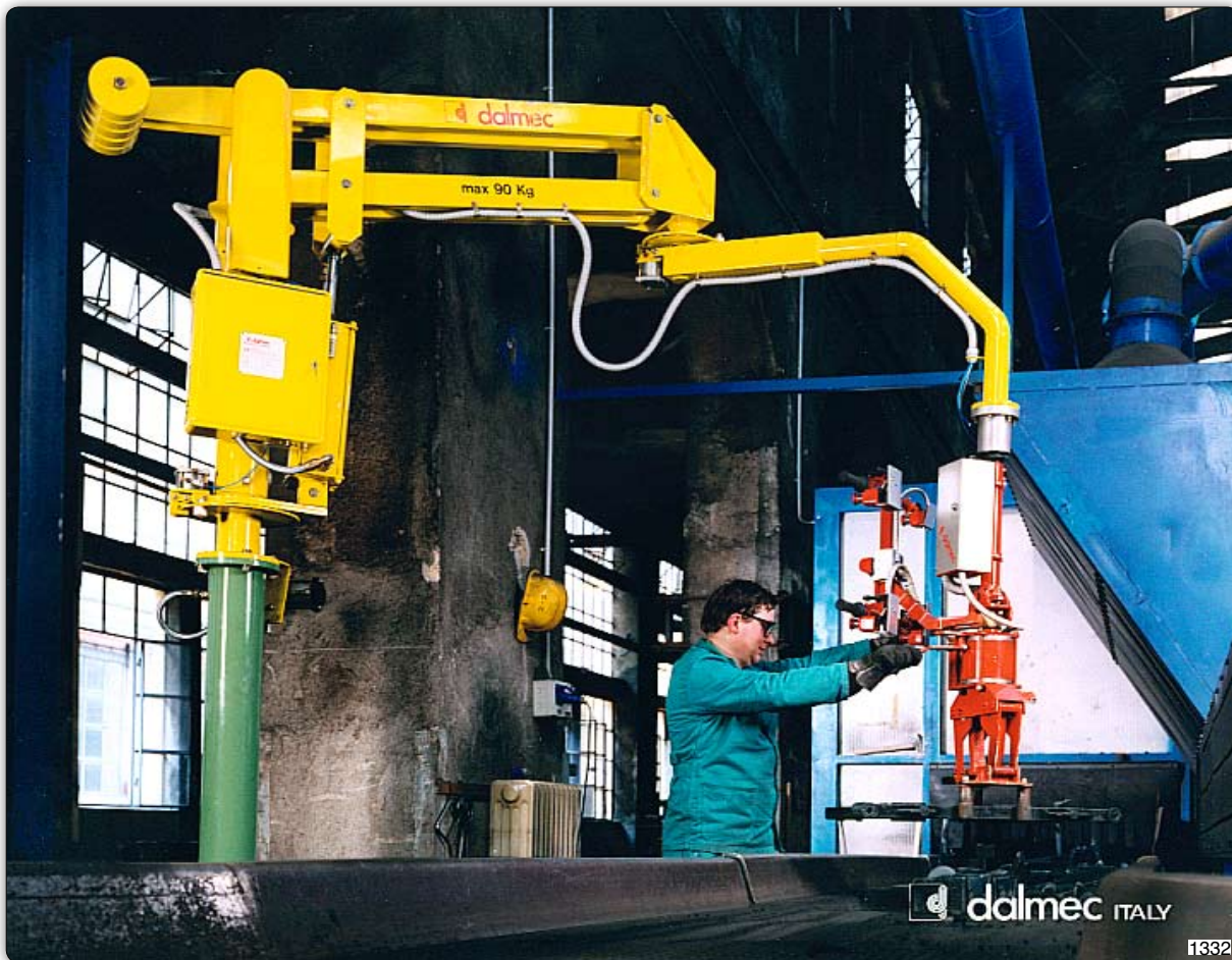
Манипулятор Partner типа PMC в исполнении на стойке с зажимным пневматическим захватом для перемещения отливок.
