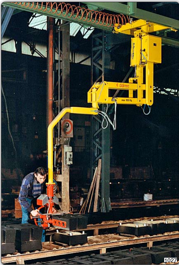
Манипулятор Partner PMS в подвесном передвижном исполнении с зажимным приспособлением для захвата литейных форм.
