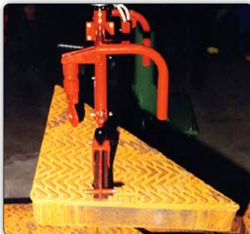
Манипулятор Partner типа PMC в исполнении на стойке с приспособлением для перемещения чугунных покрытий.
