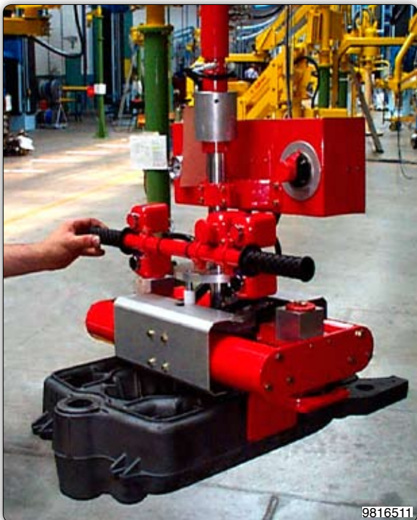
Манипулятор с пневматическим зажимным захватом для перемещения элементов котла.
