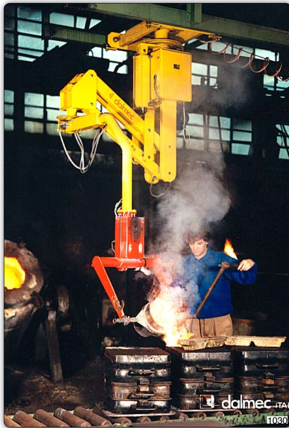
Манипулятор Partner PMS в подвесном передвижном исполнении с вильчатым захватом для ковшиков или тигелей.
