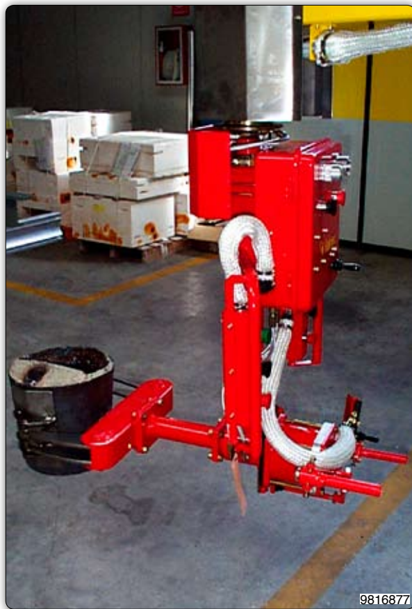
Манипулятор с пневматическим приспособлением для захвата ковшиков с ручным устройством поворота для слива металла.
