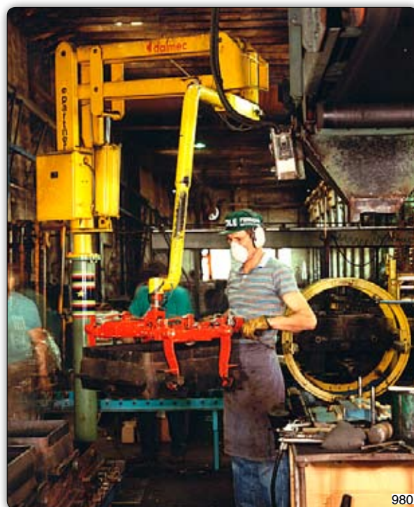
Манипулятор Partner типа PMC в исполнении на стойке с зажимным пневматическим захватом для перемещения стержневых ящиков.
