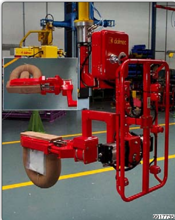
Манипулятор с приспособлением с пневматическим зажимным захватом для переворачивания литейных форм.
