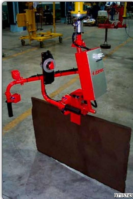
Manipolatore con attrezzo a ganasce per la movimentazione di piastre in refrattario.
