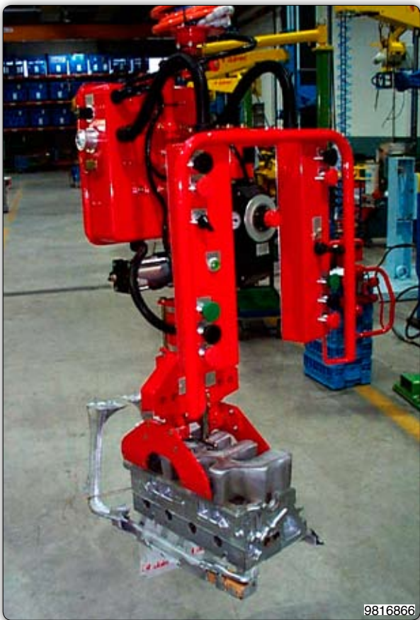
Манипулятор с пневматическим зажимным приспособлением для захвата и поворота алюминиевых головок двигателей.
