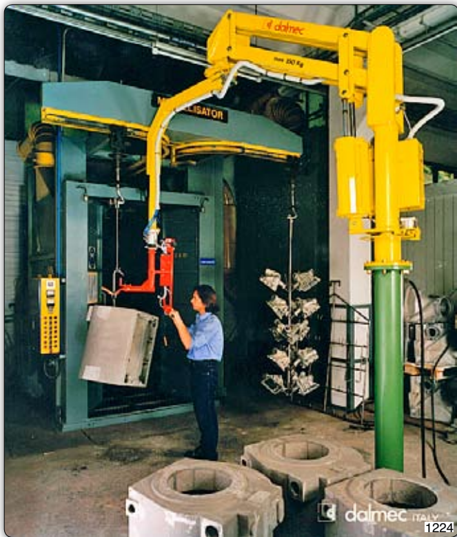
Manipolatore Partner tipo PMC, esecuzione a colonna, con gancio speciale per la movimentazione di fusioni.
