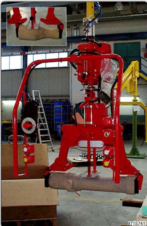
Манипулятор с зажимным захватом для перемещения литейных стержней разного размера.
