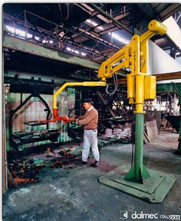
Манипулятор Partner типа PMC в исполнении на стойке с зажимным пневматическим захватом для перемещения штампов.
