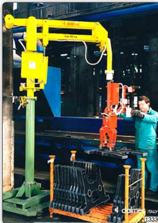
Manipolatore Partner tipo PMC in esecuzione su stivatore e base autoportante con dispositivo a presa pneumatica per lo spostamento di fusioni.
