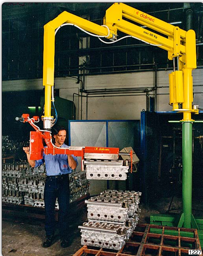
Manipolatore Partner PMC in esecuzione su stivatore con dispositivo a serraggio per lo spostamento di testate in alluminio.
