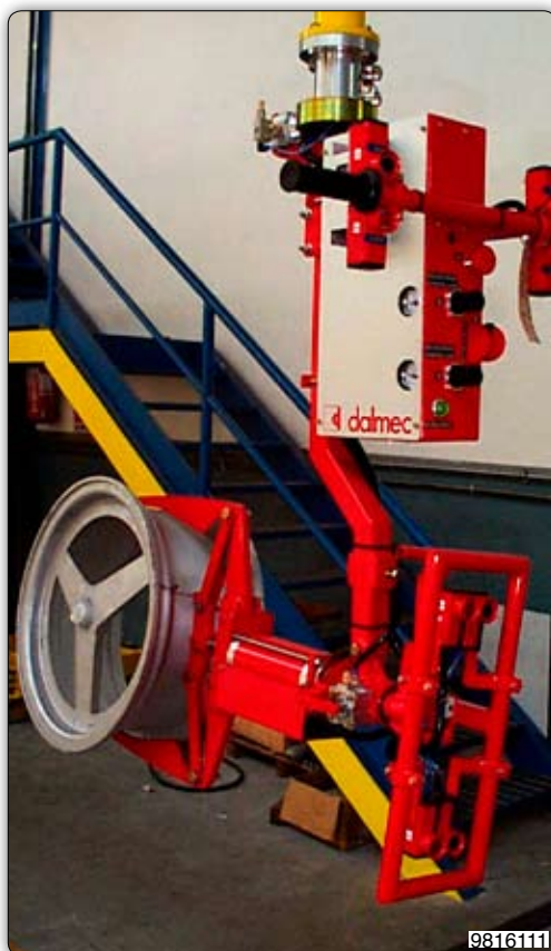
Манипулятор с приспособлением для захвата и ручного поворота литых колесных дисков.
