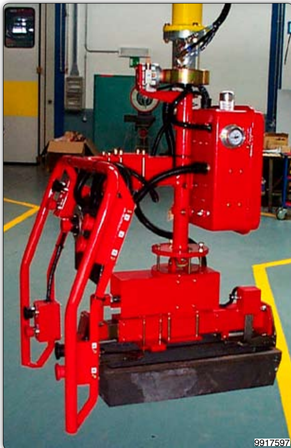
Манипулятор с зажимным захватом для перемещения литейных форм.
